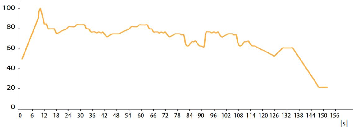
Slika 14. Otvorenost analognog elektroničkog ekspanzijskog ventila; [19]
