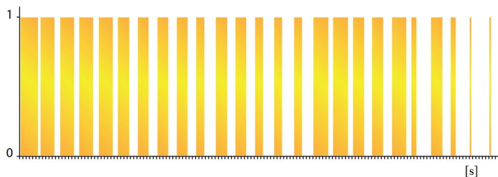
**Slika 13. Otvorenost pulsno modulirajućeg elektroničkog ekspanzijskog ventila; [19]**
