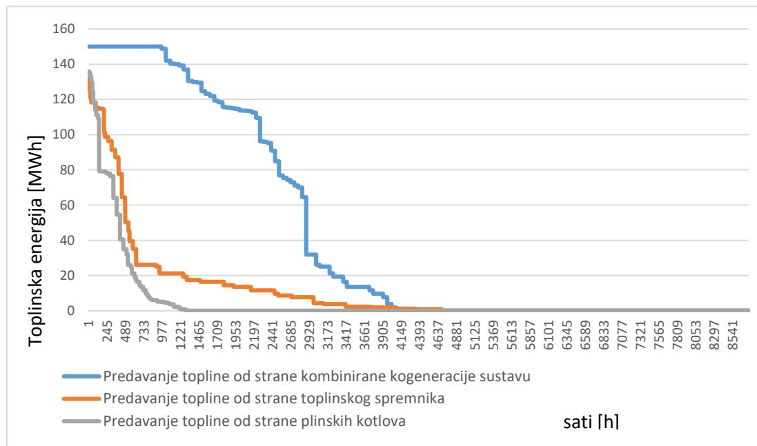
**Slika 32. Vrijeme trajanja isporuke toplinske energije dobiveno korištenjem karakterističnih dana toplane s plinskim kotlovima**
