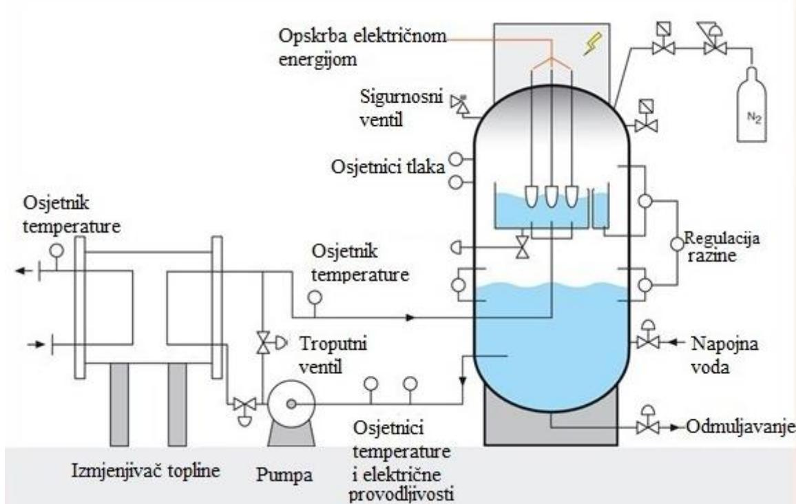
Slika 16. Toplovodni električni kotao s elektrodama; [32]
