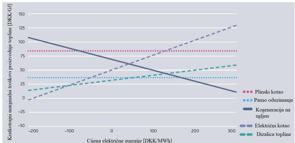
Slika 3. Kratkotrajni marginalni troškovi proizvodnje topline raznih tehnologija; [1]
