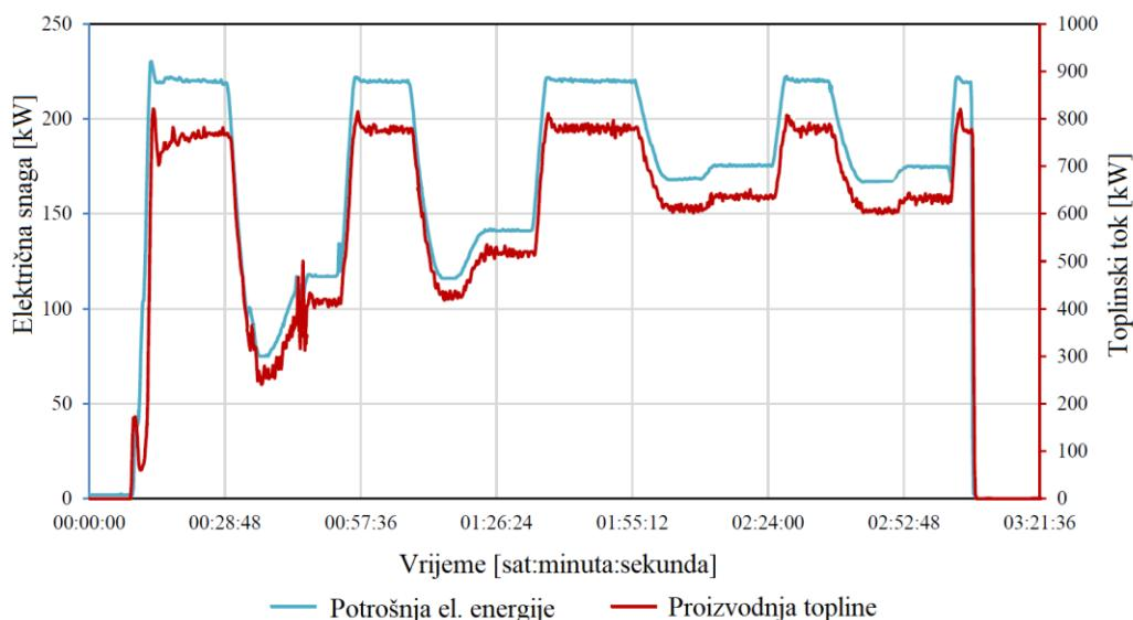
Slika 27. Podaci dobiveni ispitivanjem realne dizalice topline; [29]
