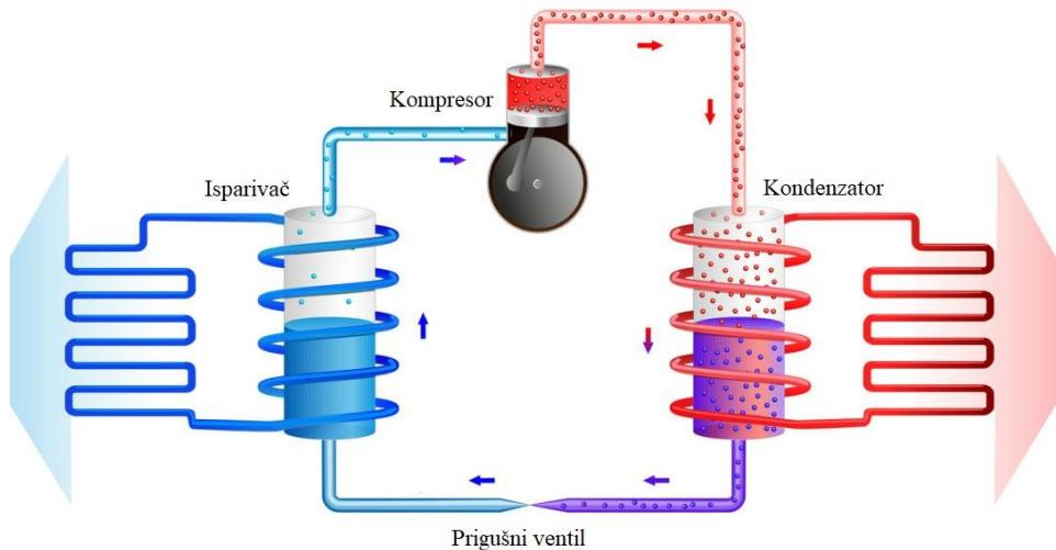
**Slika 11. Shematski prikaz realnog ljevokretnog procesa; [17]**
