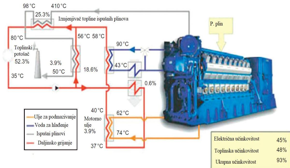
Slika 8. Shematski prikaz kogeneracijskog postrojenje s plinskim motorom; [14]
