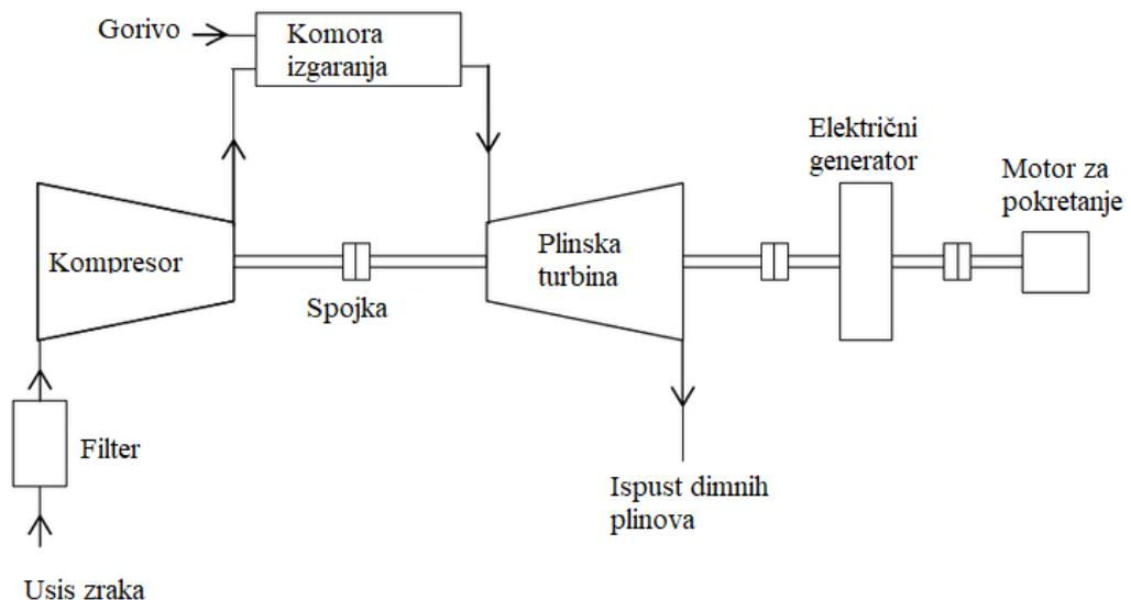
**Slika 9. Shematski prikaz jednostavnog postrojenja s plinskom turbinom; [15]**
