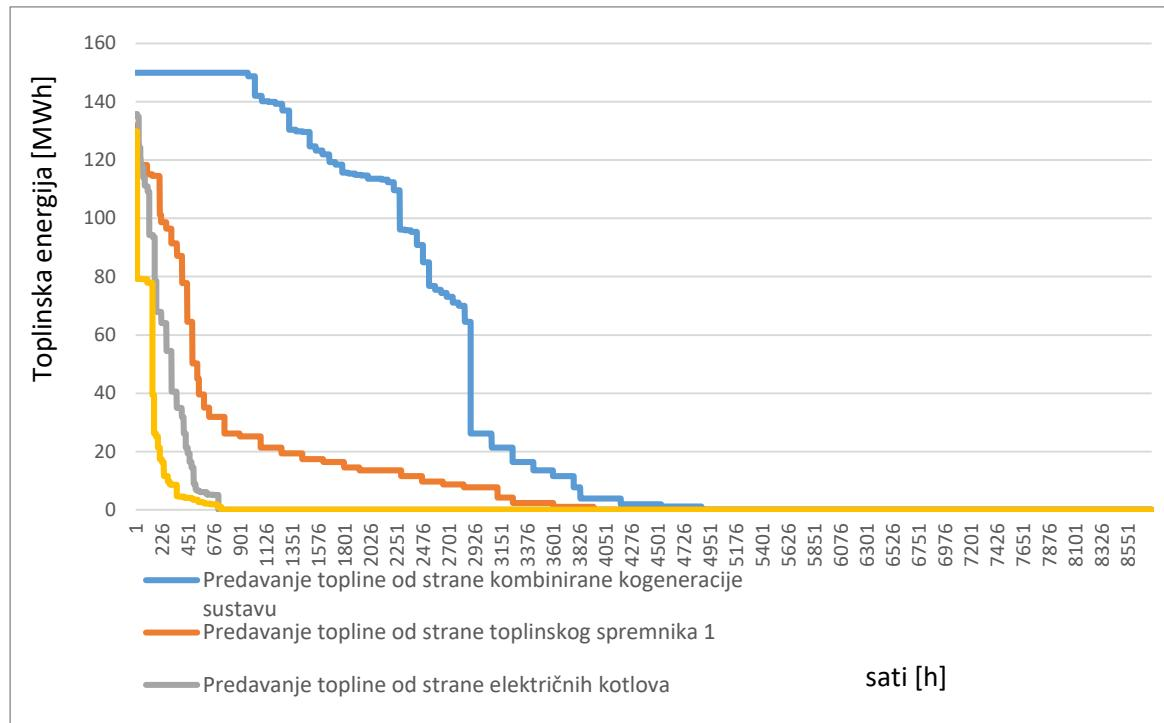
Slika 39. Vrijeme trajanja isporuke toplinske energije dobiveno korištenjem karakterističnih dana toplane s električnim kotlovima
