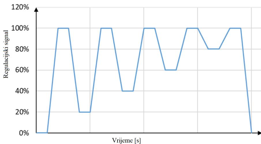
Slika 26. Regulacijski signal prilikom ispitivanja realne dizalice topline; [29]
