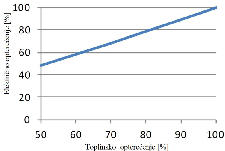
Slika 22. Ovisnost toplinskog opterećenja o električnom plinskih motora; [27]
