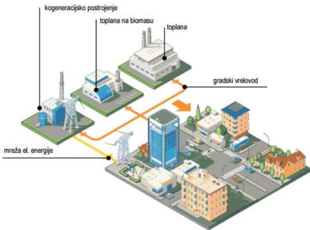
**Slika 4. Shematski prikaz centraliziranog toplinskog sustava; [3]**
