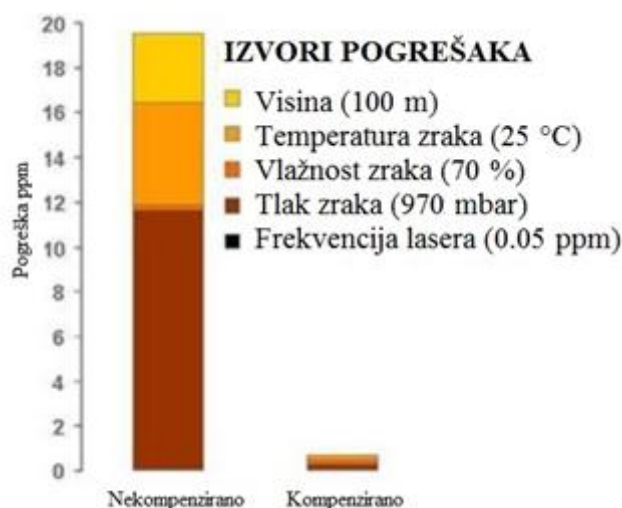
Slika 37. Izvor pogrešaka u nekompenziranom i kompenziranom interferencijskom sustavu [14]
