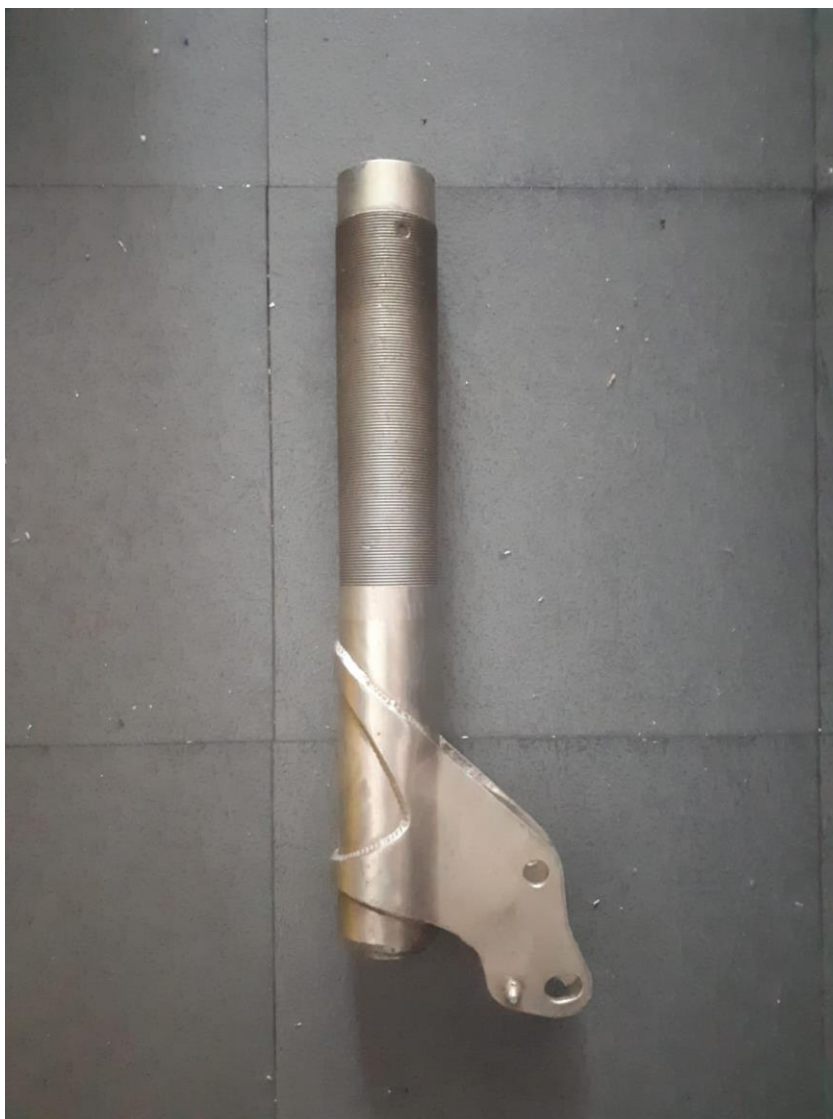
Slika 26. Vanjska cijev sa navojem i uhom opružne noge
