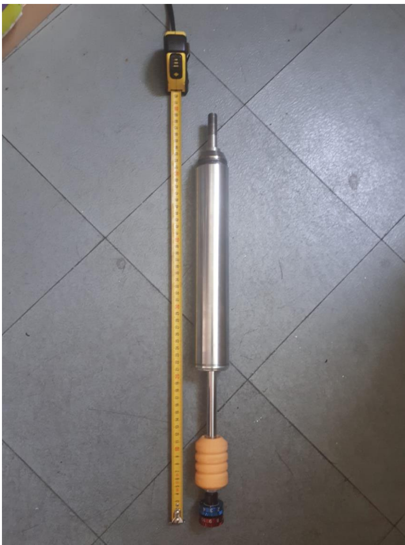
Slika 25. Amortizer opružne noge
