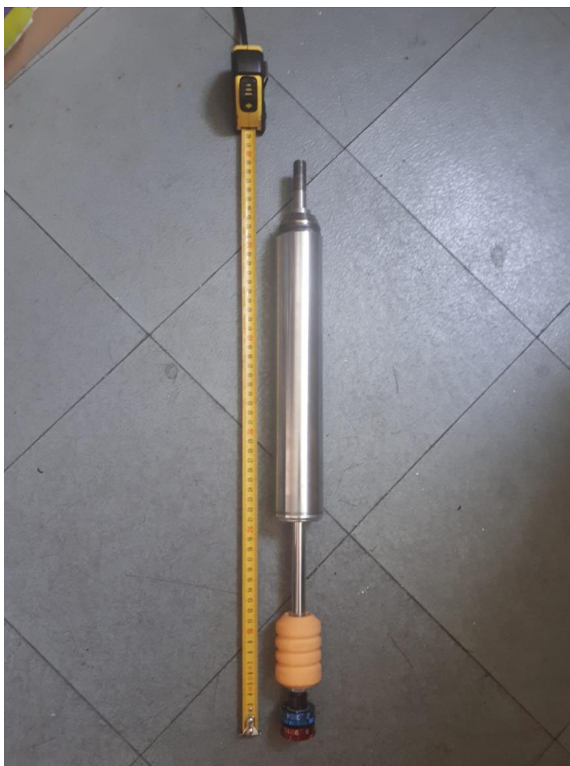
Slika 25. Amortizer opružne noge
