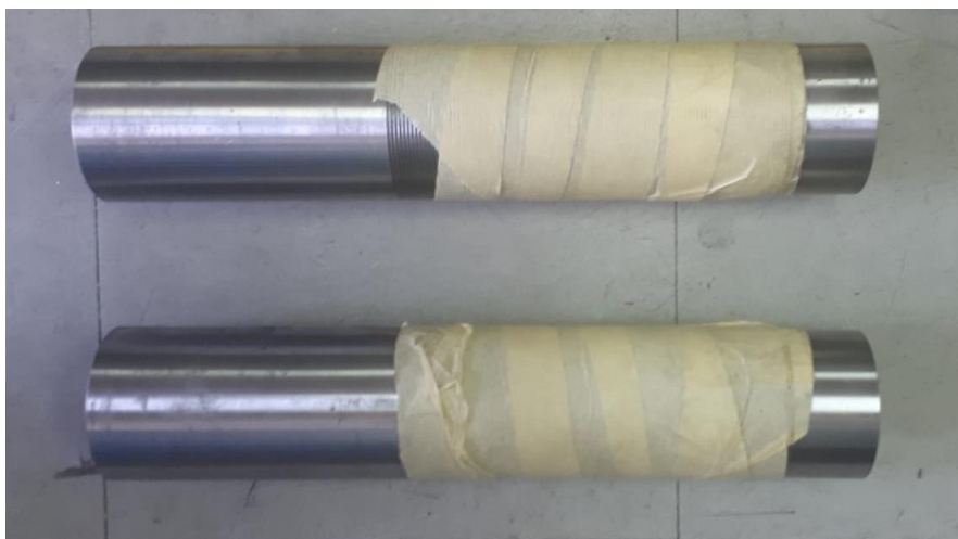
Slika 112. Cijev noge amortizera sa narezanim navojem
