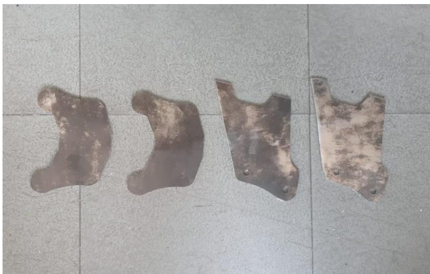
Slika 61. Limovi prikladni za diskretizaciju ljuskastim elementima
