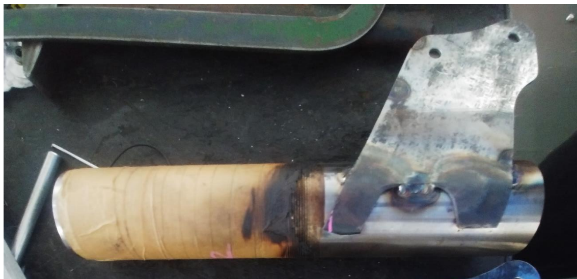
Slika 114. Noga amortizera nakon prvog dijela navarivanja
