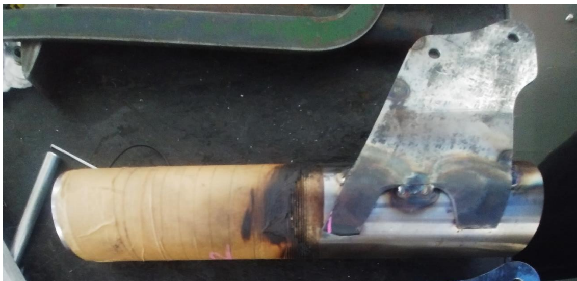
Slika 114. Noga amortizera nakon prvog dijela navarivanja
