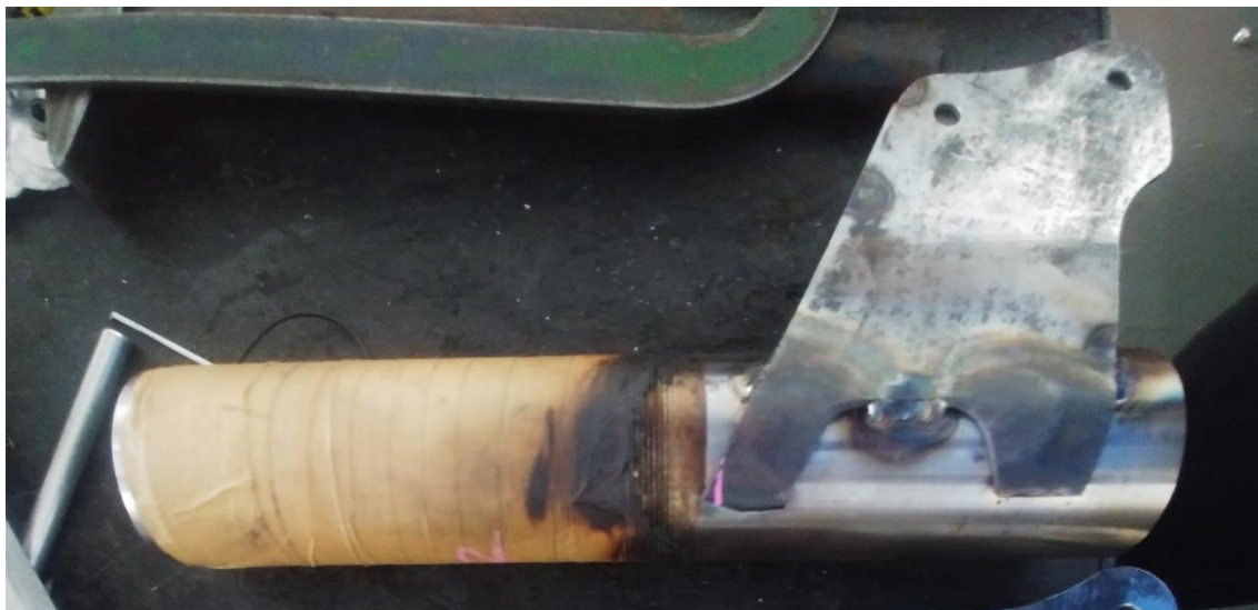
Slika 114. Noga amortizera nakon prvog dijela navarivanja
