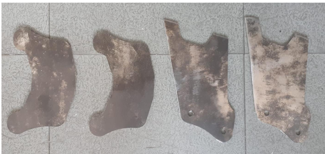
Slika 113. Limovi prihвата noge amortizera
