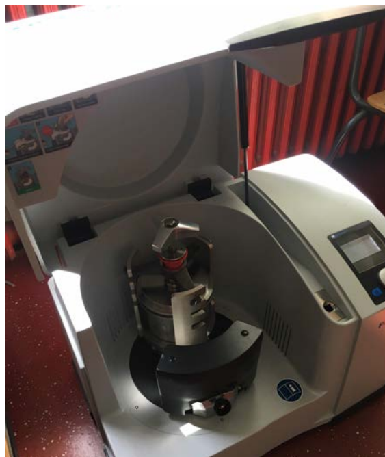
Slika 34. Postavljanje posude sa suspenzijom u planetarni kuglični mlin Retsch PM 100
