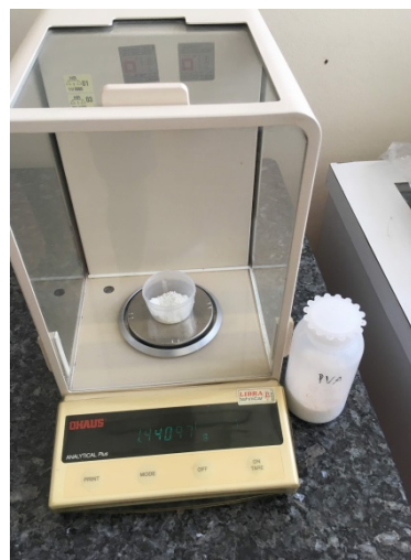
Slika 31. Vaganje PVA veziva na analitičkoj vagi Ohaus Analytical plus
