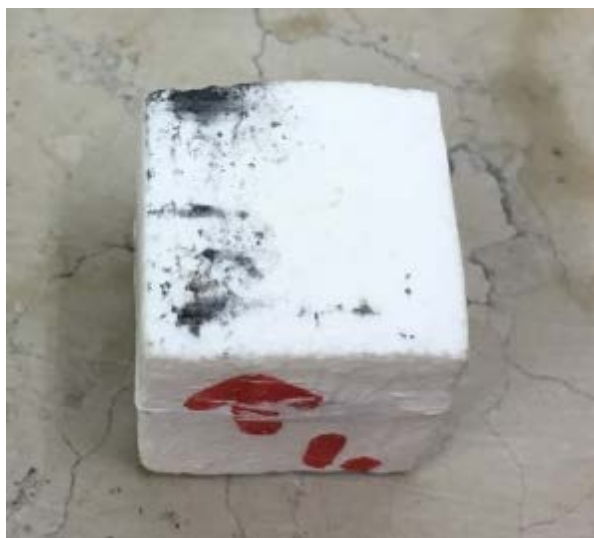
Slika 51. Izgled kontakte površine uzorka monolitne \text{Al}_2\text{O}_3 keramike
