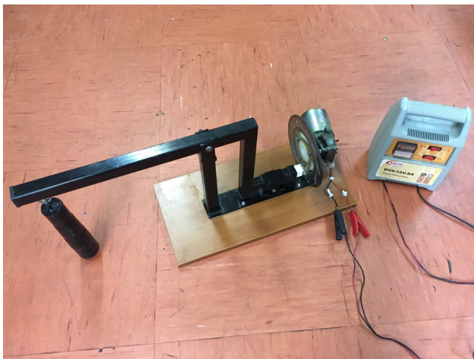
Slika 45. Uređaj za nestandardizirano ispitivanje kliznog trošenja kočne pločice u radu s diskom
