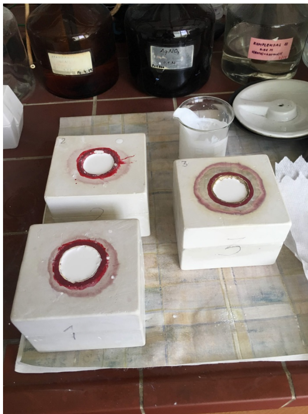
Slika 38. Zatvoreni gipseni kalupi sa ulivenom suspenzijom
