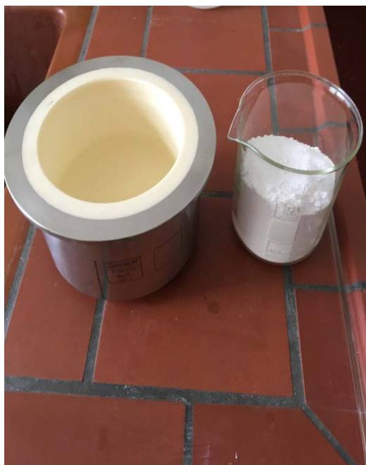
Slika 33. Prebacivanje konstituenata u posudu planetarnog kugličnog mlina
