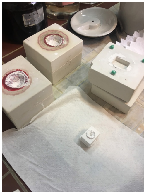
Slika 39. Vađenje sirovca iz kalupa
