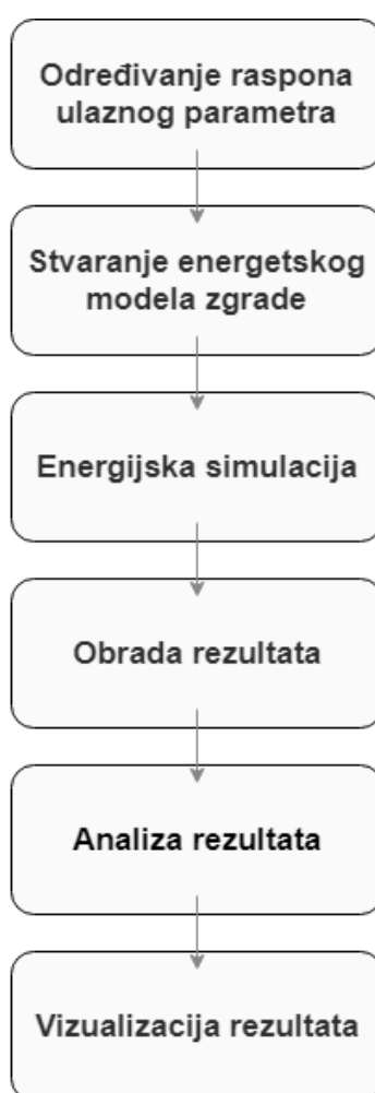
Slika 13 Dijagram toka strukturiranog procesa analize osjetljivosti [9]
