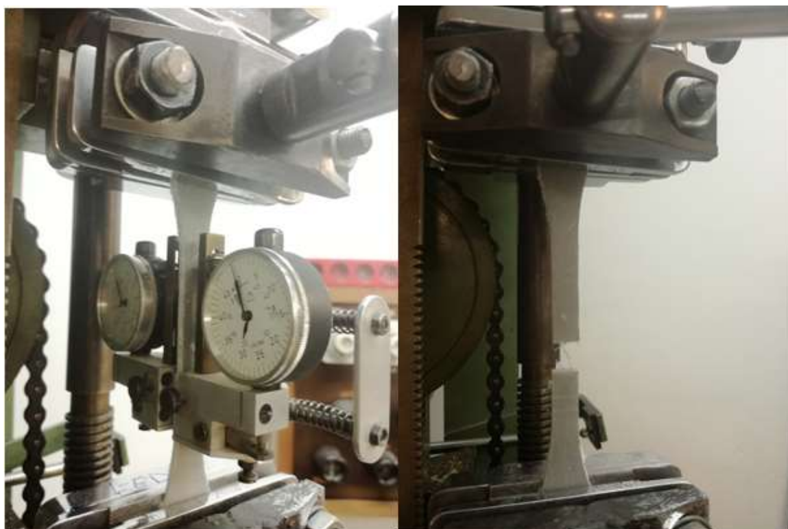
Slika 5.12. Statičko vlačno ispitivanje na kidalici
