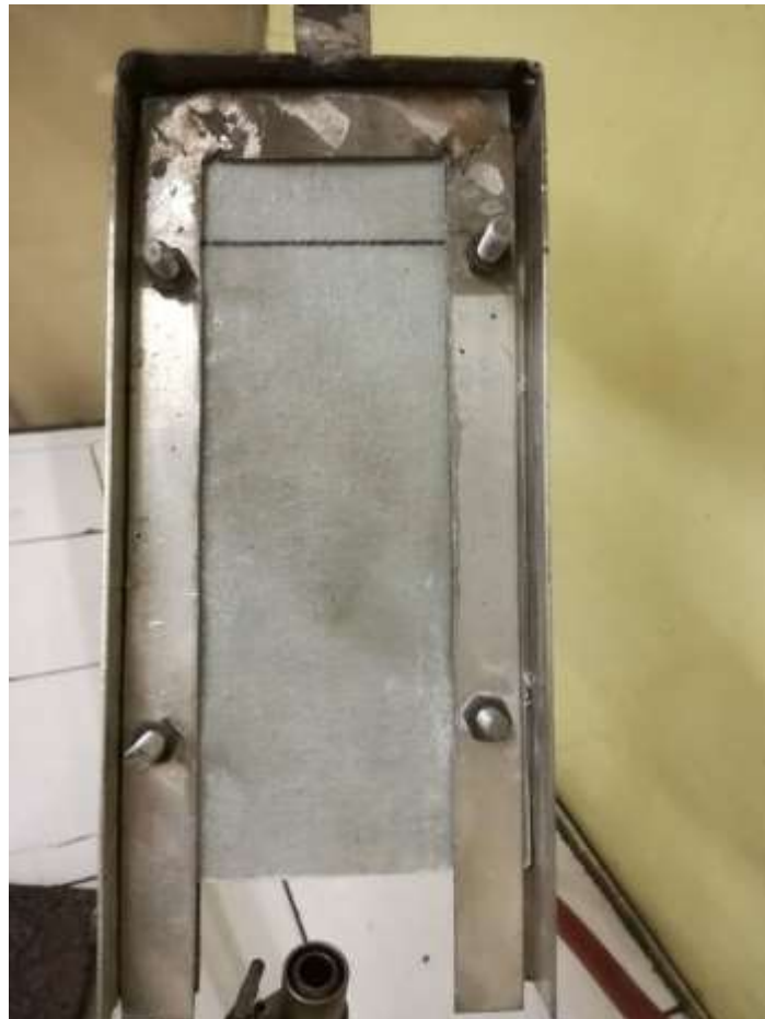
Slika 5.38. Epruveta prije ispitivanja samogasivosti
