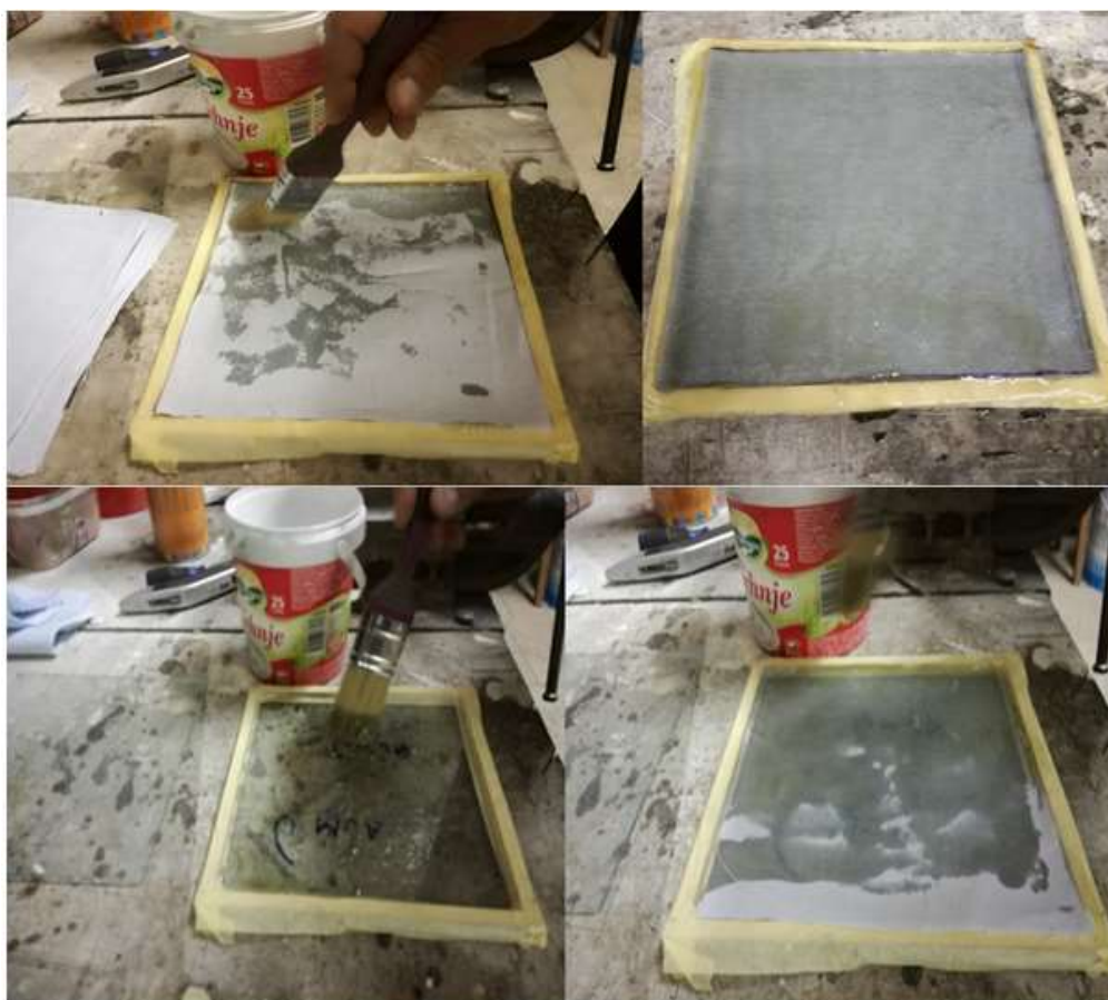
Slika 5.7. Postupak laminiranja polimernog kompozita
