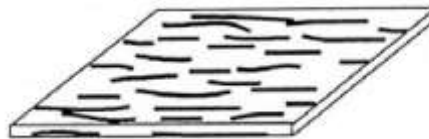
Slika 2.6. Primjer usmjerenog ojačanja kratim vlaknima [37]
