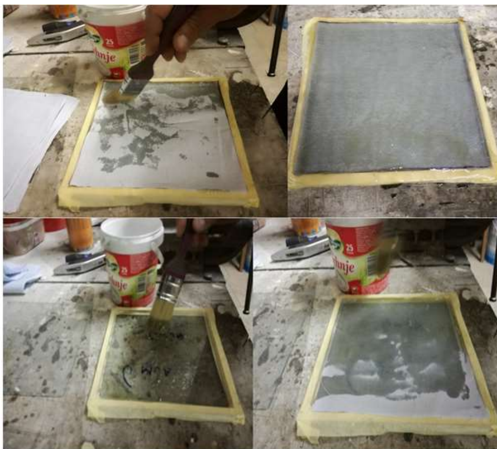
Slika 5.7. Postupak laminiranja polimernog kompozita
