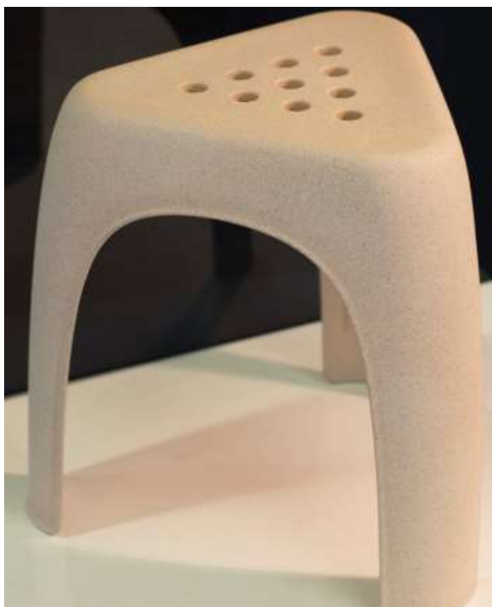
Slika 4.12. Stolica ojačana prirodnim vlaknima lana u PLA-matrici [34]
