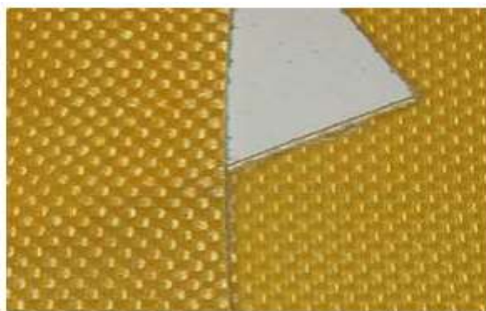
Slika 2.10. Primjer aramidnog rovinga [13]
