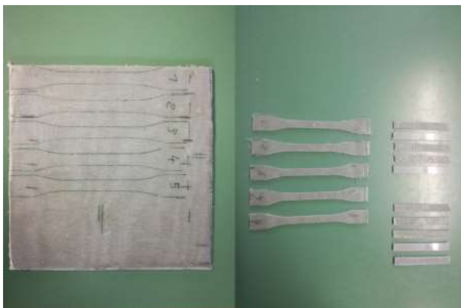
Slika 5.9. Materijal izrezan na zadane dimenzije epruveta
