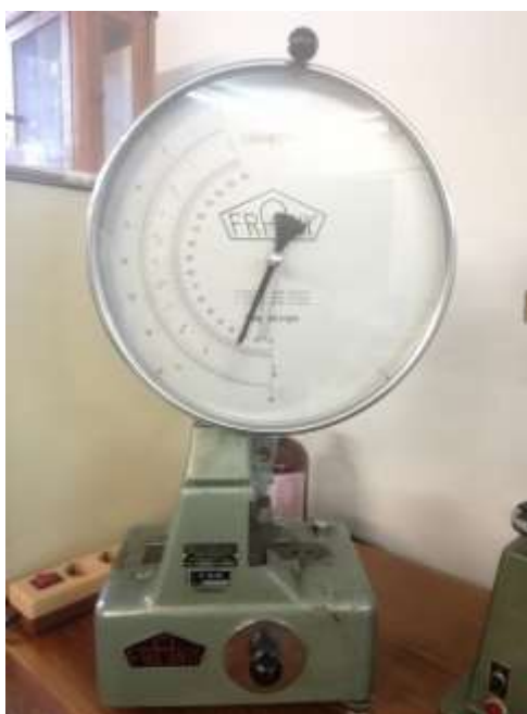
Slika 5.32. Charpyjev bat proizvođača Karl Frank
