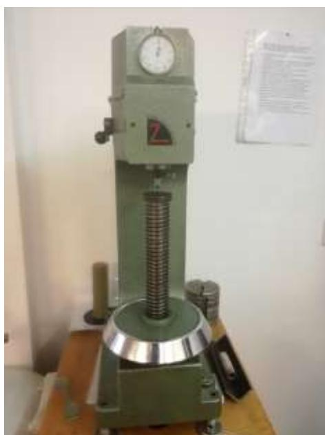
**Slika 5.34.Tvrdomjer za ispitivanje tvrdoće**
