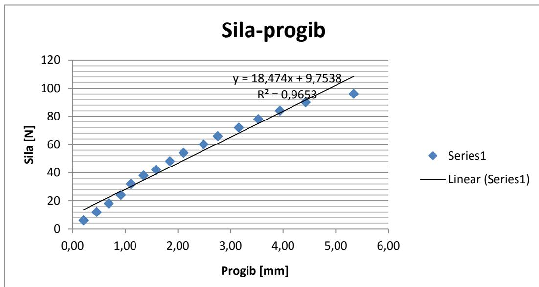
**Slika 5.25. Dijagram sila - progib za epruvetu 2**
