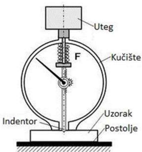
Slika 5.33. Shematski prikaz mjerjenja tvrdoće prema Shoreu [41]
