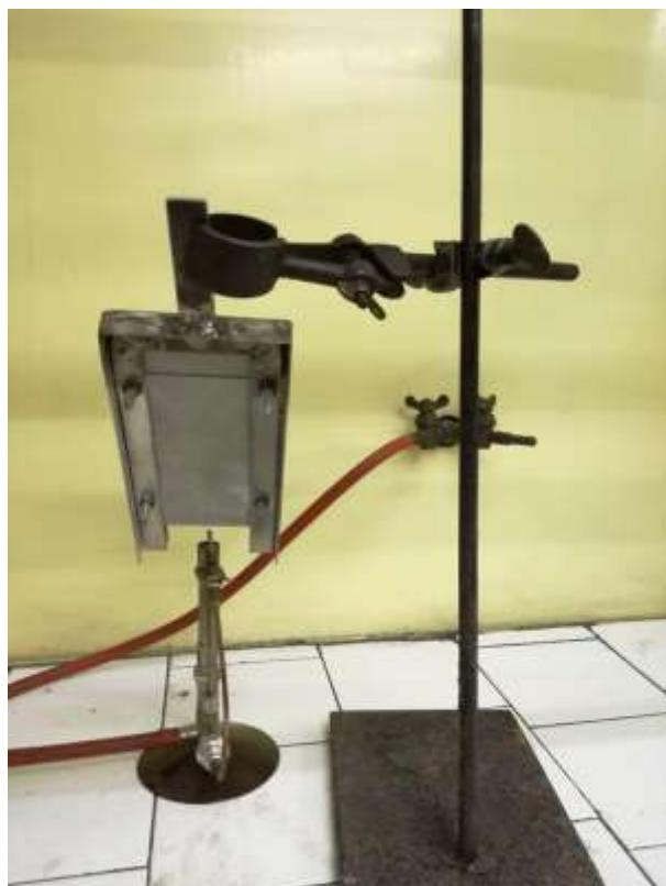
**Slika 5.37. Epruveta spremna za ispitivanje samogasivosti**
