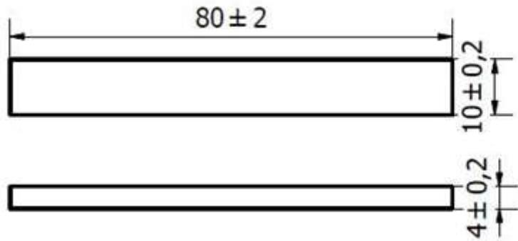
**Slika 5.31. Dimenzije epruveta za ispitivanje žilavosti [41]**
