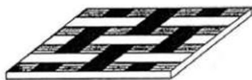
**Slika 2.5. Primjer dvosmjernog ojačanja dugim vlaknima [37]**
