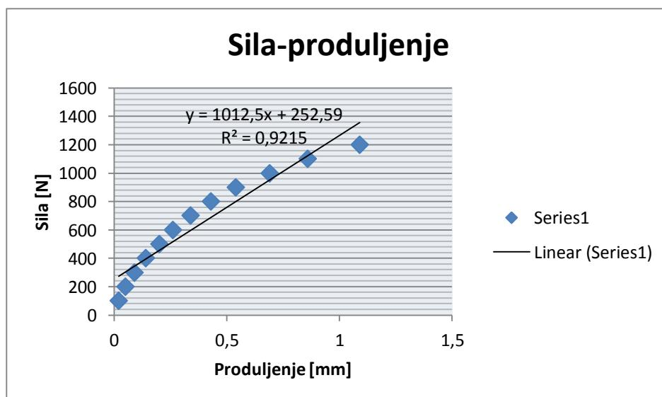
**Slika 5.14. Dijagram sila – produljenje za epruvetu 2**
