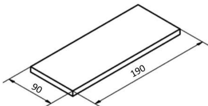
Slika 5.36. Dimenzije epruveta za ispitivanje gorivosti i samogasivosti [41]
