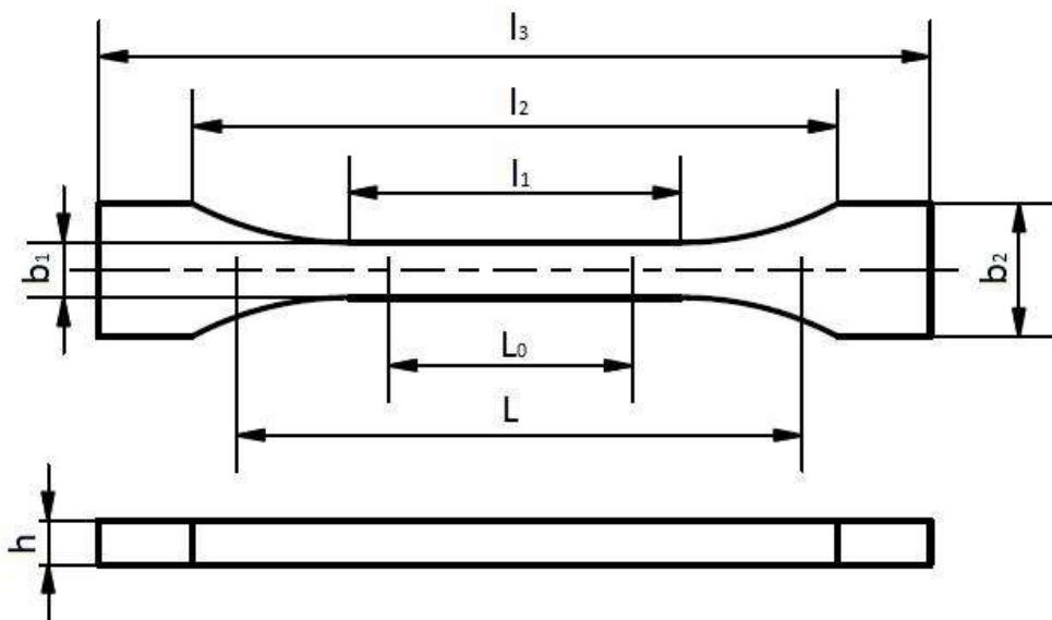
Slika 5.10. Izgled epruveta za statičko vlačno ispitivanje [41]
