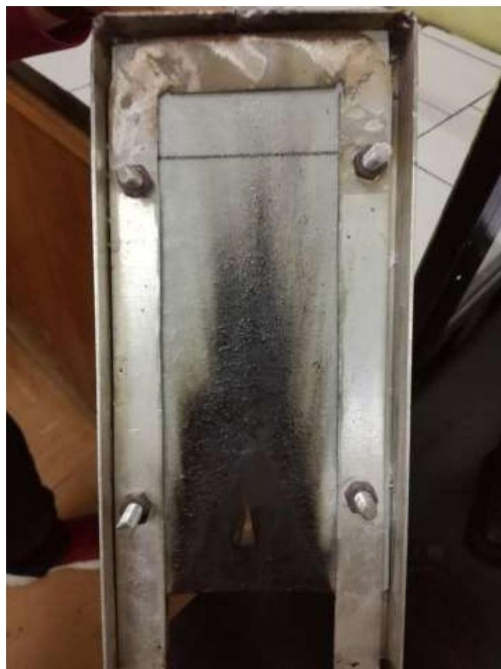
**Slika 5.39. Epruveta nakon ispitivanja samogasivosti**
