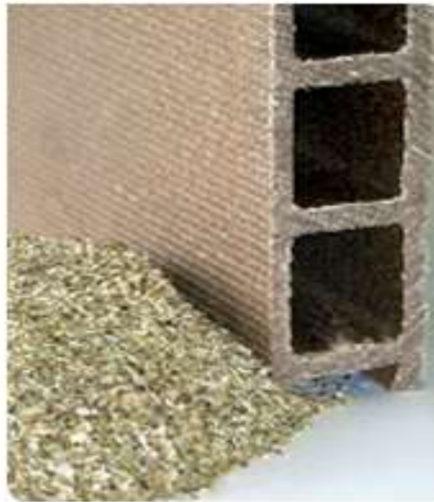
Slika 4.14. Profili u građevinskoj industriji izrađeni od kompozitnog materijala ojačanog lanenim vlaknima [35]
