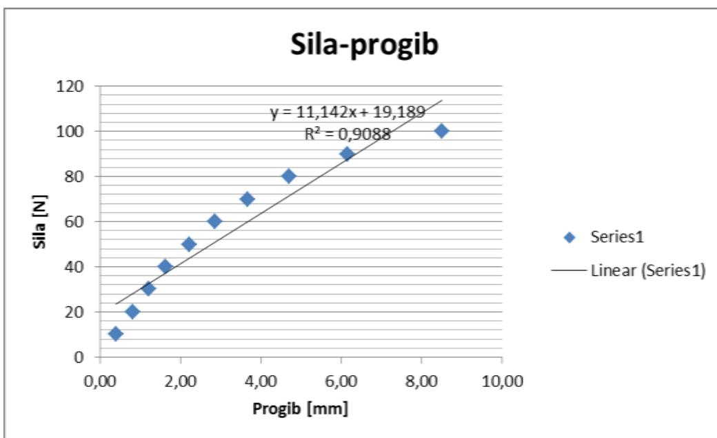
**Slika 5.24. Dijagram sila - progib za epruvetu 1**
