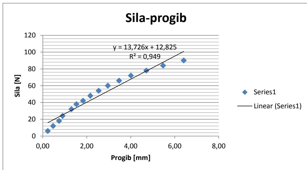
**Slika 5.27. Dijagram sila - progib za epruvetu 4**
