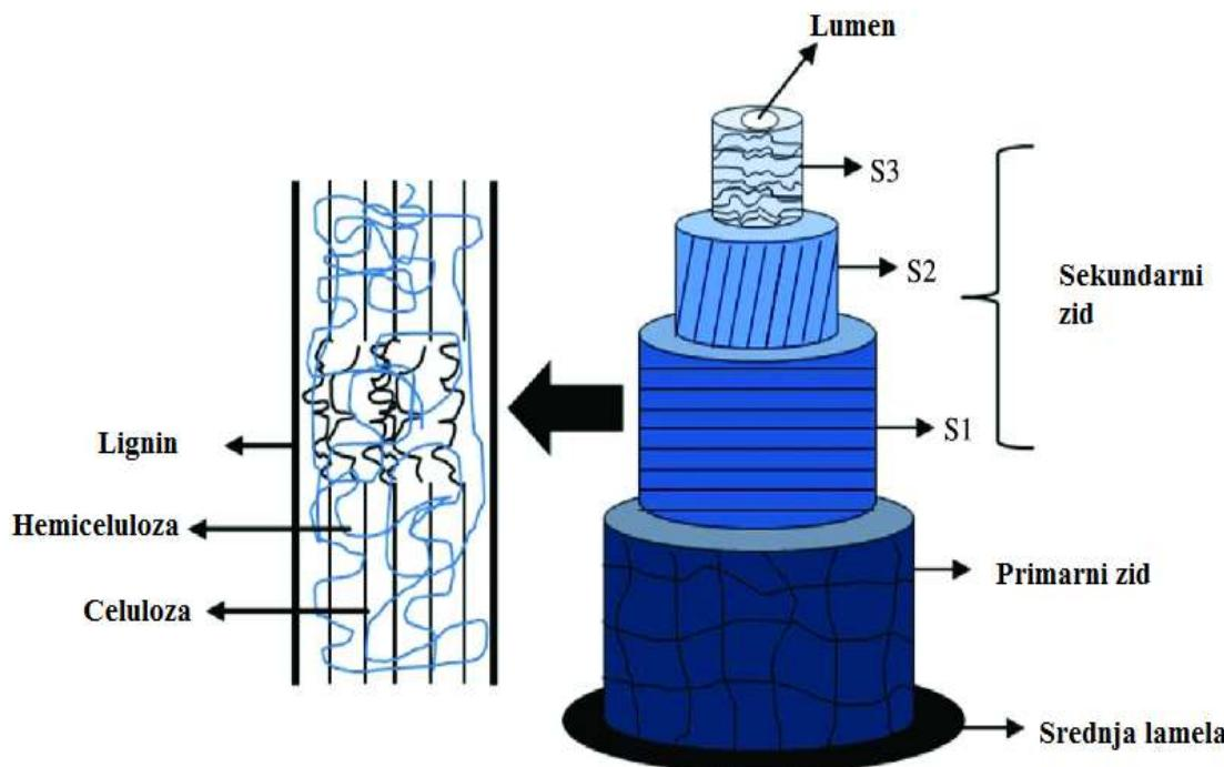
**Slika 4.2. Shematski prikaz strukture biljnog vlakna: primarni zid, srednja lamela, lumen, S1 - vanjski sekundarni zid, S2 - srednji sekundarni zid i S3 - vanjski unutarnji zid [19]**
