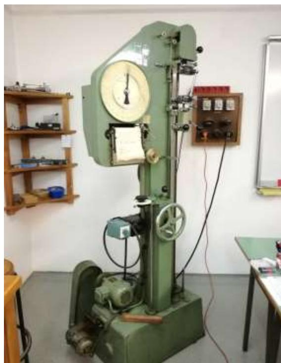
Slika 5.11. Kidalica za statično vlačno ispitivanje
