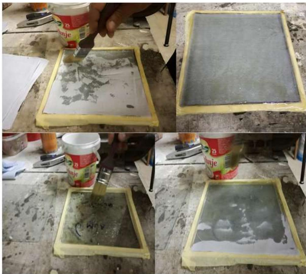
**Slika 5.7. Postupak laminiranja polimernog kompozita**
