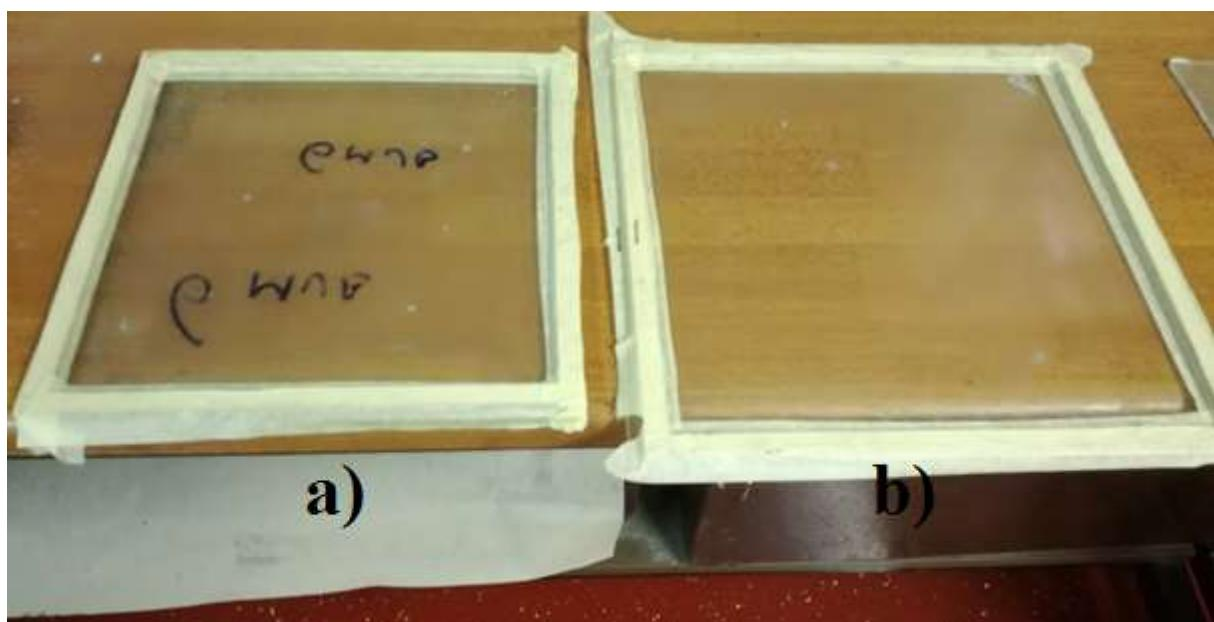
**Slika 5.5. Kalup; a) dimenzije 190x190mm b) dimenzije 220x220mm**
