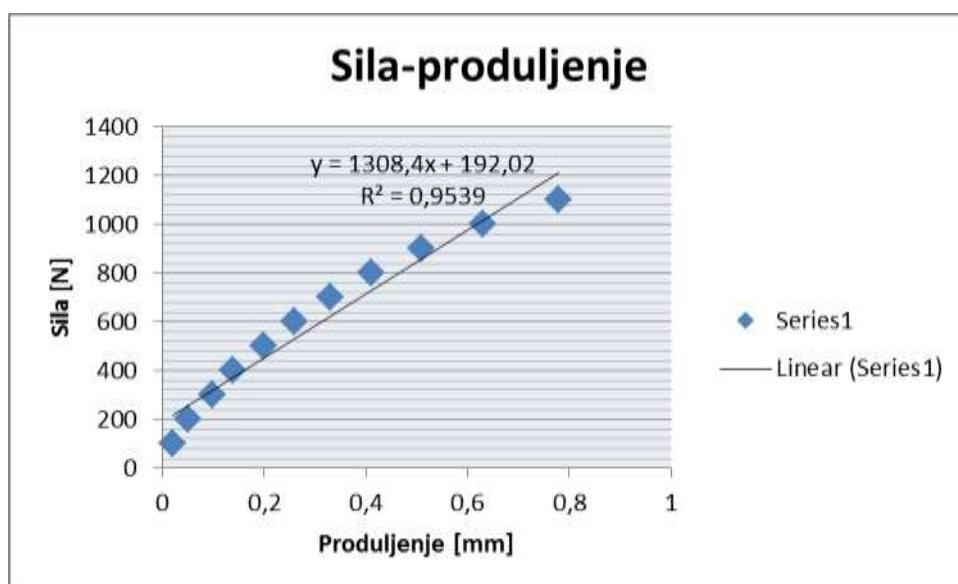
**Slika 5.13. Dijagram sila – produljenje za epruvetu 1**
