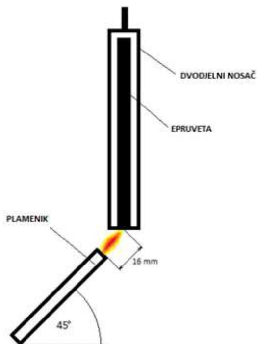
Slika 5.35. Ispitivanje gorivosti i samogasivosti [41]
