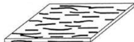
**Slika 2.6. Primjer usmjerenog ojačanja kratim vlaknima [37]**
