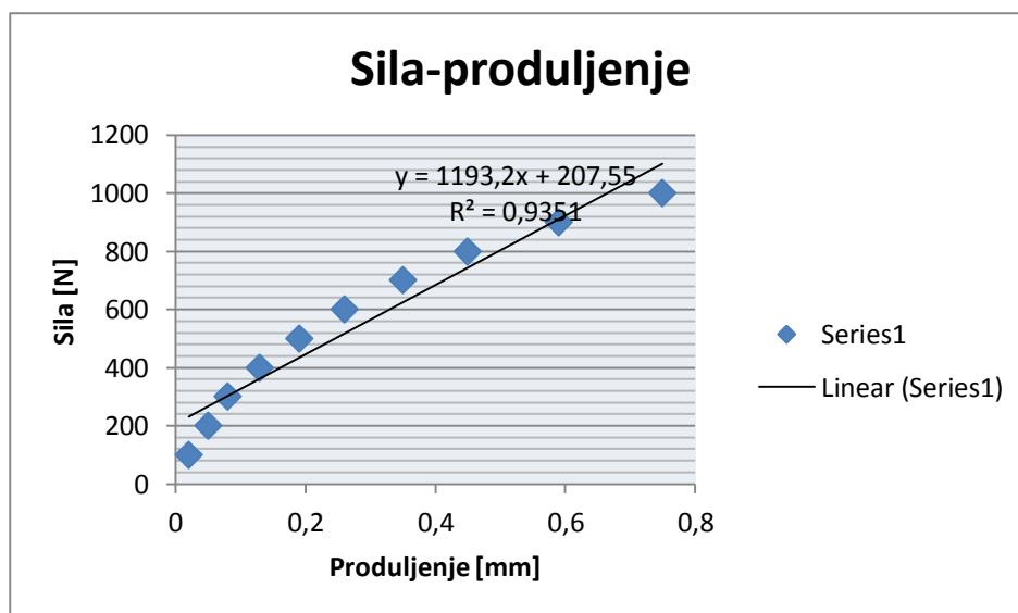
**Slika 5.17. Dijagram sila – produljenje za epruvetu 5**
