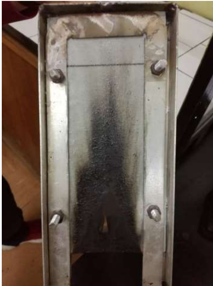
Slika 5.39. Epruveta nakon ispitivanja samoglasivosti
