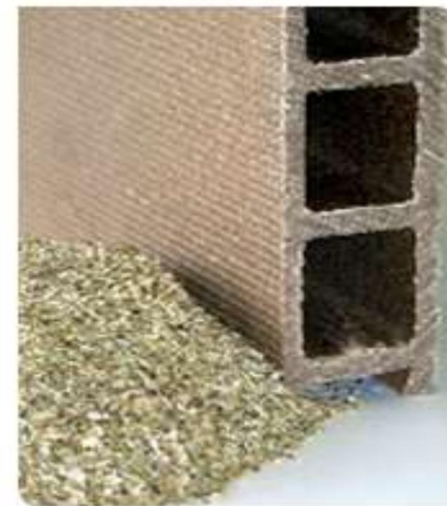
**Slika 4.14. Profili u građevinskoj industriji izrađeni od kompozitnog materijala ojačanog lanenim vlaknima [35]**
