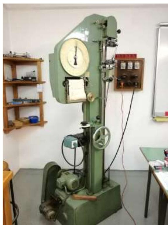
**Slika 5.22. Kidalica za savojno ispitivanje**
