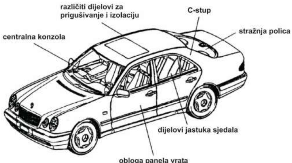
**Slika 4.10. Upotreba lanenih vlakana u proizvodnji dijelova za automobil Mercedes-Benz E-Class [32]**
