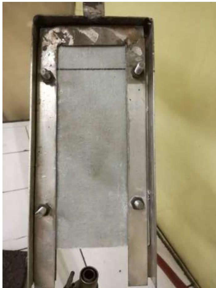
**Slika 5.38. Epruveta prije ispitivanja samogasivosti**
