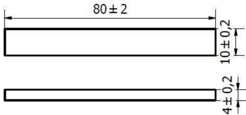
Slika 5.20. Epruveta za ispitivanje savojne čvrstoće [41]
