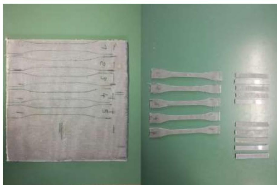
**Slika 5.9. Materijal izrezan na zadane dimenzije epruveta**
