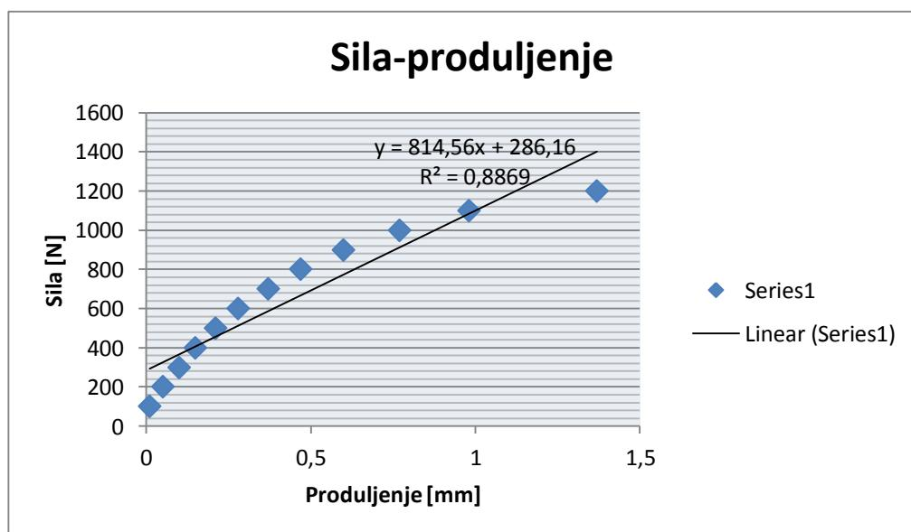
**Slika 5.15. Dijagram sila – produljenje za epruvetu 3**
