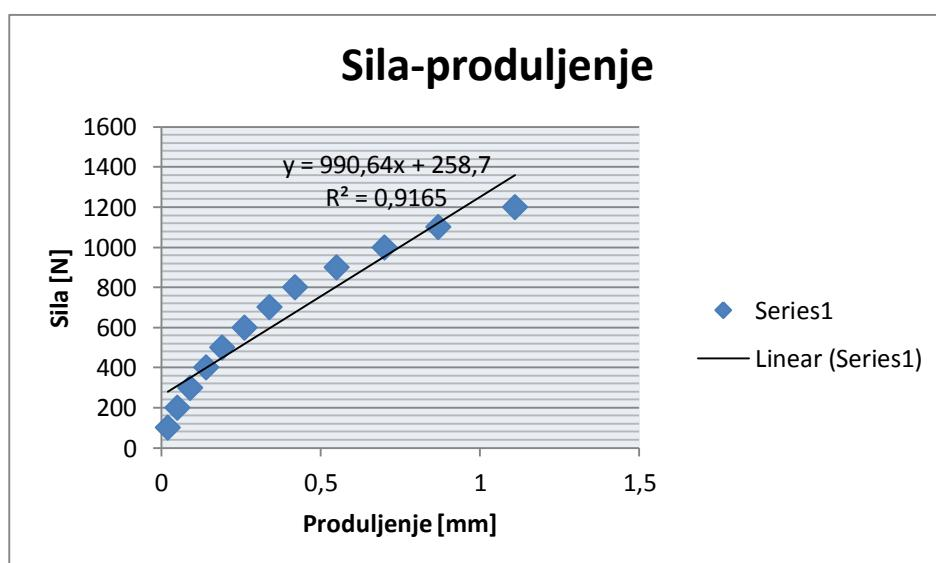
**Slika 5.16. Dijagram sila – produljenje za epruvetu 4**
