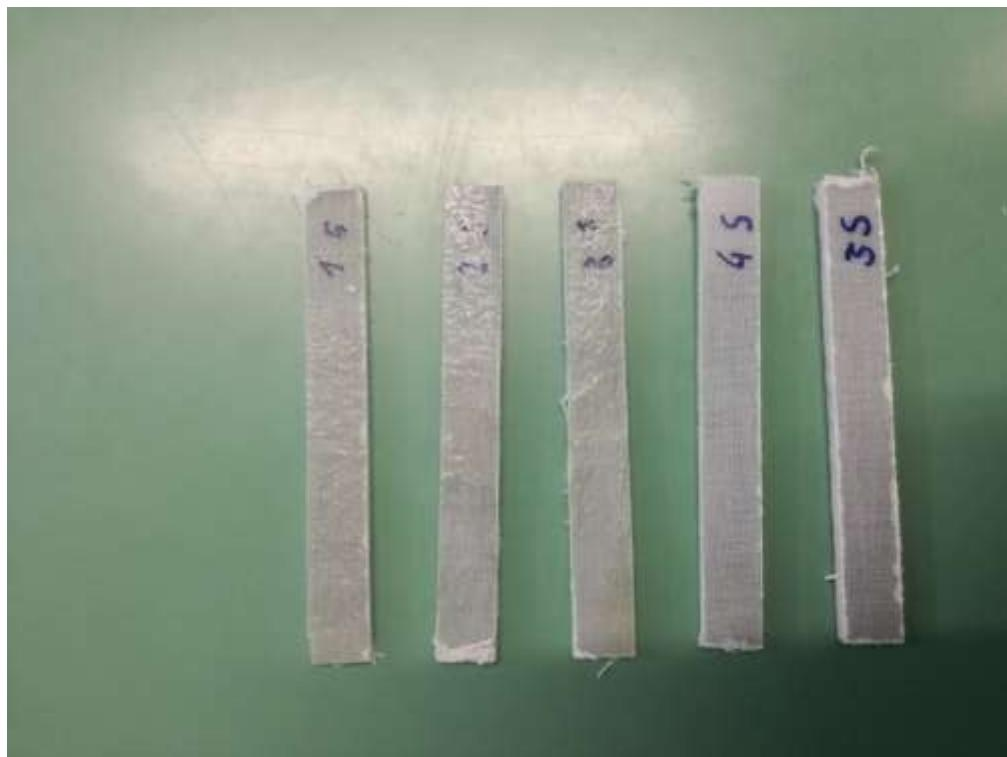
**Slika 5.21. Epruvete spremne za savojno ispitivanje**
