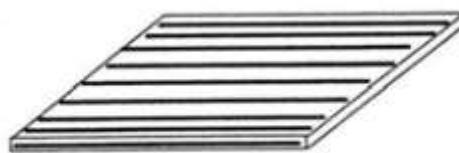
**Slika 2.4. Primjer jednosmjernog ojačanja dugim vlknima [37]**
