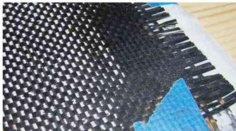
**Slika 2.9. Primjer rovinga od ugljičnih vlakana [13]**
