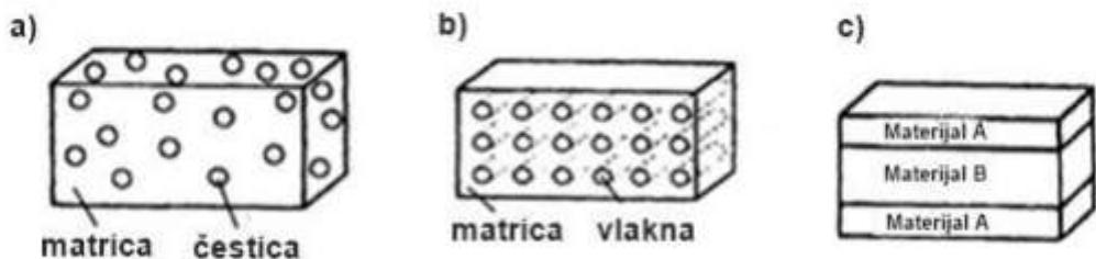
**Slika 2.3. Podjela kompozita prema obliku ojačala: a) kompozit ojačan česticama, b) kompozit ojačan vlaknima, c) strukturni kompoziti [9]**
