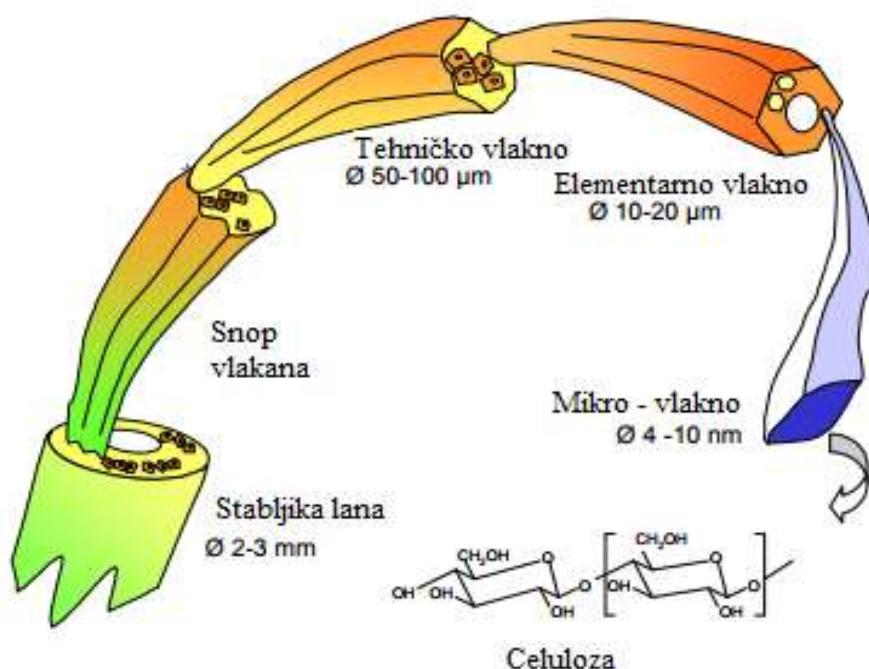
Slika 4.3. Shematski prikaz tehničkog i elementarnog lanenog vlakna [25]
