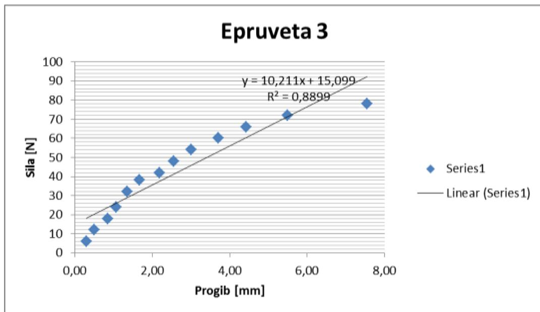
**Slika 5.26. Dijagram sila - progib za epruvetu 3**
