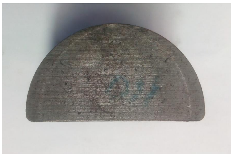
Slika 12. Obradak nakon odrezivanja na duljinu
