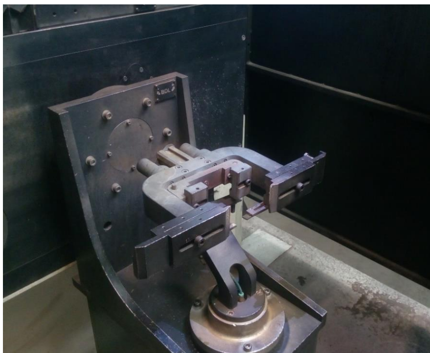
Slika 1. Okretno – nagibno – rotirajući prihvat (stol)
