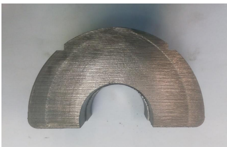
Slika 16. Obradak nakon glodanja unutarnje strane poluvaljka
