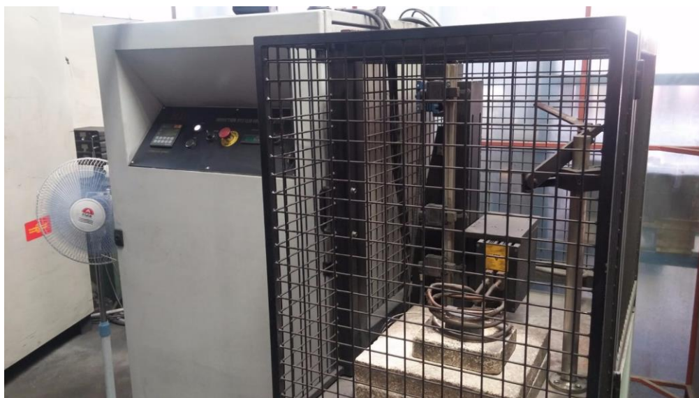
Slika 25. Predgrijavanje obratka na temperaturu 400 °C
