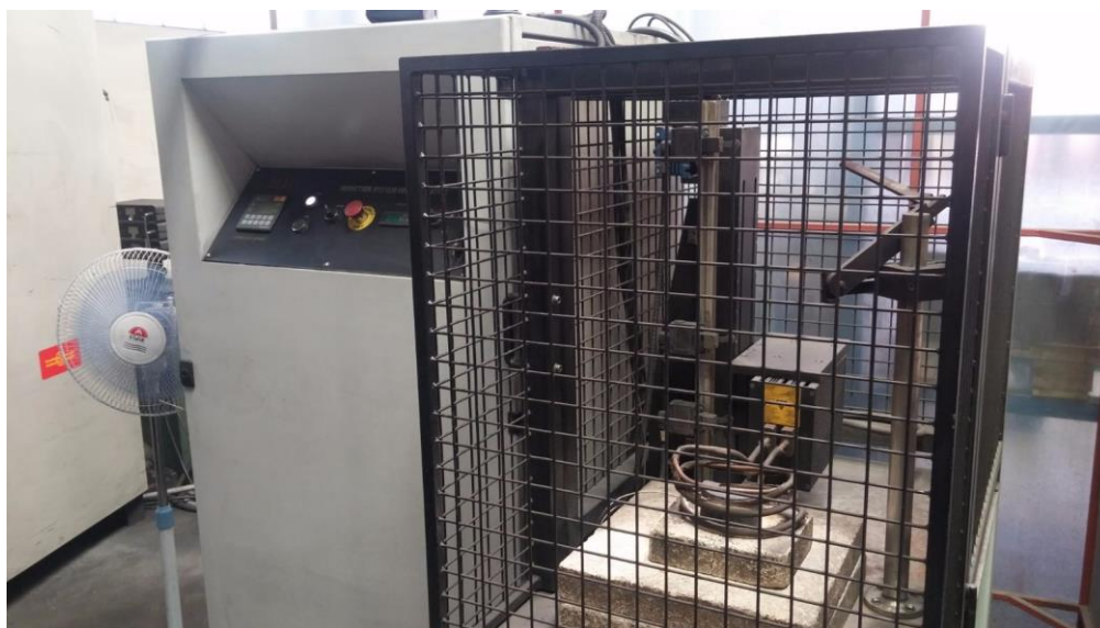
Slika 25. Predgrijavanje obratka na temperaturu 400 °C
