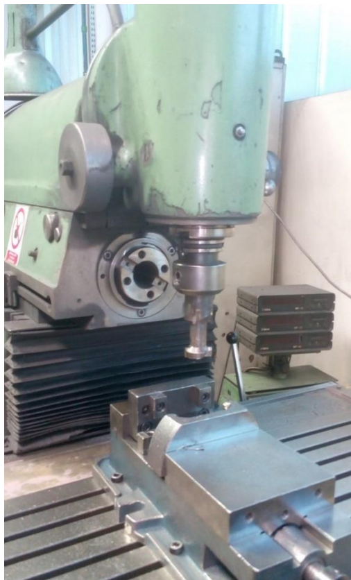
Slika 15. Vertikalna glodalica - glodanje unutarnje strane poluvaljka
