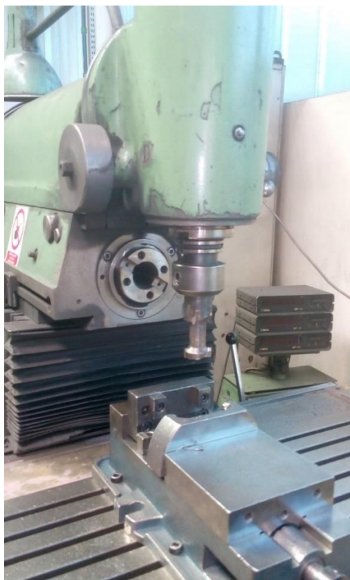
Slika 15. Vertikalna glodalica - glodanje unutarnje strane poluvaljka
