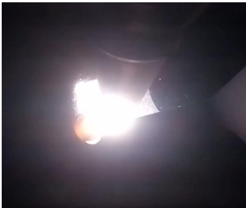
Slika 26. Navarivanje prvog obratka
