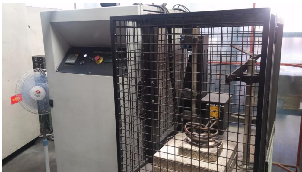
Slika 25. Predgrijavanje obratka na temperaturu 400 °C
