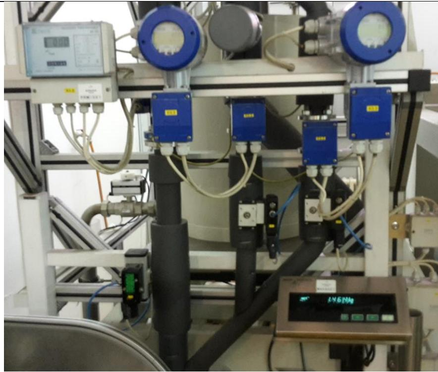
Slika 15. Dio ispitne linije s tri grane za namještanje tri protoka
