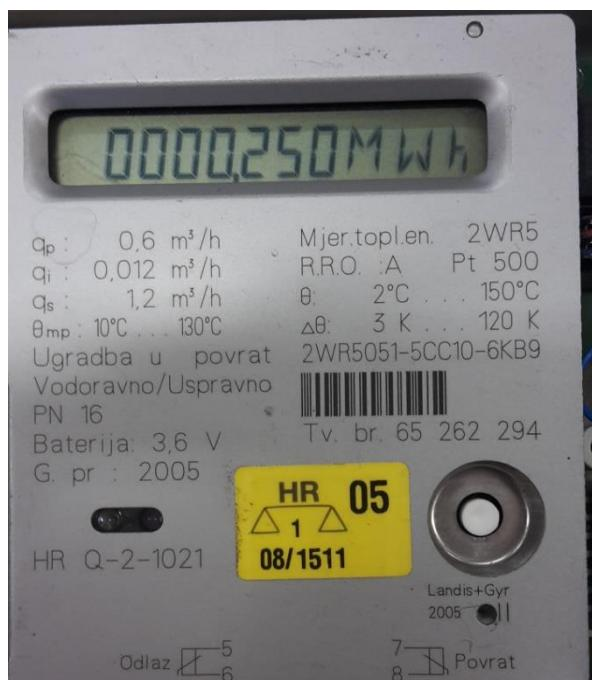
**Slika 21. Pločica s podacima o uređaju**
