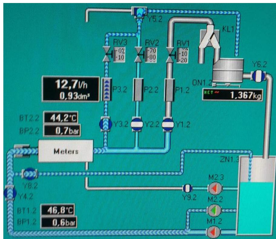
Slika 16. Shematski prikaz ispitne linije MT10/15-40
