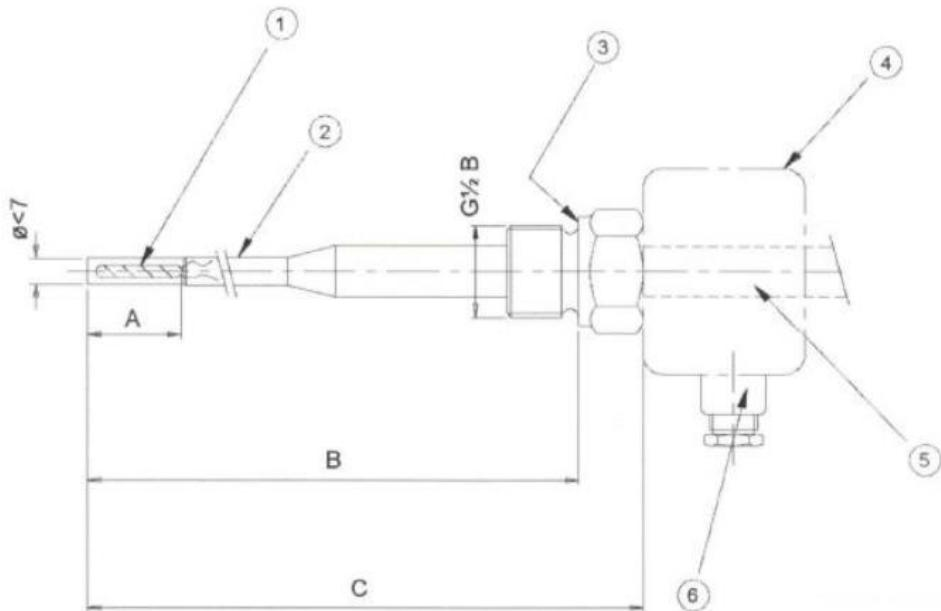
**Slika 9. Dimenziije mjerila temperature tipa DL**
