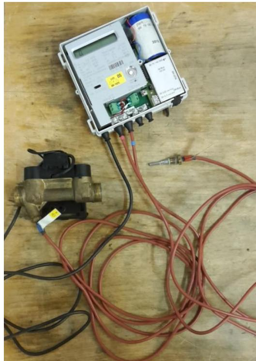
**Slika 14. Ispitivanje mjerilo toplinske energije**
