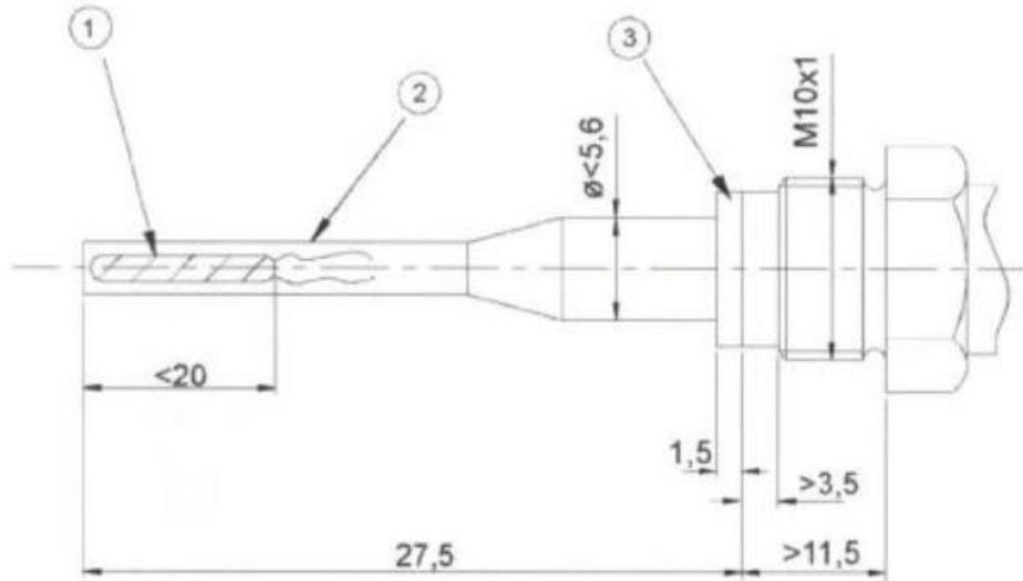
**Slika 8. Dimenziije mjerila temperature tipa DS**
