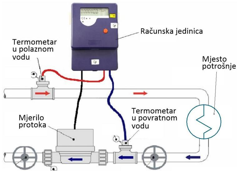
**Slika 4. Shematski prikaz ugradnje mjerila toplinske energije**
