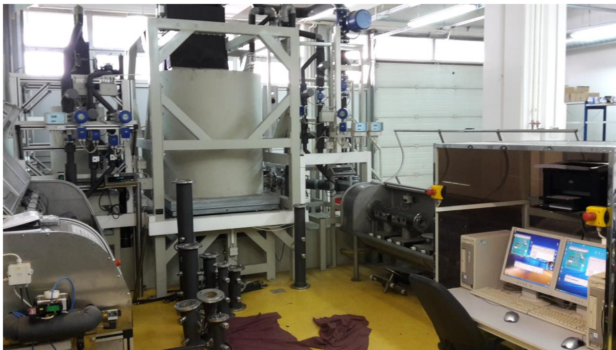
Slika 22. Umjeravanje mjerila protoka na ispitnoj liniji MT10/15-40
