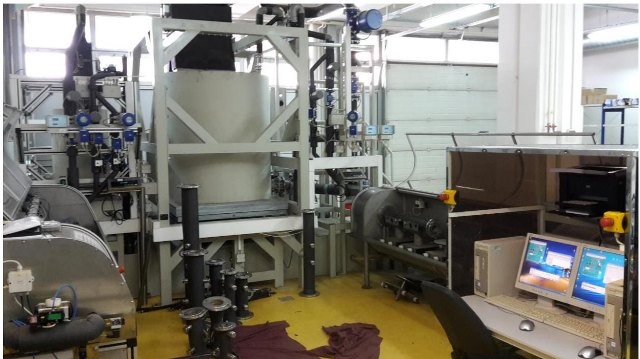
Slika 22. Umjeravanje mjerila protoka na ispitnoj liniji MT10/15-40
