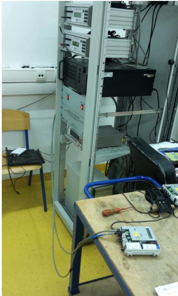
**Slika 24. Umjeravanje računske jedinice**
