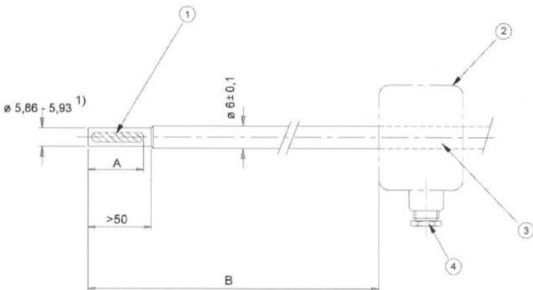
**Slika 10. Dimenziije mjerila temperature tipa PL**
