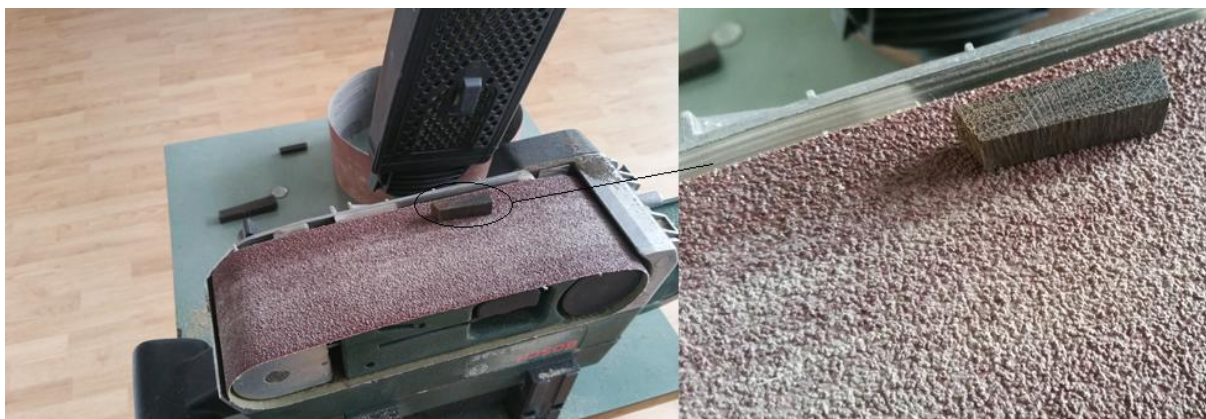
Slika 39. Stolna brusilica i obrada uzorka
