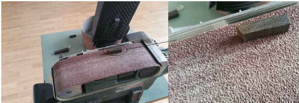
Slika 39. Stolna brusilica i obrada uzorka
