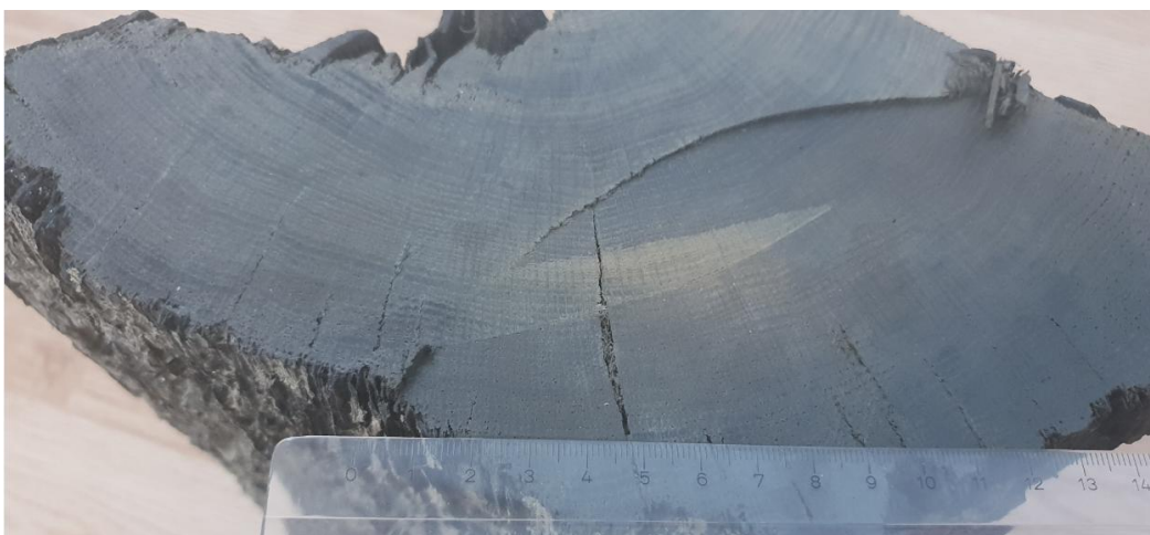
Slika 34. Makrostruktura poprečnog presjeka 1840 godina starog hrasta
