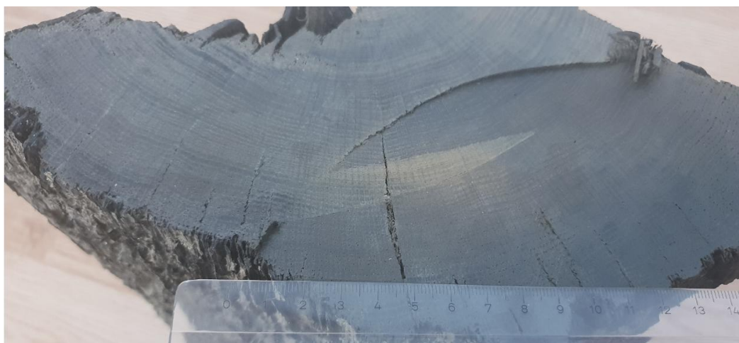
Slika 34. Makrostruktura poprečnog presjeka 1840 godina starog hrasta
