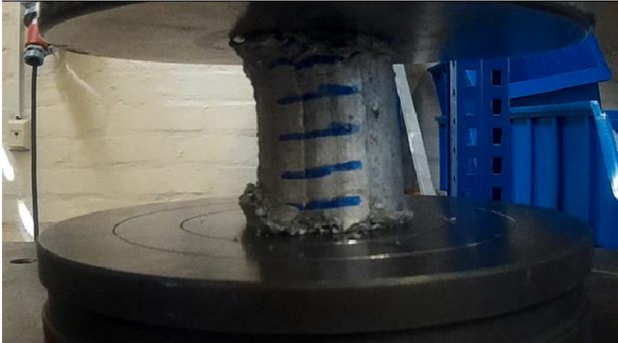
Slika 28 Uzorak prilikom tlačnja
