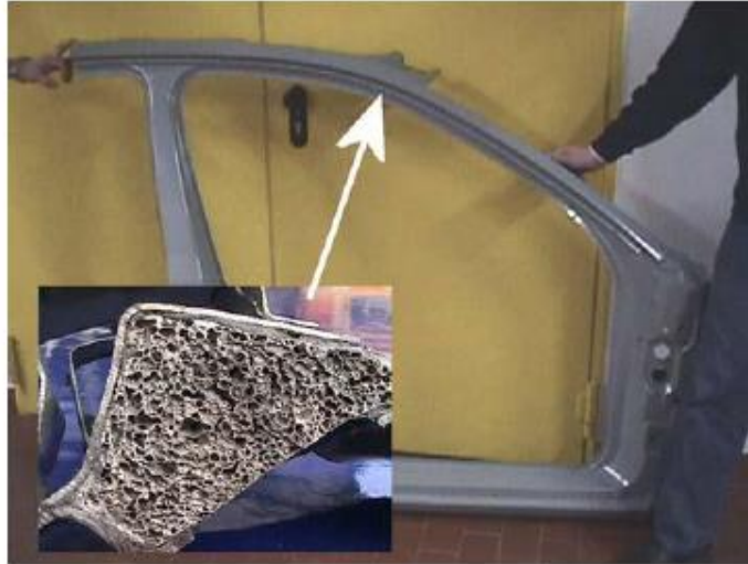
Slika 20 Karoserija automobila od metalne pjene [9]
