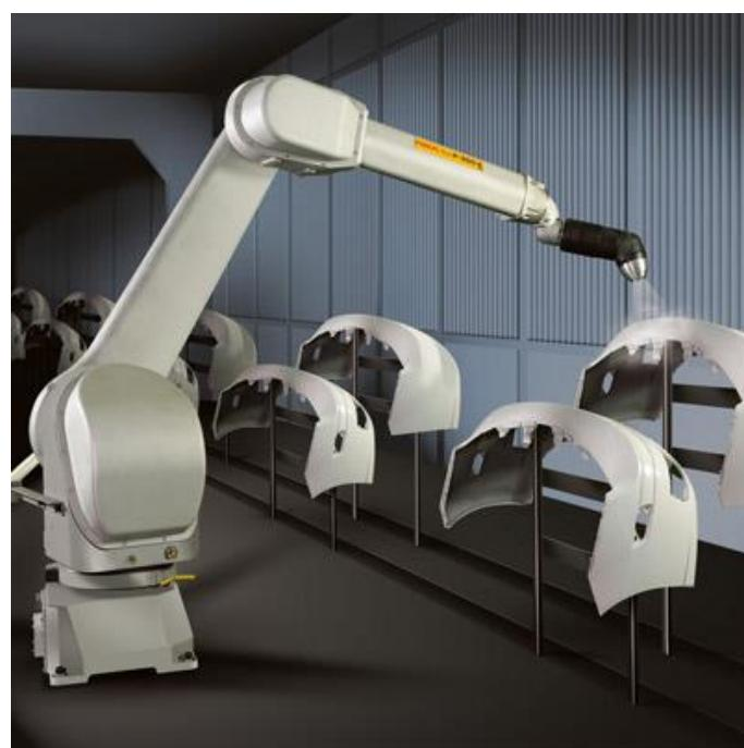
Slika 16. FANUC roboti za bojanje [20]
