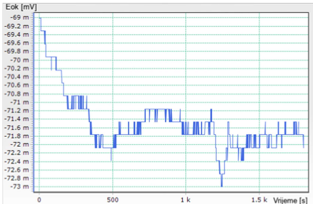
Slika 39. Dijagram potencijala otvorenog strujnog kruga za uzorak Ti6Al4V prevučen TENIFER postupkom
