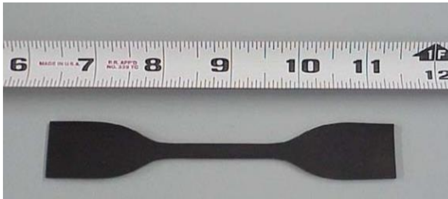
Slika 4. Epruveta od elastomera (gume) [3]
