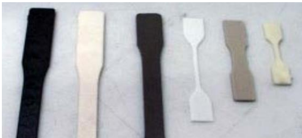
Slika 5. Epruvete od polimernih masa (plastomeri, elastomeri i duromeri) [3]
