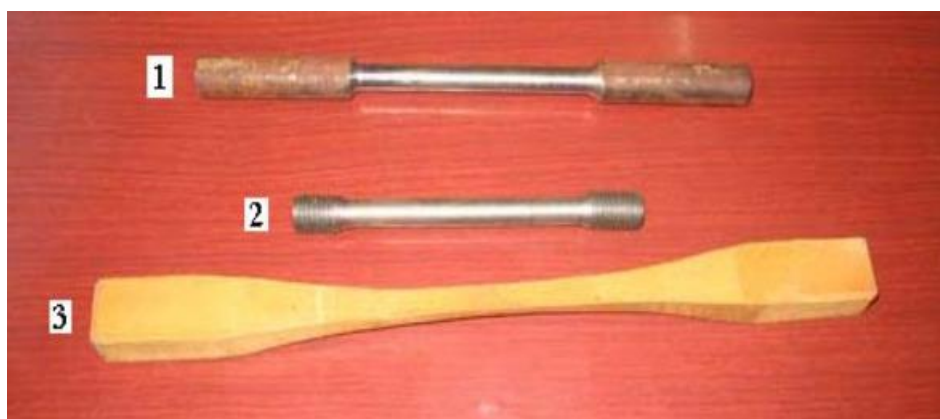
Slika 6. Epruvete od čelika (1), nodularnog ljeva (2), drva (3) [3]
