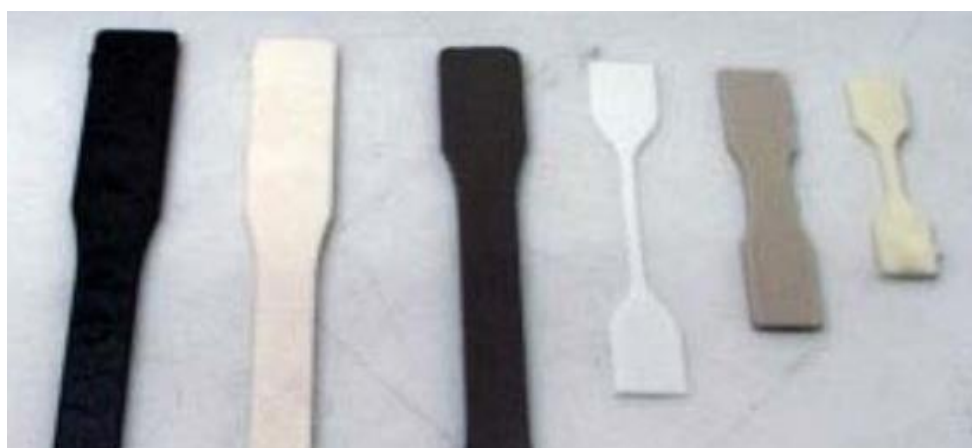
Slika 5. Epruvete od polimernih masa (plastomeri, elastomeri i duromeri) [3]
