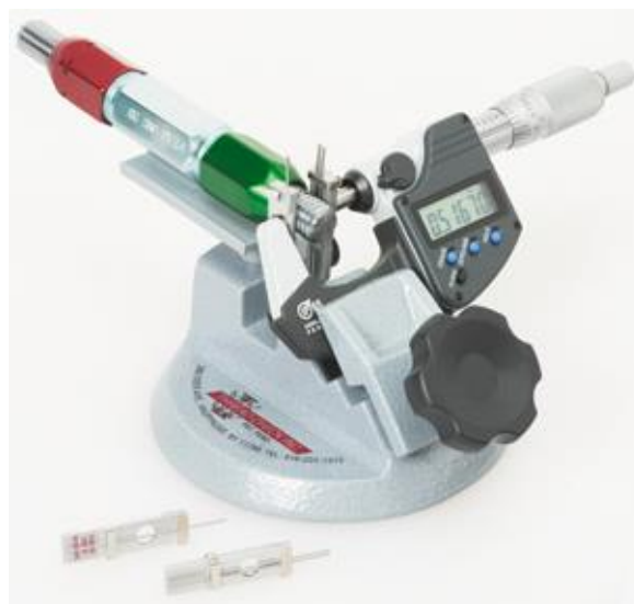
Slika 4. Korištenje valjčića u prihvatima[5]
