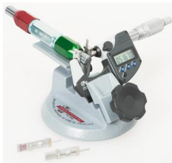
Slika 4. Korištenje valjčića u prihvatima[5]
