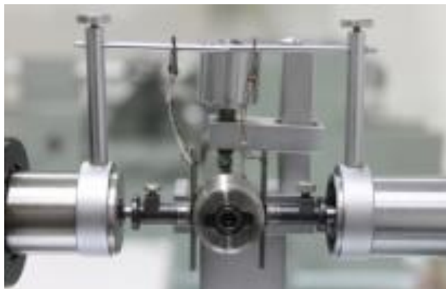
Slika 2. Korištenje valjčića bez prihvata[3]
