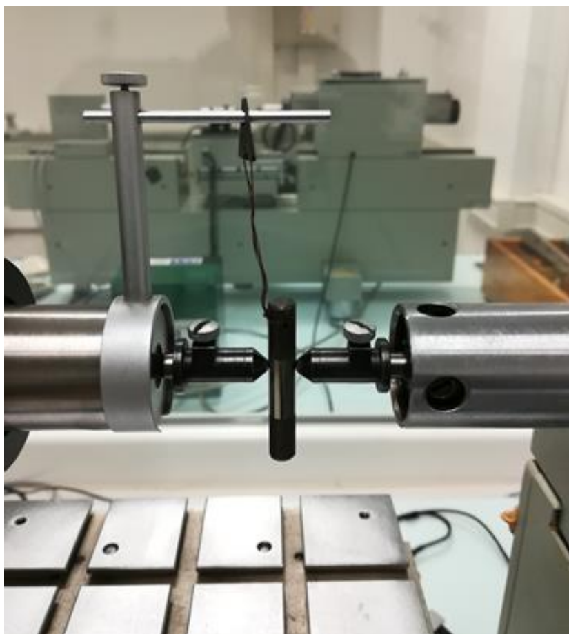
Slika 20. Prikaz mjerenja valjčića
