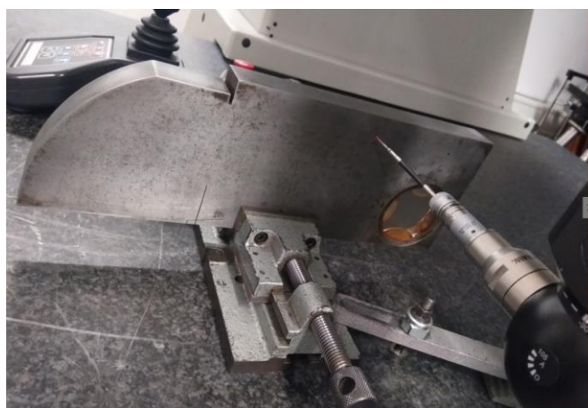
Slika 11. Prikaz mjerenja tolerancija etalona br. 1 CMM-om
