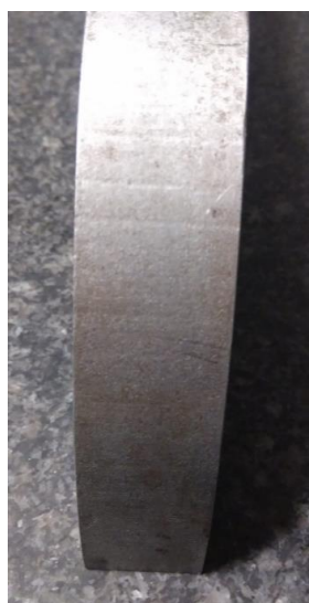
Slika 14. Prikaz mjerne površine kod R100 mm etalona br. 1
