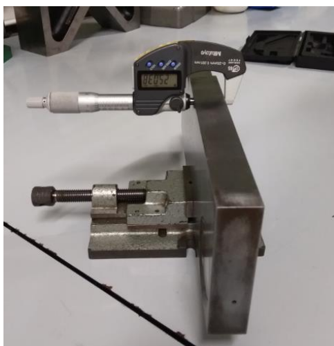
Slika 10. Prikaz mjerenja širine etalona br. 1 digitalnim mikrometrom
