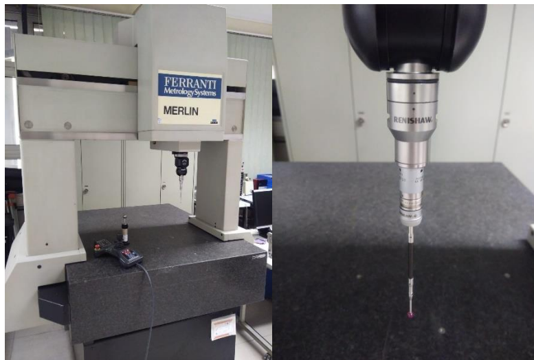
Slika 7. Trokoordinatni mjerni uređaj i mjerno ticalo
