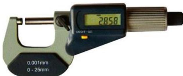
**Slika 8. Digitalni mikrometar**
