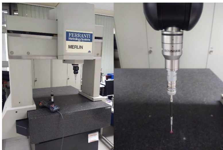
Slika 7. Trokoordinatni mjerni uređaj i mjerno ticalo
