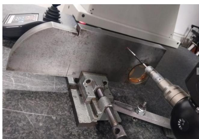
Slika 11. Prikaz mjerena tolerancija etalona br. 1 CMM-om
