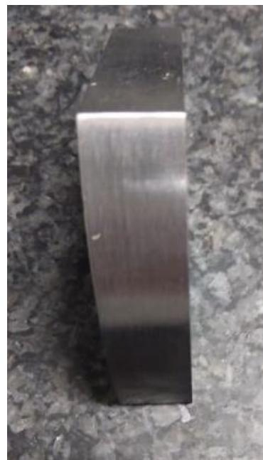
Slika 17. Prikaz mjerne površine kod R25 mm etalona br. 2
