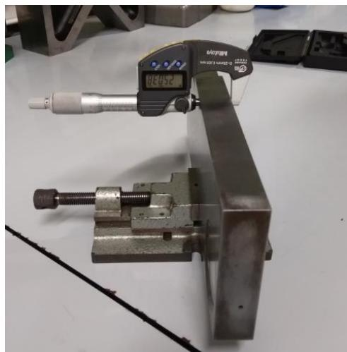
Slika 10. Prikaz mjerena širine etalona br. 1 digitalnim mikrometrom
