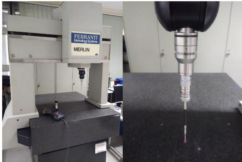
**Slika 7. Trokoordinatni mjerni uređaj i mjerno ticalo**
