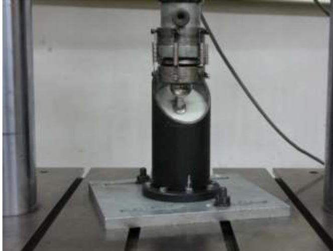
Slika 28. Sklop za opterećenje za dinamičko ispitivanje
