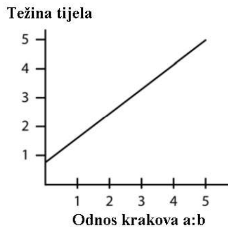
Slika 7. Ovisnost rezutante sile na glavu o omjeru krakova a:b [3]
