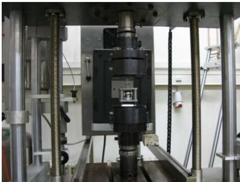
Slika 30. Eksperimentalni postav za statičko ispitivanje
