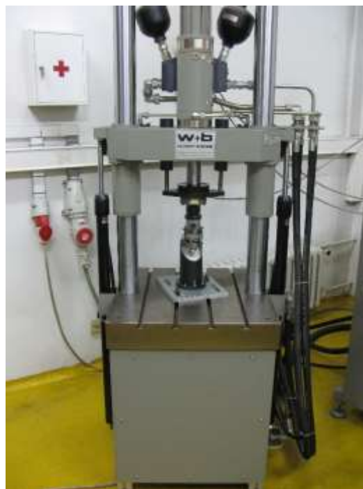
Slika 27. Eksperimentalni postav za dinamičko ispitivanje
