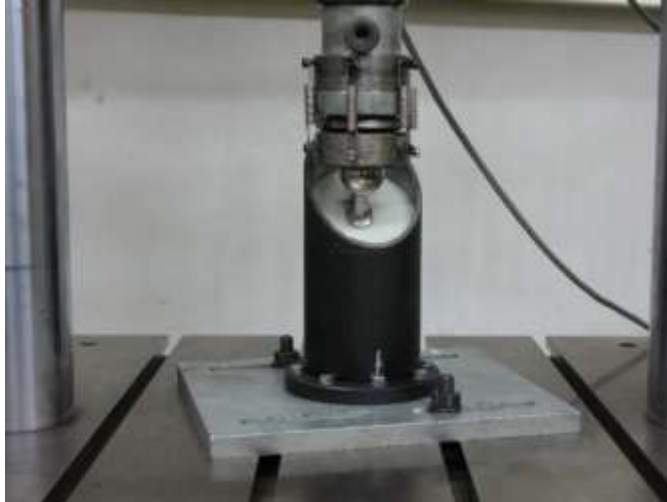
Slika 28. Sklop za opterećenje za dinamičko ispitivanje
