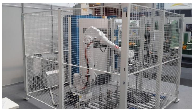
Slika 12. Industrijski robot osiguran kavezom [10]
