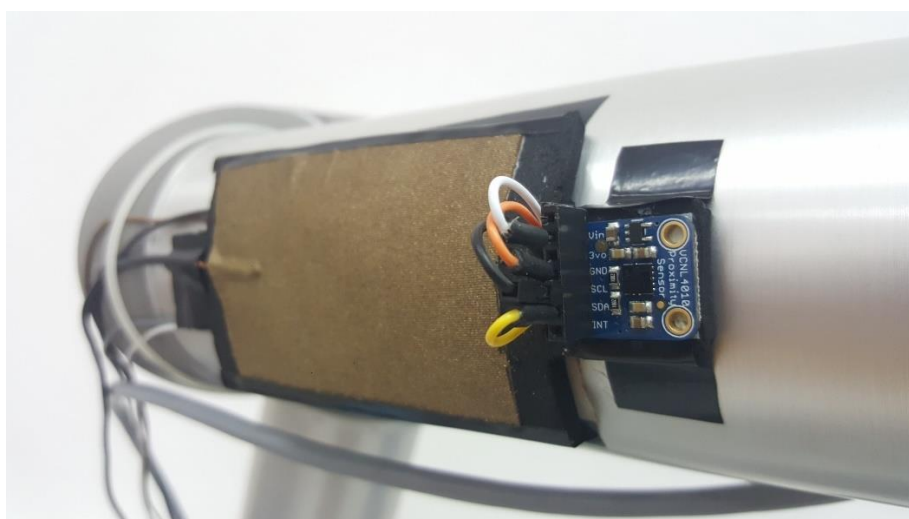
Slika 26. Osjetilni modul montiran na robotsku ruku (2)
