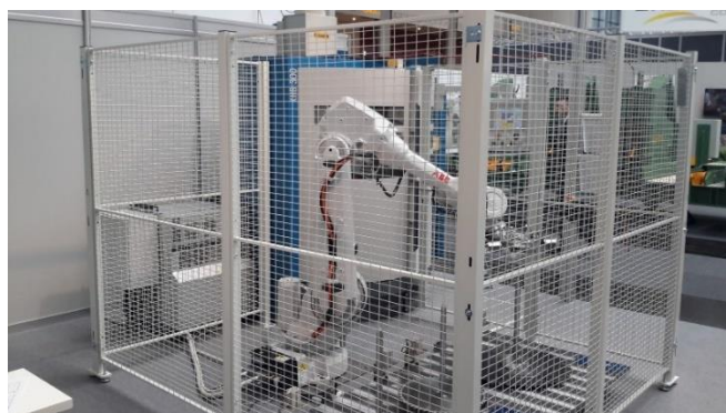
Slika 12. Industrijski robot osiguran kavezom [10]
