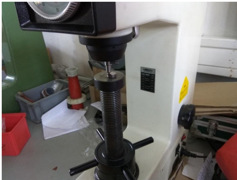
Slika 5.4 Ispitivanje adhezivnosti prevlake VDI testom
