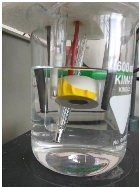
Slika 5.6 Raspored elektroda u elektrolitu
