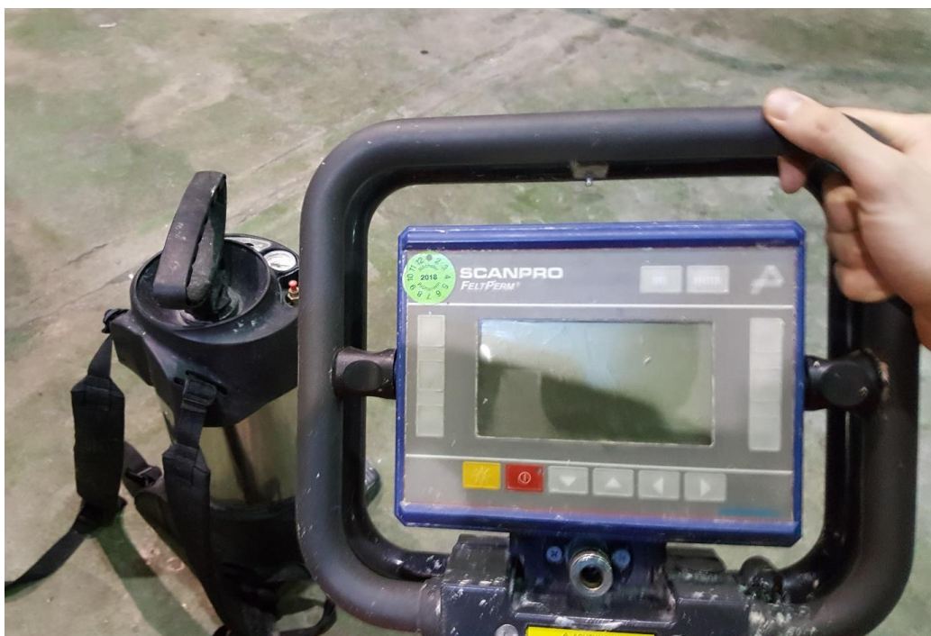
Slika 29. FeltPerm uređaj i boca pod tlakom
