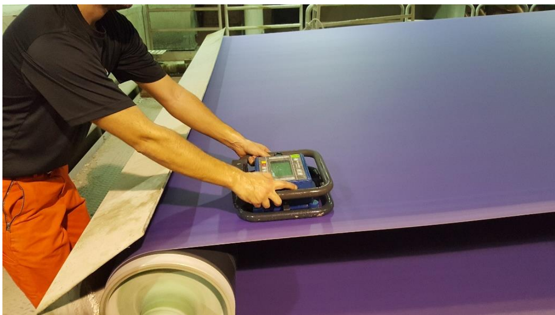
Slika 34. Postavljanje uređaja na filc
