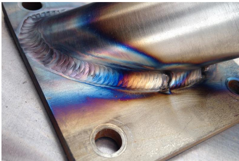
Slika 2. Obojenja površine nastala unosom topline postupkom zavarivanja [16].
