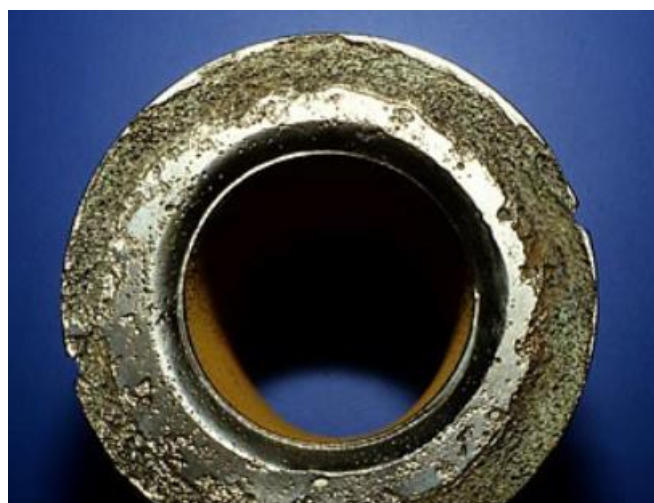
Slika 6. Korozija u procjepu na prirubnici od čelika AISI 316L (EN 1.4404) – cjevovod morske vode [24].
