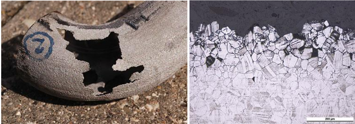
Slika 9. Interkristalna korozija na čeliku AISI 304 (EN 1.4301). Senzibilizacija je bila uzrokovana neprimjerenom toplinskom obradom, što je dovelo do interkristalne korozije tijekom naknadne obrade kemijskim nagrivanjem (lijevo); mikroskopski prikaz oštećenja (desno) [24].
