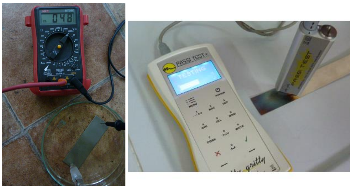
Slika 39. Mjerenje potencijala (lijevo) i pasivnosti (desno) površine uzoraka.
