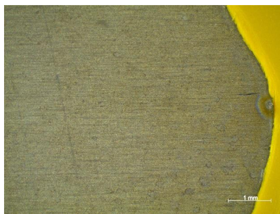
Slika 35. Detalj površine kemijski obrađenog uzorka otopinom 1 nakon cikličke polarizacije u viski-gaziranoj vodi – vidljivo je nastalo korozijsko oštećenje koje potvrđuje eluciju metalnih iona.
