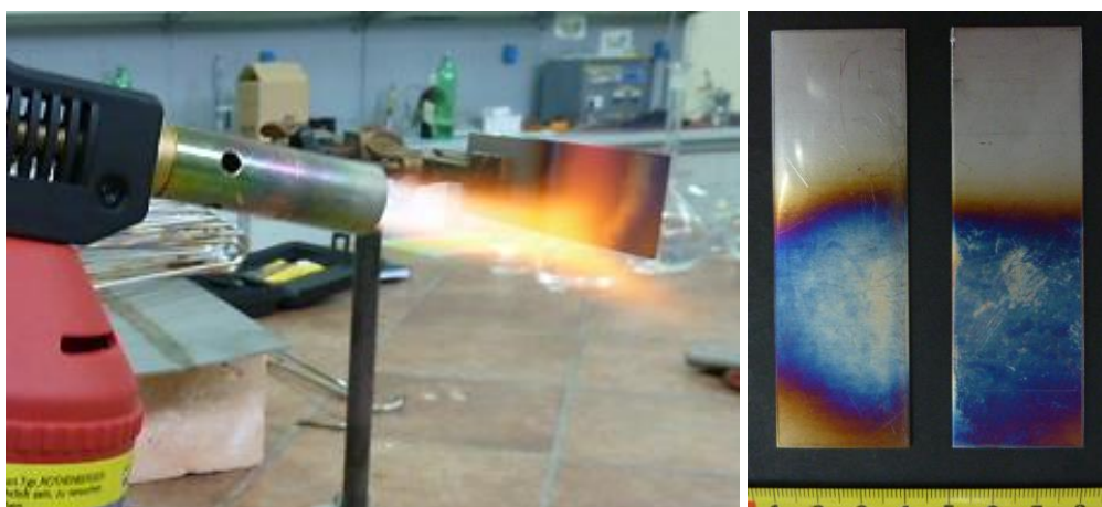
Slika 26. Pinsko zagrijavanje uzorka (lijevo); uzorci s toplinskim obojenjima (desno).
