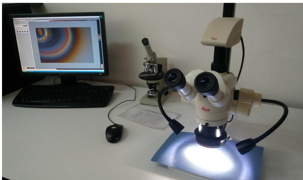
Slika 23. Oprema za ispitivanje površine uzoraka – stereomikroskop Leica MZ6.
