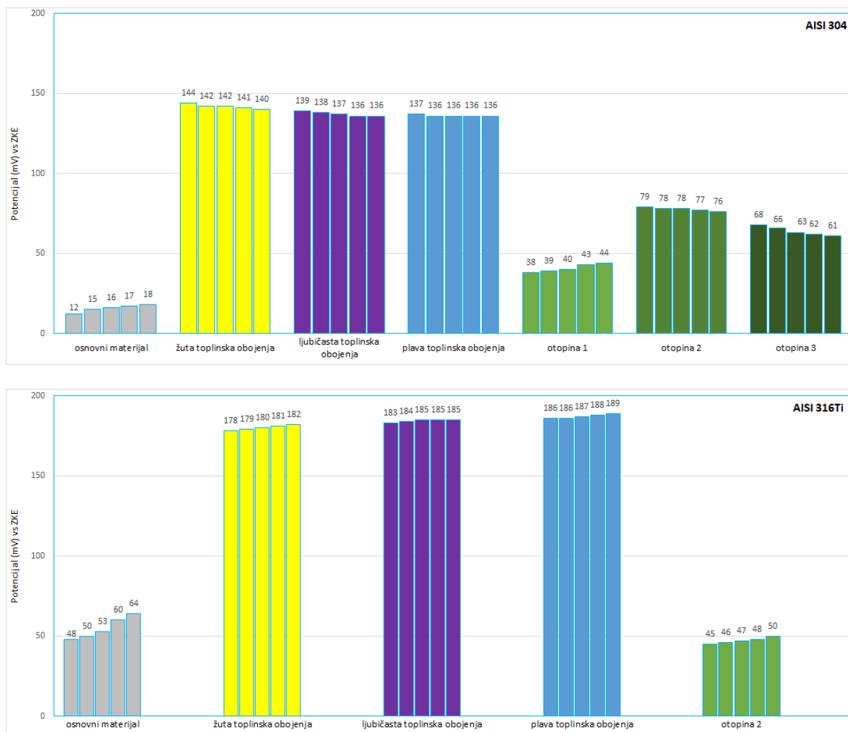
Slika 40. Rezultati mjerenja potencijala multimetrom uz korištenje kalomel elektrode.
