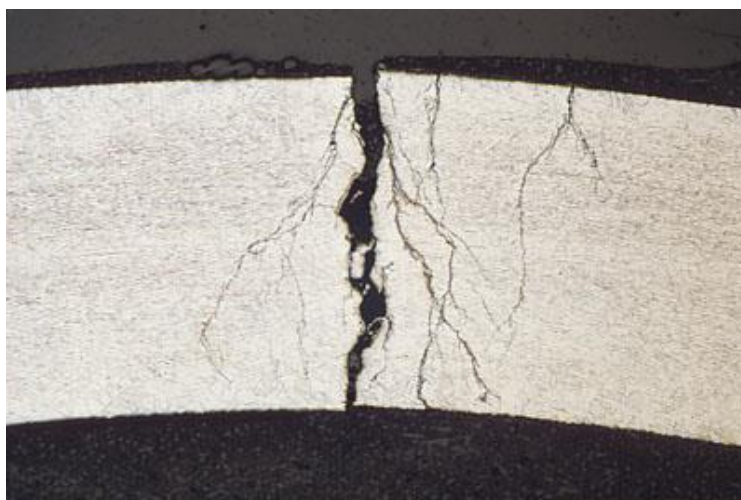
Slika 8. Napetosna korozija na čeliku AISI 304 (EN 1.4301), voda temperature 60\text{ }^\circ\text{C} [24].
