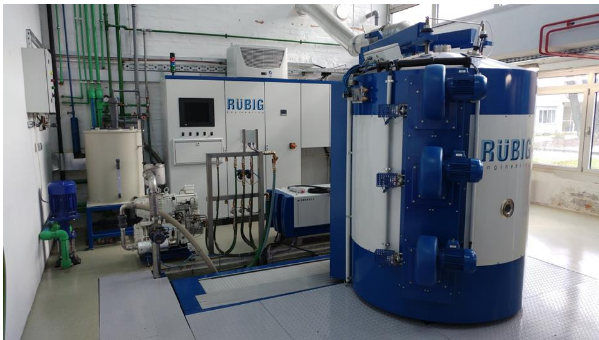
Slika 1. PACVD uređaj na Fakultetu strojarstva i brodogradnje u Zagrebu
