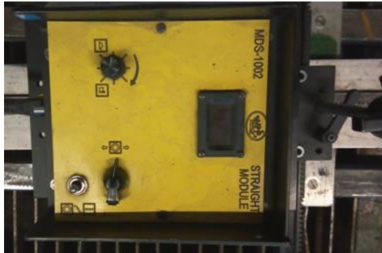
Slika 3.6 Kontrolna ploča MDS -1002 modularnog sustava za zavarivanje
