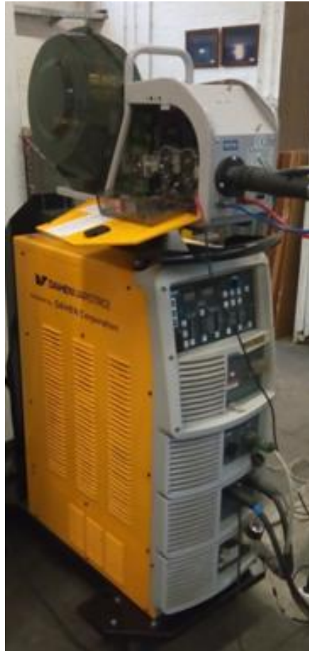
Slika 3.1 Welbee P500L izvor struje za zavarivanje
