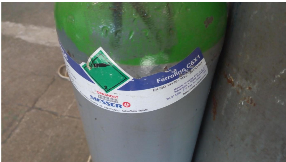
Slika 3.10 Spremnik C6X1 zaštitnog plina
