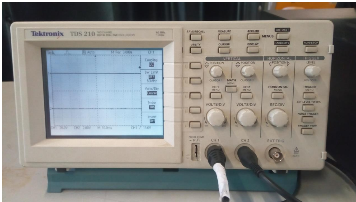
Slika 3.2 Tetronix TDS 210 dvokanalni osciloskop
