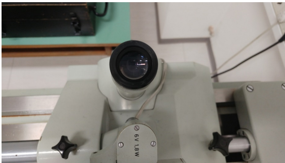
Slika 8- Optički sustav za precizno pozicioniranje klizača duge mjerne skale
