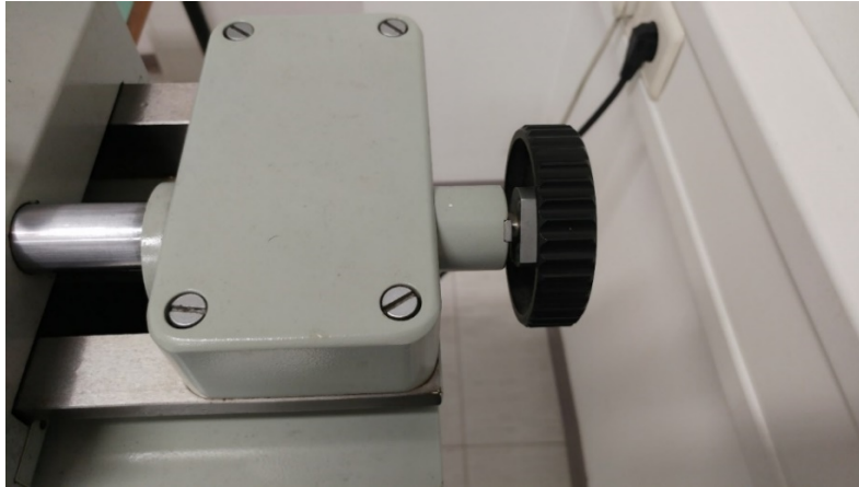
Slika 7- Sustav za precizno pozicioniranje klizača duge mjerne skale
