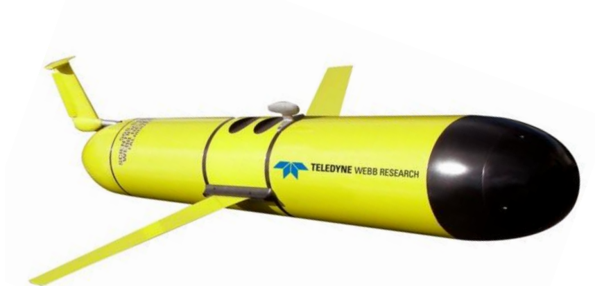
Slika 2.26 Teledyne SLOCUM Glider AUV
