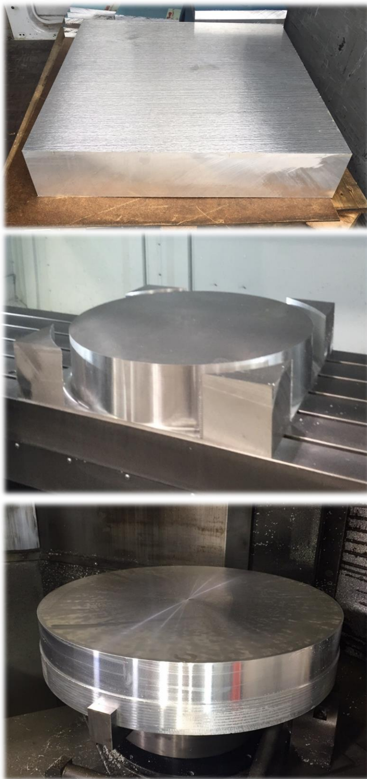
Slika 4.11 Dobivanje cilindra iz piljenog ingota
