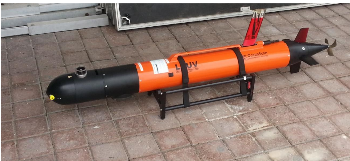
Slika 2.25 OceanScan LUPIS1-LAUV Laboratorija za podvodne sustave i tehnologije
