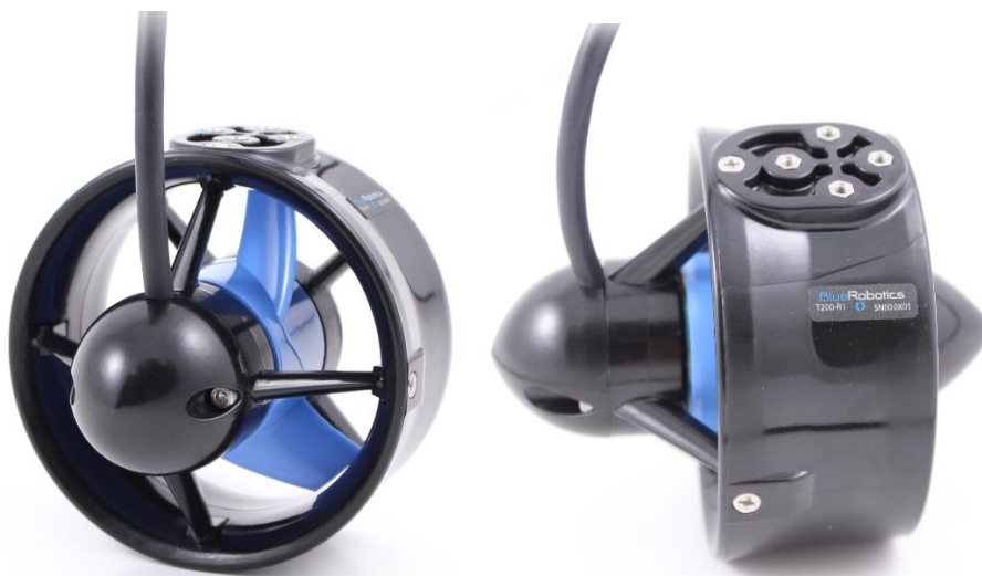
Slika 3.21 BlueRobotics T200 porivnik [41]
