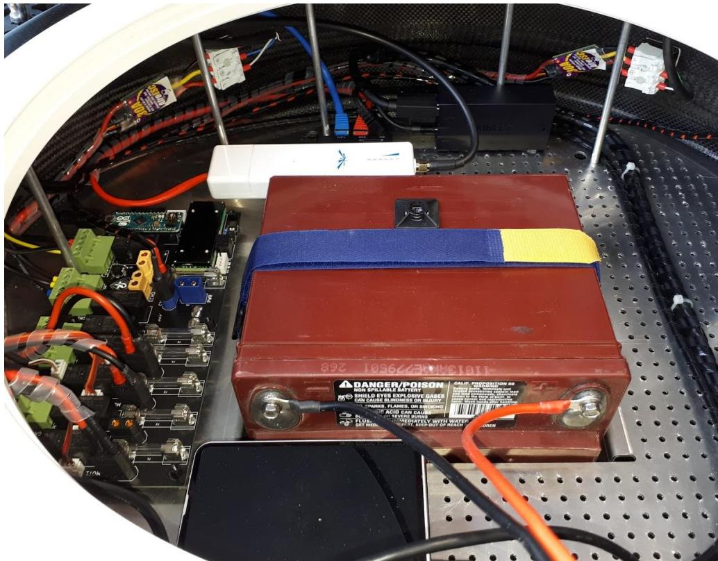
Slika 4.17 Ožičenje i ploče za smještaj elektroničkih uređaja
