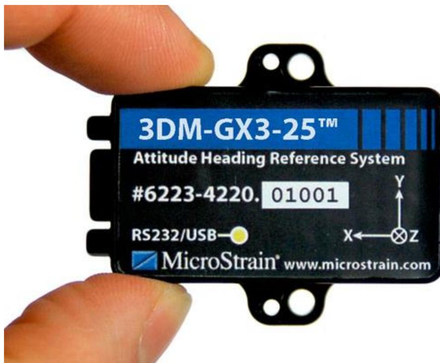
Slika 3.11 Microstrain 3DM-GX3 minijaturni MEMS IMU [31]
