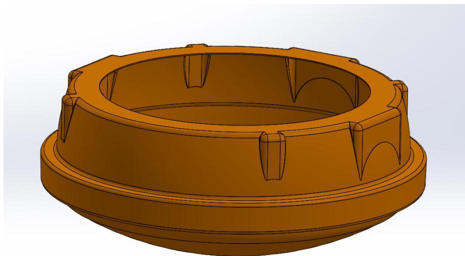
**Slika 4.9 3D model kompozitne lјuske**
