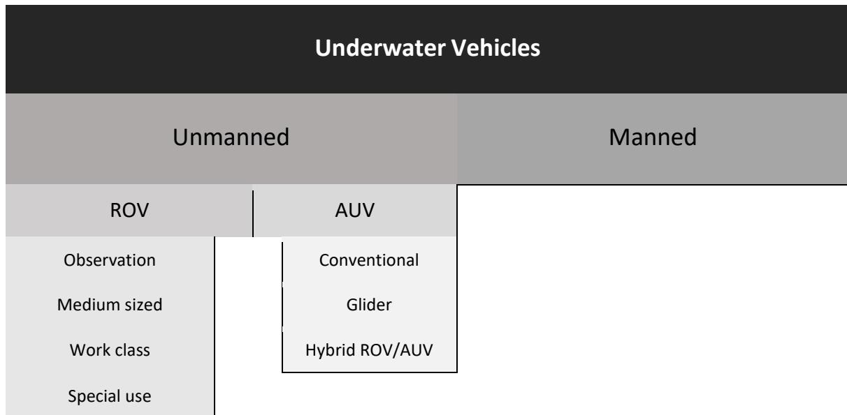
**Tablica 2.1 Shematski prikaz podjele podvodnih vozila [18]**
