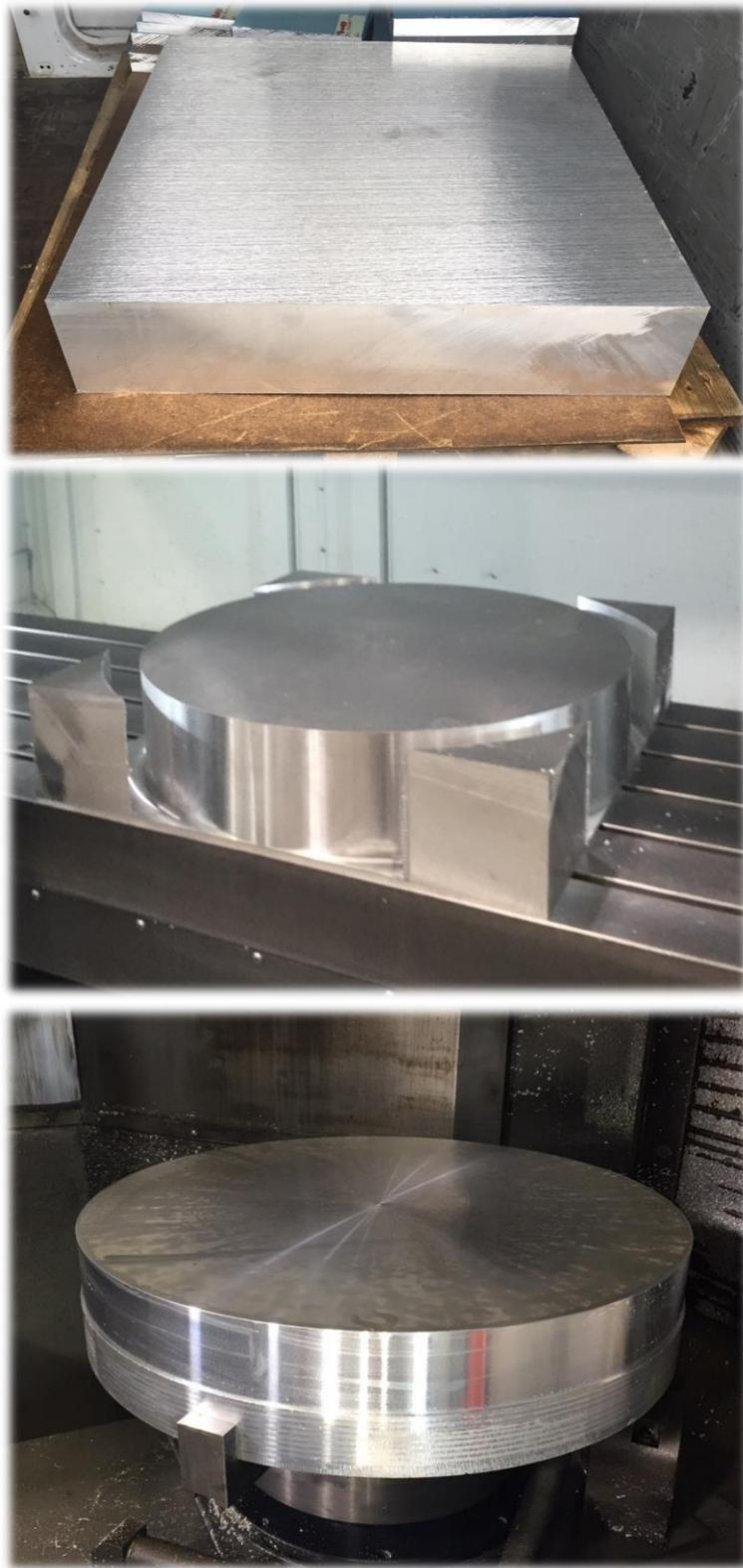
**Slika 4.11 Dobivanje cilindra iz piljenog ingota**
