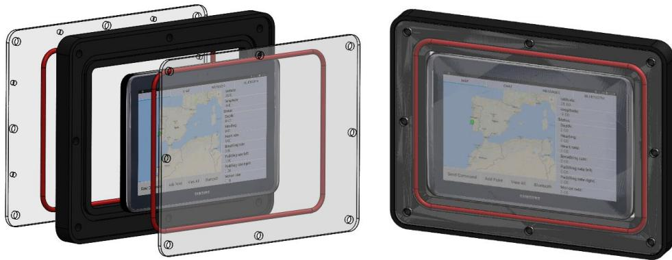
**Slika 4.30 Kućište za tablet na BUDDY autonomnom robotu**
