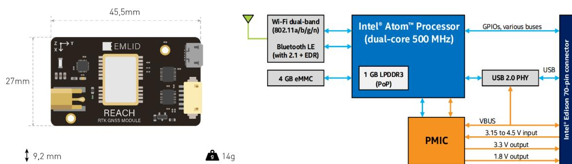
**Slika 3.13 Dimenzijski prikaz i strukturalni diagram**
