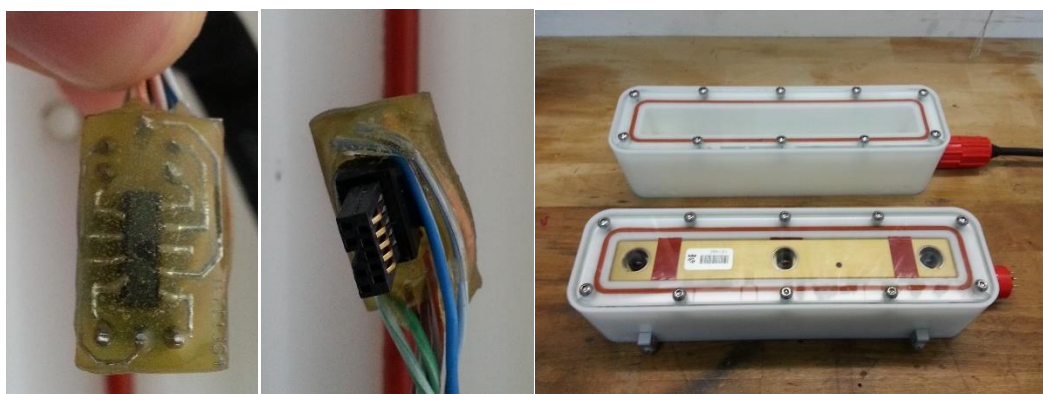
Slika 4.27 Izrađena pločica za IEEE1394 konektor te izrađeno kućište
