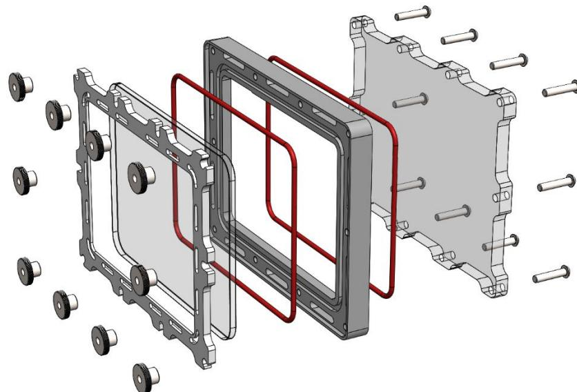
Slika 4.1 Eksplodirani prikaz konstrukcije kućišta za tablet
