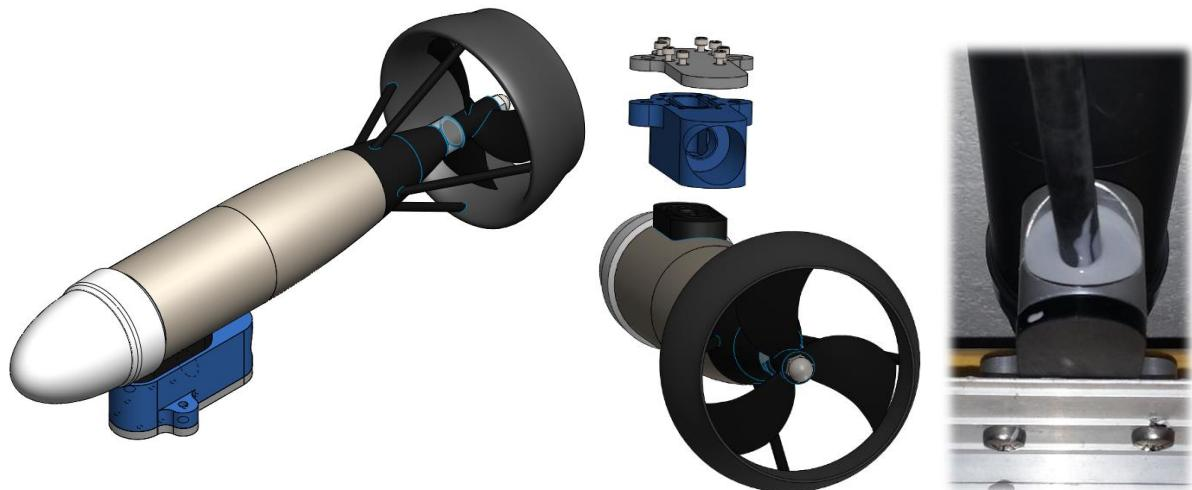
**Slika 4.29 Jedinica porivnika s zabrtvijenim kabelskim produžetkom(desno)**
