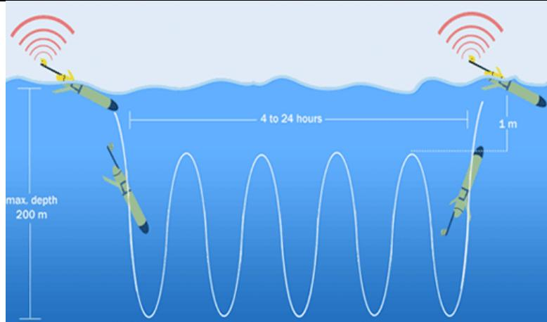
**Slika 2.27 „Yo-Yo“ manevr te princip rada GLIDER vozila**
