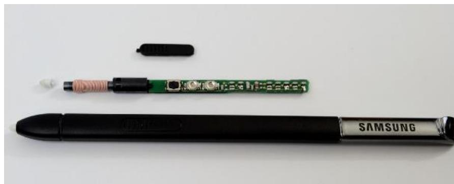
Slika 4.5 Sklop induktivne olovke za unos na tabletu
