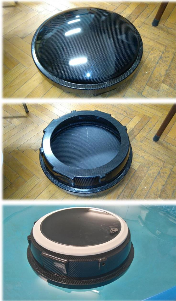
**Slika 4.14 Lakiranje ljske bezbojnim premazom, bušenje prodora za kablove te ljepljenje palubnog poklopca**
