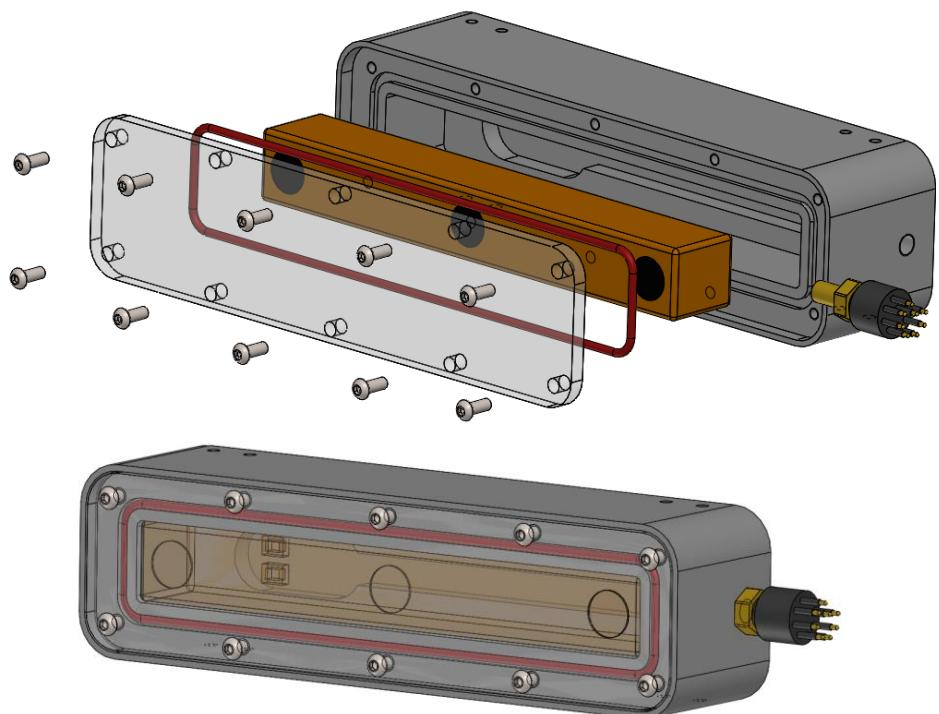
**Slika 4.26 Konstrukcija i eksplodirani prikaz kućišta**
