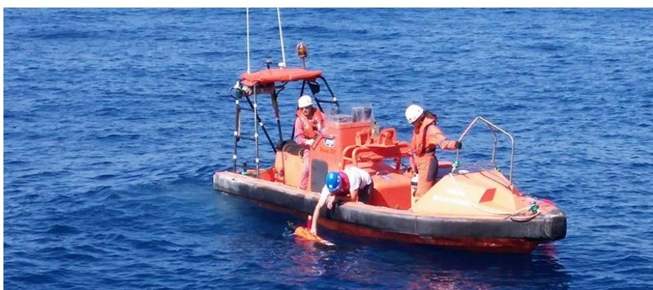
**Slika 2.15 Lansiranje ronilice OceanScan LAUV na misiju (20kg)**
