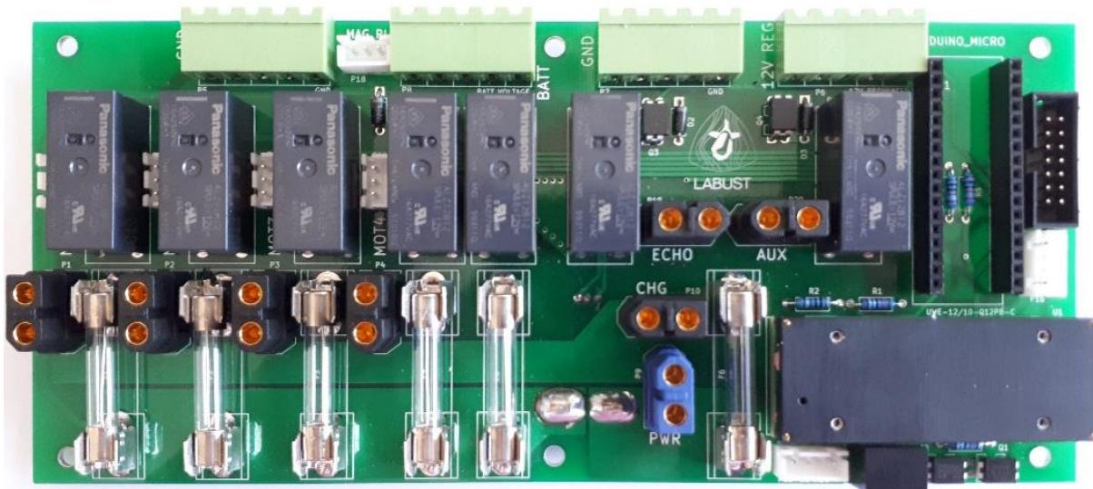
Slika 4.21 Prikaz gotove pločice za razvod sa zalemnjem komponentama
