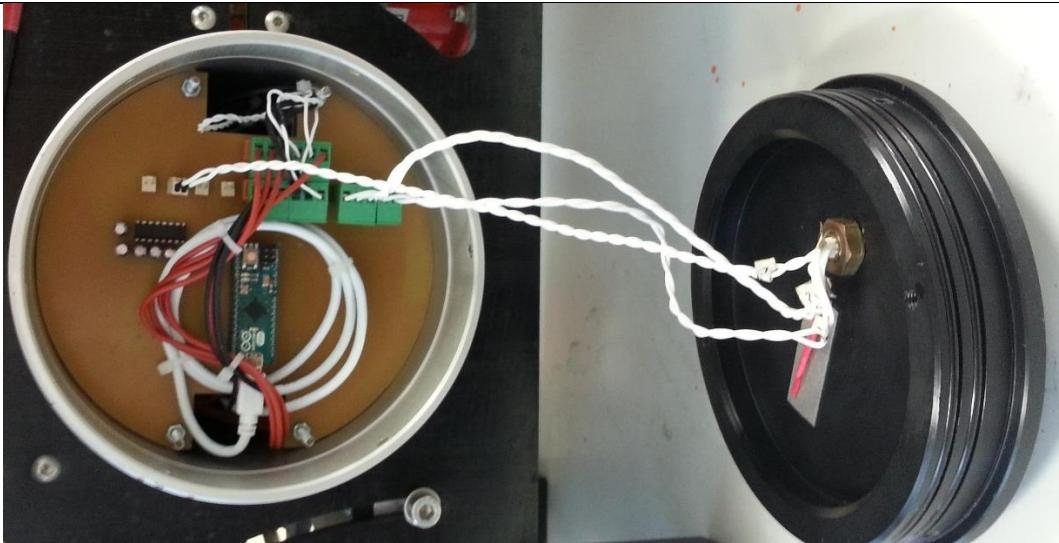
**Slika 4.41 Pločica mikrokontrolera te razvoda napajanja te spojeni dovod napajanja sa šasijskog konektora na poklopocu spremnika**
