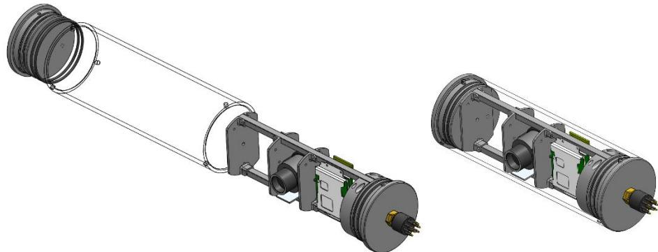
**Slika 4.28 Konstrukcija kućišta BOSCH [28] kamere**
