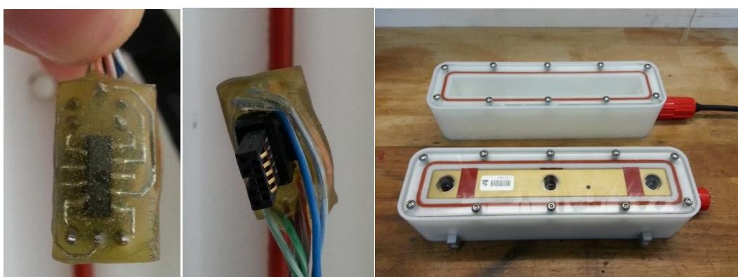
**Slika 4.27 Izrađena pločica za IEEE1394 konektor te izrađeno kućište**
