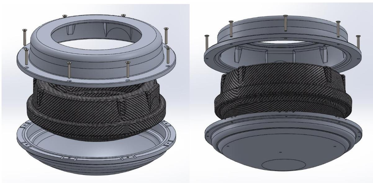
Slika 4.10 Konstrukcija kalupa za izradu kompozitne ljske
