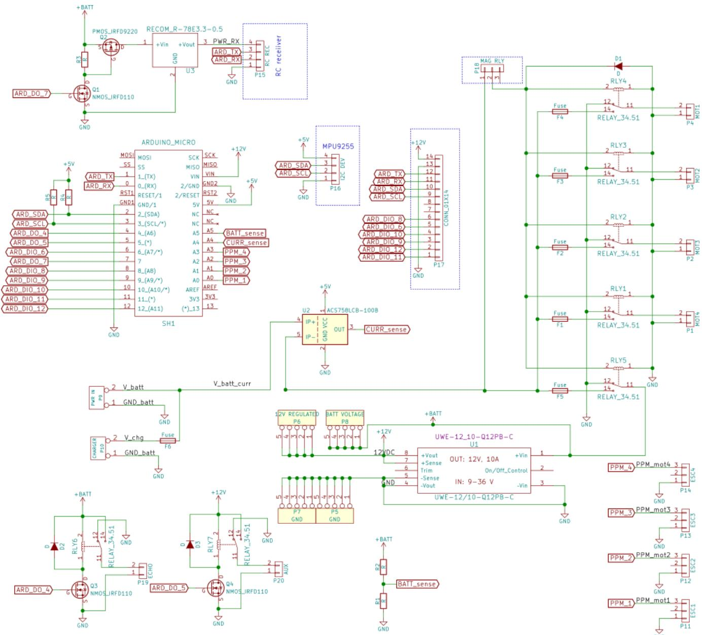
Slika 4.19 Elektronička shema razvodne pločice „powerboard“
