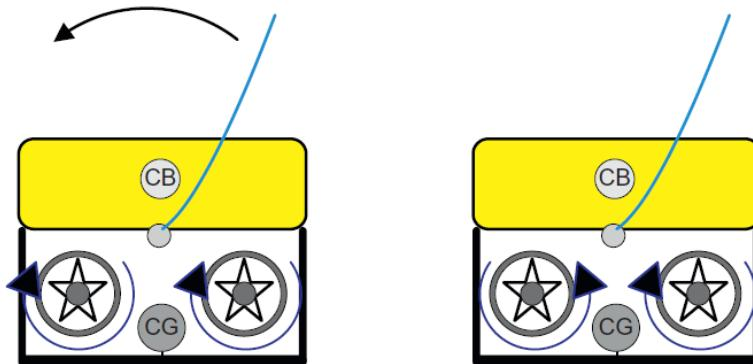
**Slika 2.29 Istosmjerno rotirajući propulzori(lijevo) te suprotno rotirajući(desno) [18]**
