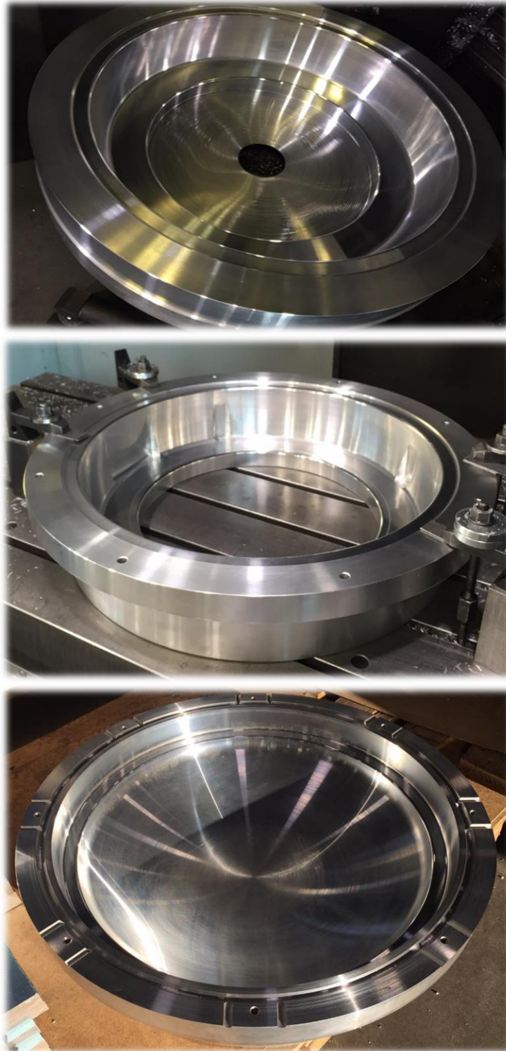
Slika 4.12 Tokarenje i glodanje kalupne šupljine
