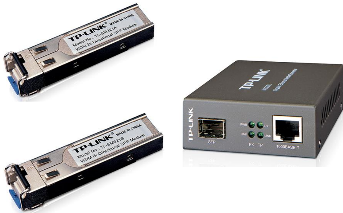
Slika 3.15 Pretvarač medija MC220L s odgovarajućim modulima za različite krajeve optičkog vlakna [40]
