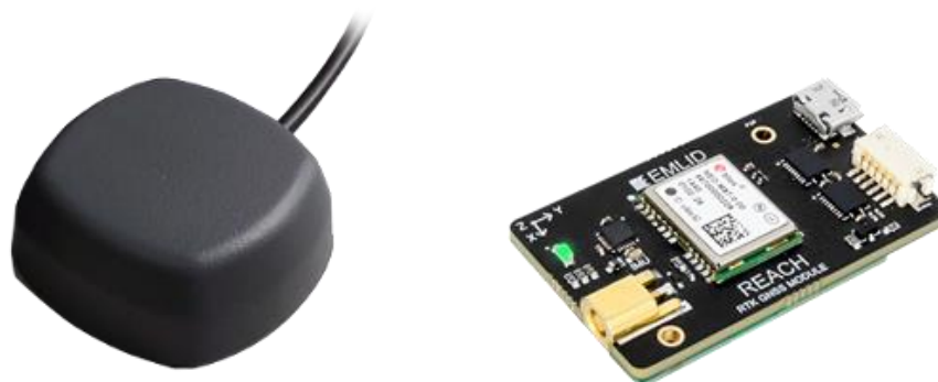
Slika 3.12 Reach RTK GNSS prijemnik [35]
