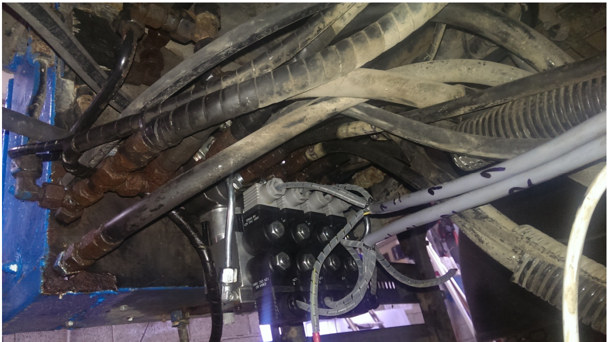
Slika 4.1 Stražnji prikaz grupe razvodnika 4/3
