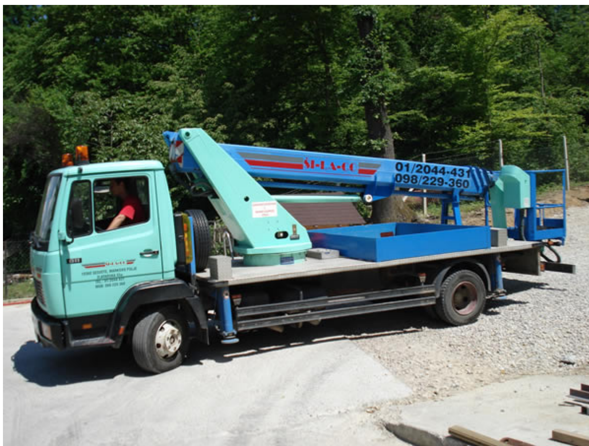
Slika 1.1 Kamion Mercedes-Benz 811 i dizalica Wumag WT 225
