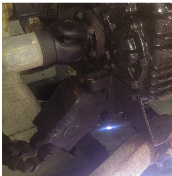
Slika 4.3 Prikaz integrirane aksijalno klipne pumpe s prijenosnikom MSUI
