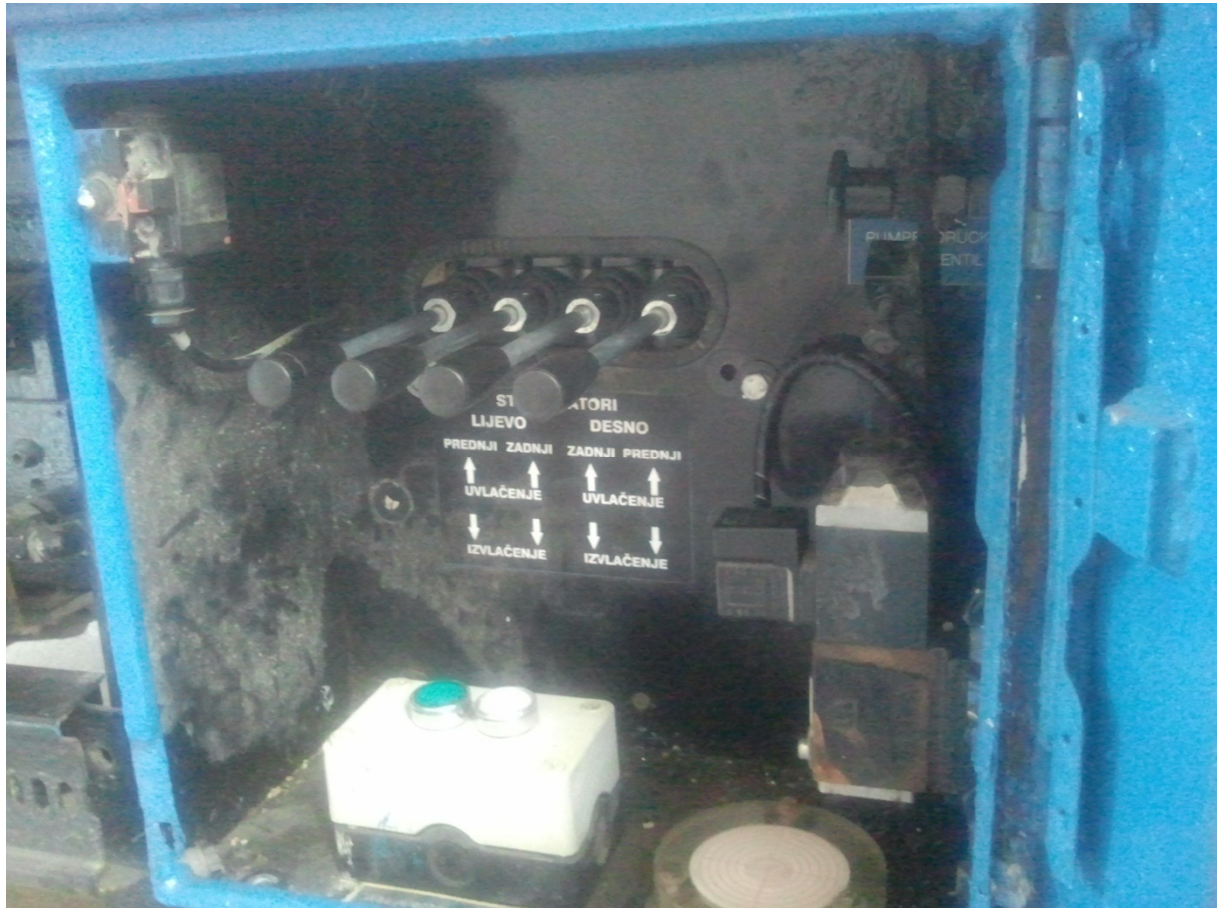
Slika 6.3 Ormarić za ručnu i automatsku nivelaciju
