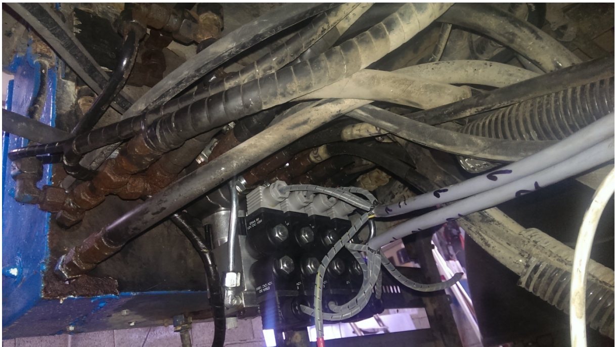
Slika 4.1 Stražnji prikaz grupe razvodnika 4/3
