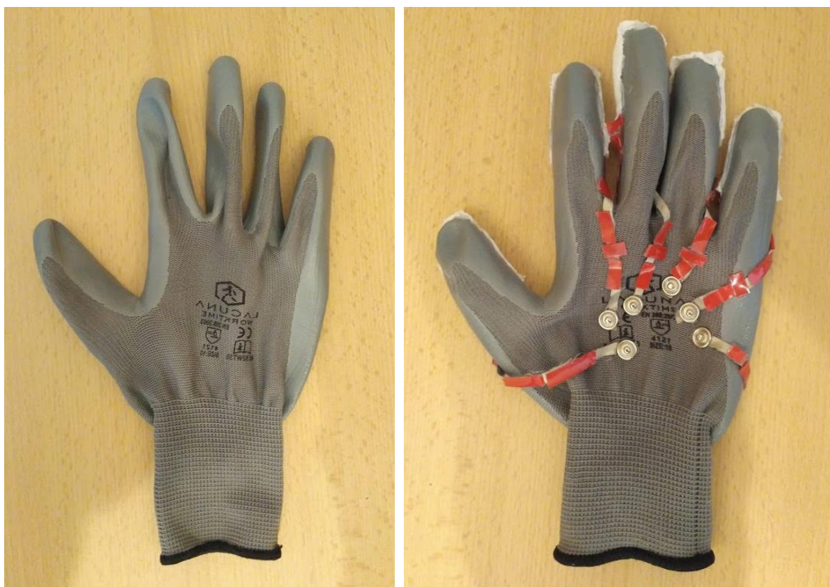
Slika 39. Gornja strana rukavice prije i poslije stavljanja senzora
