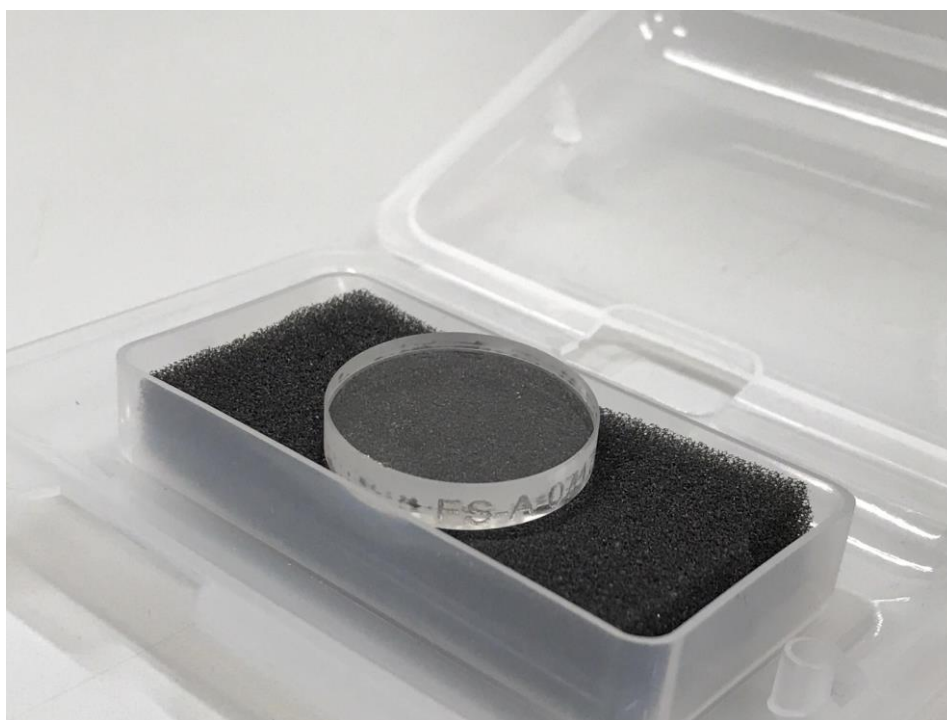
Slika 18. Referentna pločica tvrdoće; fused silica
