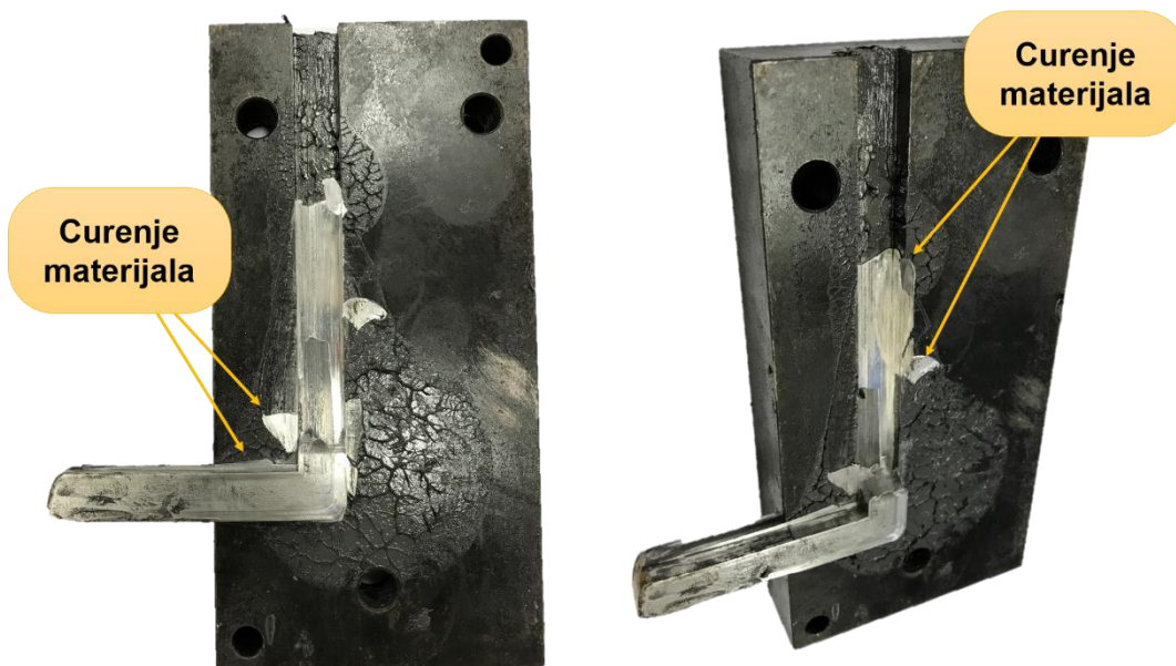
Slika 49 – Curenje materijala uzorka zbog deformacije matrice
