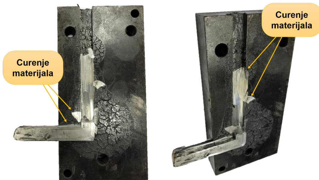
Slika 49 – Curenje materijala uzorka zbog deformacije matrice
