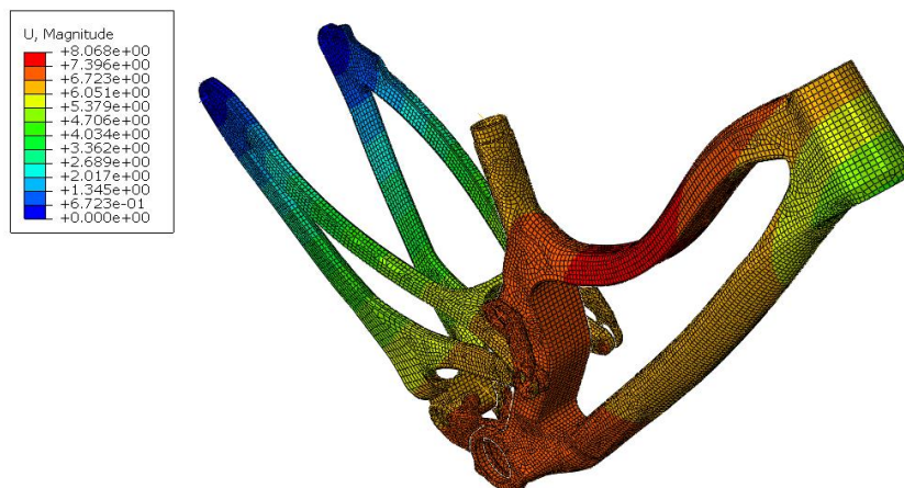
Slika 49. Vrijednosti ukupnih pomaka U [mm] za treći slučaj opterećenja
