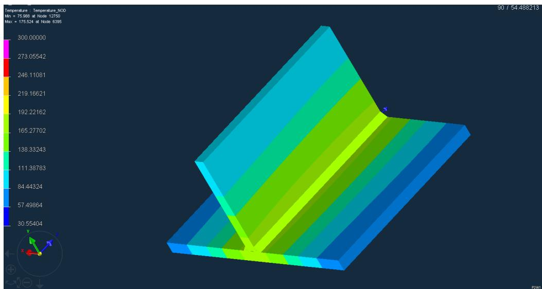
Slika 25. Temperaturna raspodjela 290 s nakon zavarivanja
