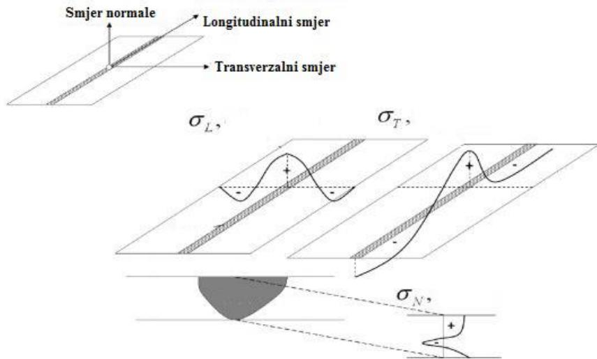
**Slika 7. Podjela zaostalih naprezanja prema smjeru djelovanja [12]**
