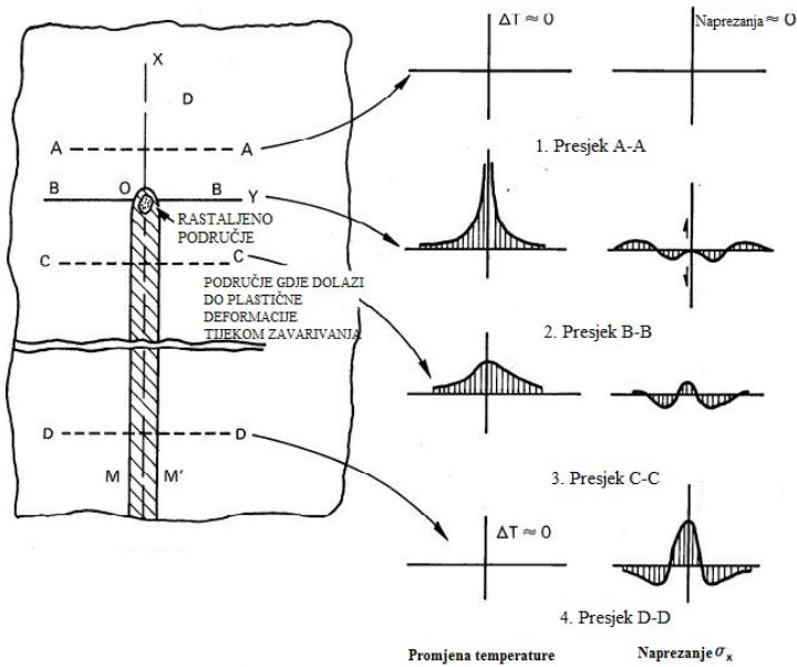
Slika 8. Distribucija temperature i naprezanja za vrijeme zavarivanja [14]
