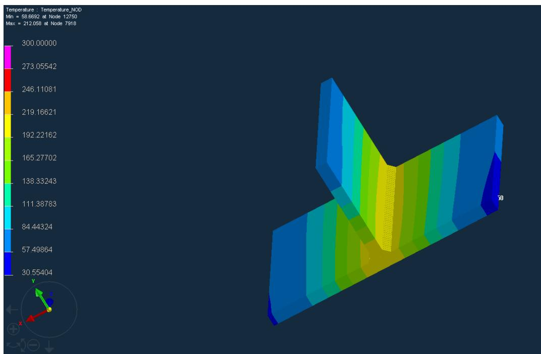
Slika 26. Temperaturna raspodjela 403 s nakon zavarivanja
