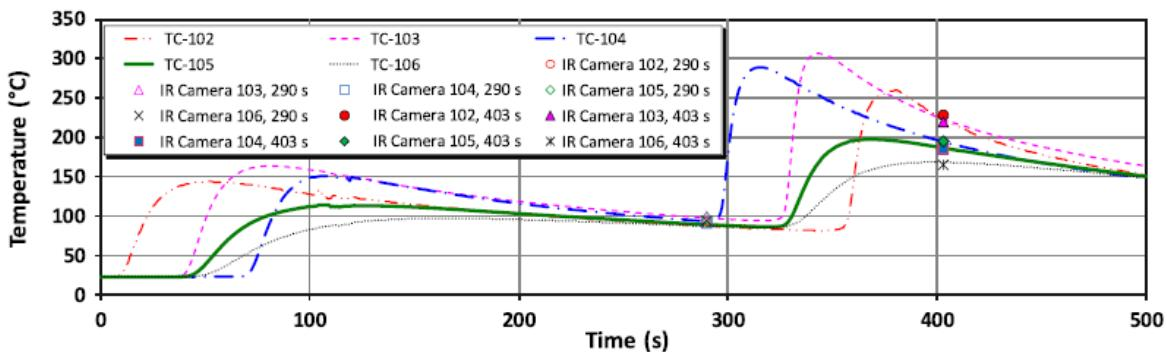
Slika 25. Temperaturna raspodjela radnog komada u programu Abaqus [8]
