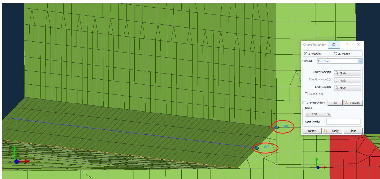
Slika 19. Definiranje trajektorija zavarivanja i referentne linije
