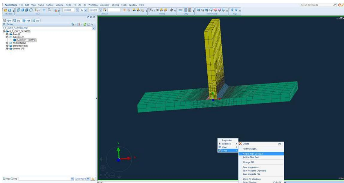
Slika 18. Izrada kolektora za lim osnovnog materijala [3]
