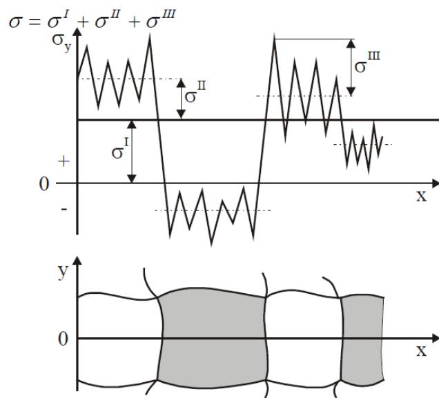
Slika 6. Shematski prikaz sumiranja zaostalih naprezanja [13]
