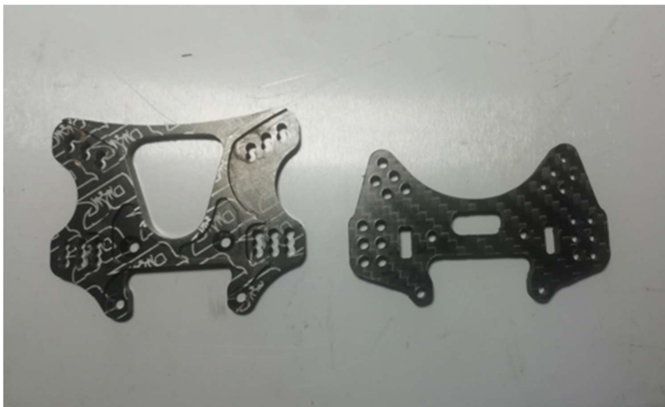
Slika 74. Usporedba buggy nosača amortizera (lijevo) i GT nosača amortizera (desno)
