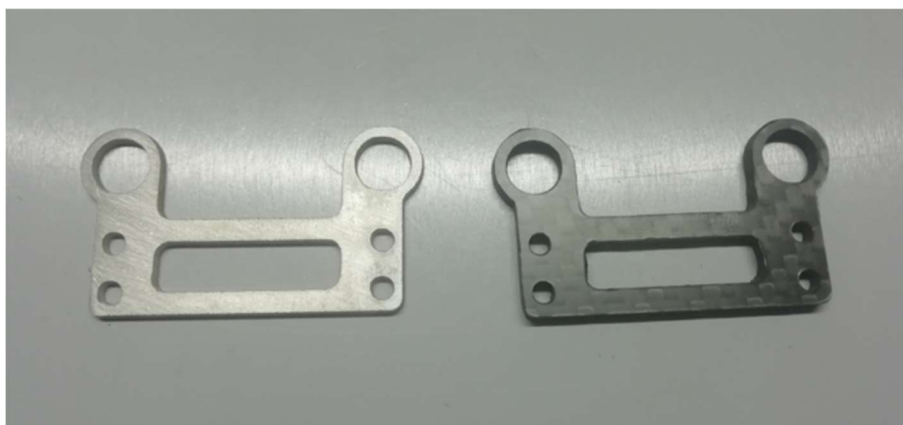
Slika 71. Izrađene postranične pločice za montiranje centrifugalne spojke, izrađene iz AlMg3 aluminijske legure i ugljičnih vlakana
