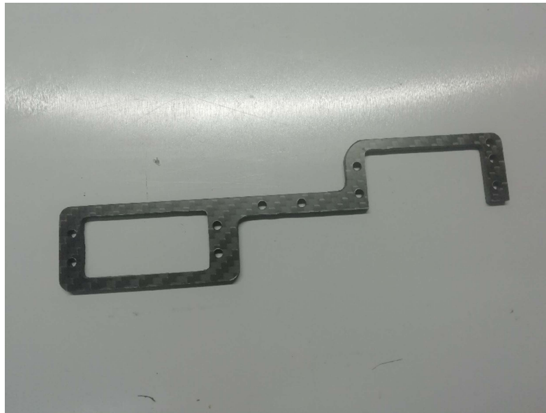
Slika 85. Servo ploča izrađena iz ugljičnih vlakana
