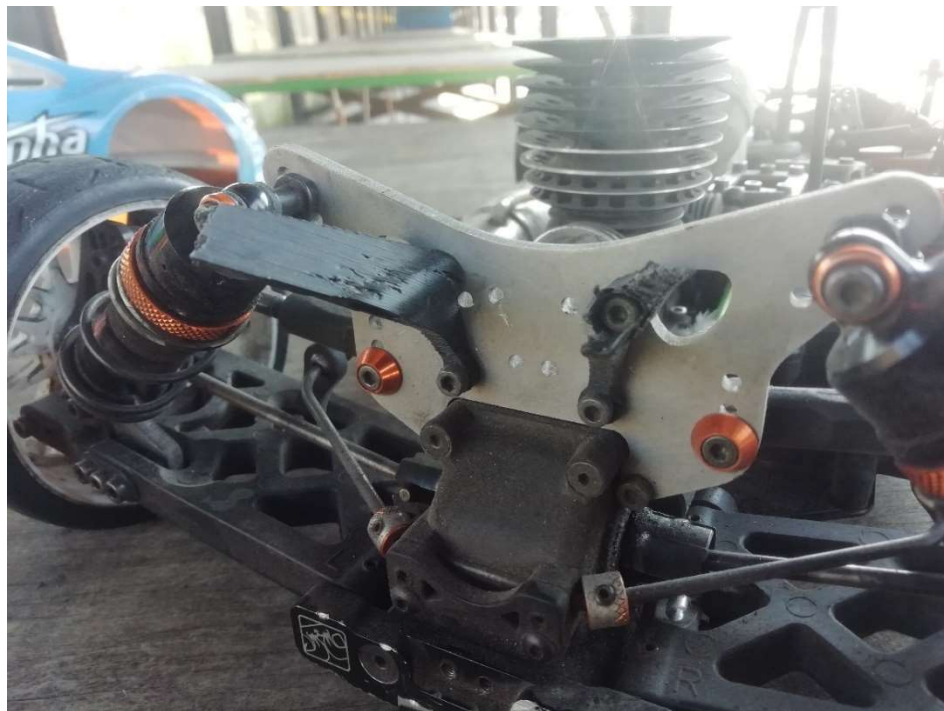
Slika 37. Bliži pogled na lom 3D printanog stražnjeg nosača karoserije
