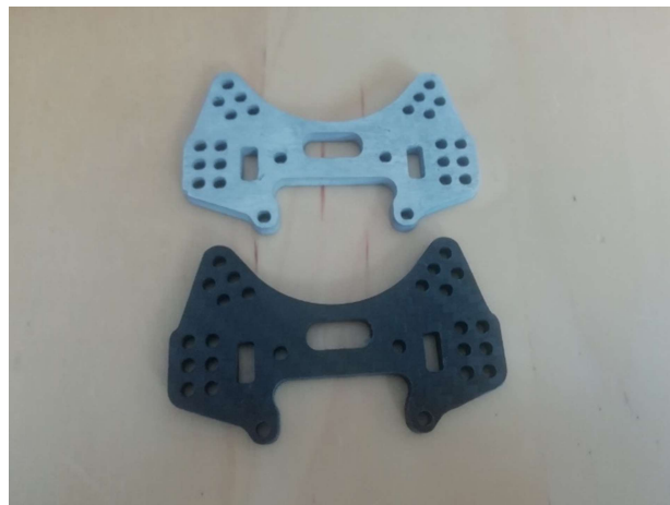
Slika 76. Prednji nosači amortizera, od AlMg3 aluminijske legure i ugljičnih vlakana
