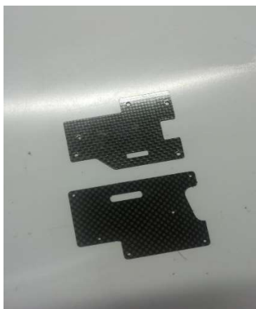
Slika 60. Izradene gornja i donja ukruta vilica od ugljičnih vlakana
