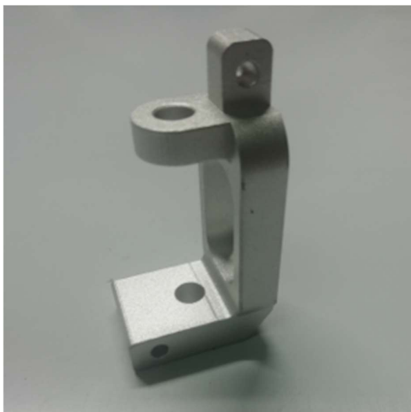
Slika 65. Izrađeni nosač glavčine sa smanjenim zatorum (0°)
