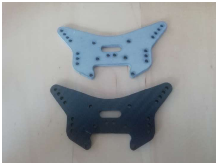
Slika 77. Stražnji nosači amortizera, od AlMg3 aluminijske legure i ugljičnih vlakana
