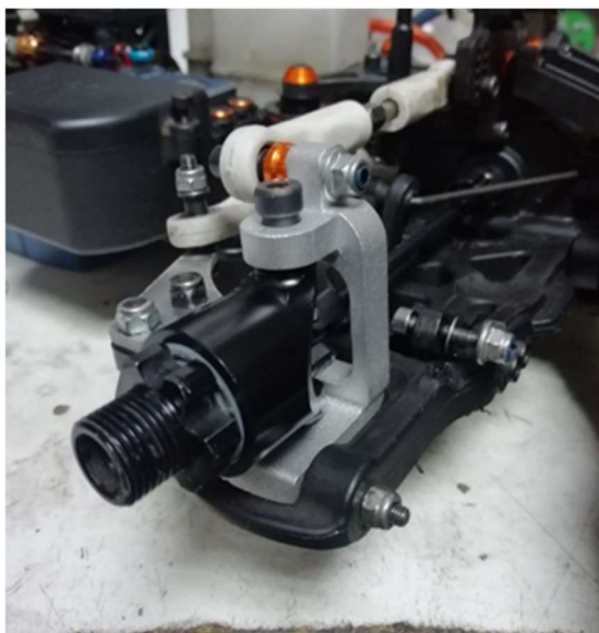
Slika 66. Instaliran novi 0° nosač glavčine na GT modelu
