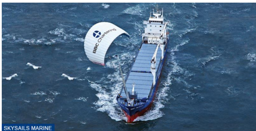
Slika 8. „SkySails“ propulzijski sustav za teretni brod [9]
