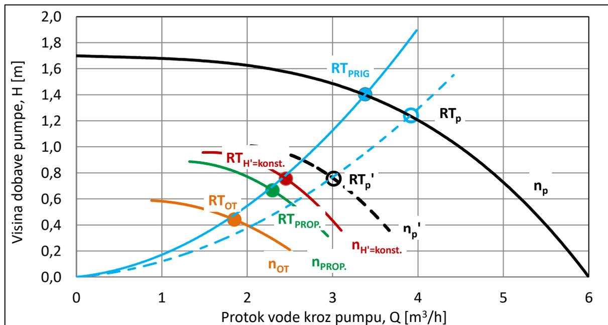
Slika 5.7. Usporedba radnih točki za istu otvorenost ventila
