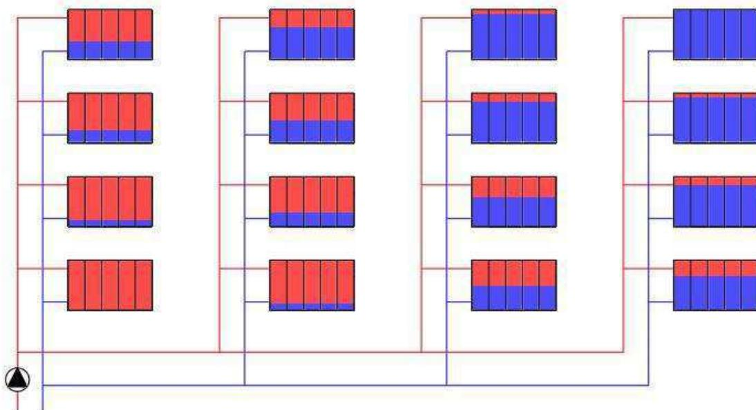
Slika 1.3. Nebalansirani sustav grijanja s vertikalama
