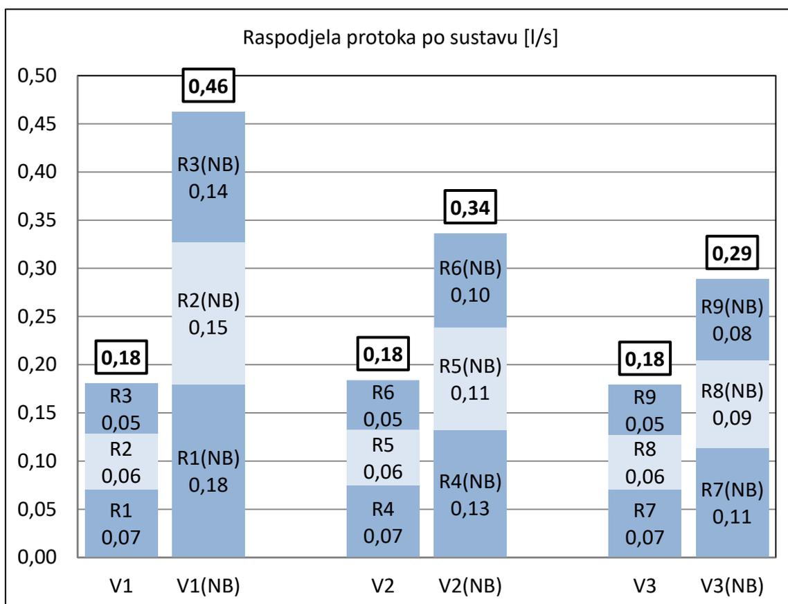
Slika 5.9. Usporedba projektnih protoka balansiranog i nebalansiranog sustava
