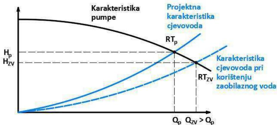
Slika 3.5. Promjena radne točke pri korištenju zaobilaznog voda
