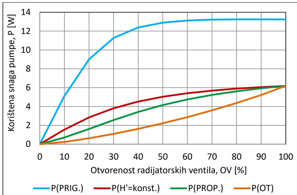
Slika 5.8. Snaga pumpe pri različitim otvorenostima ventila
