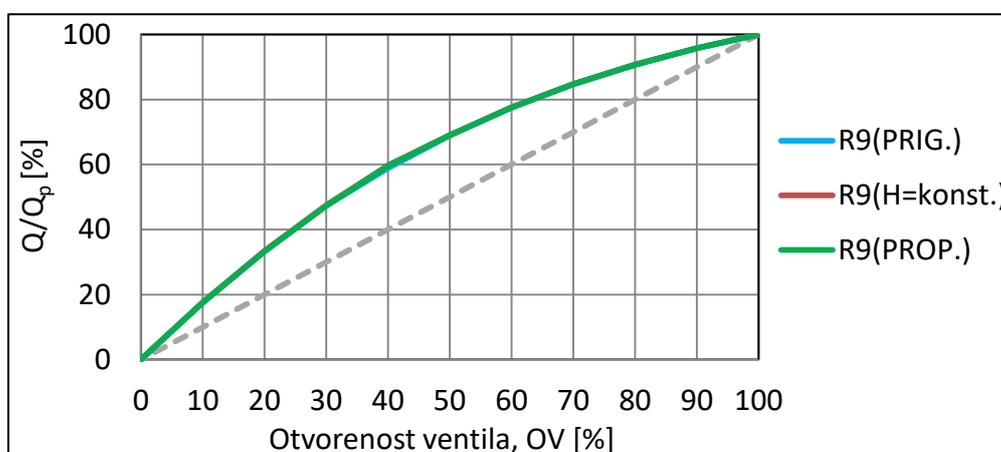
Slika 6.10. Karakteristika ventila radijatora R9 pri samostalnom zatvaranju
