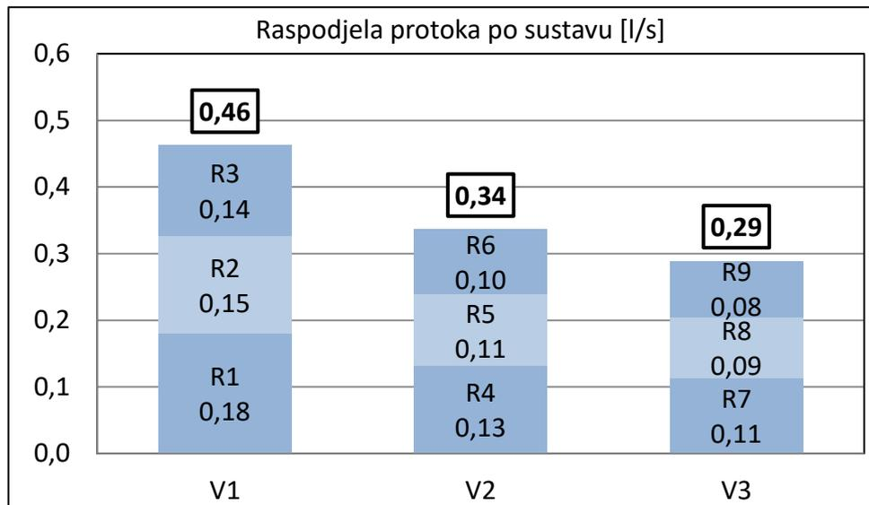
Slika 5.1. Raspodjela protoka u nebalansiranom sustavu
