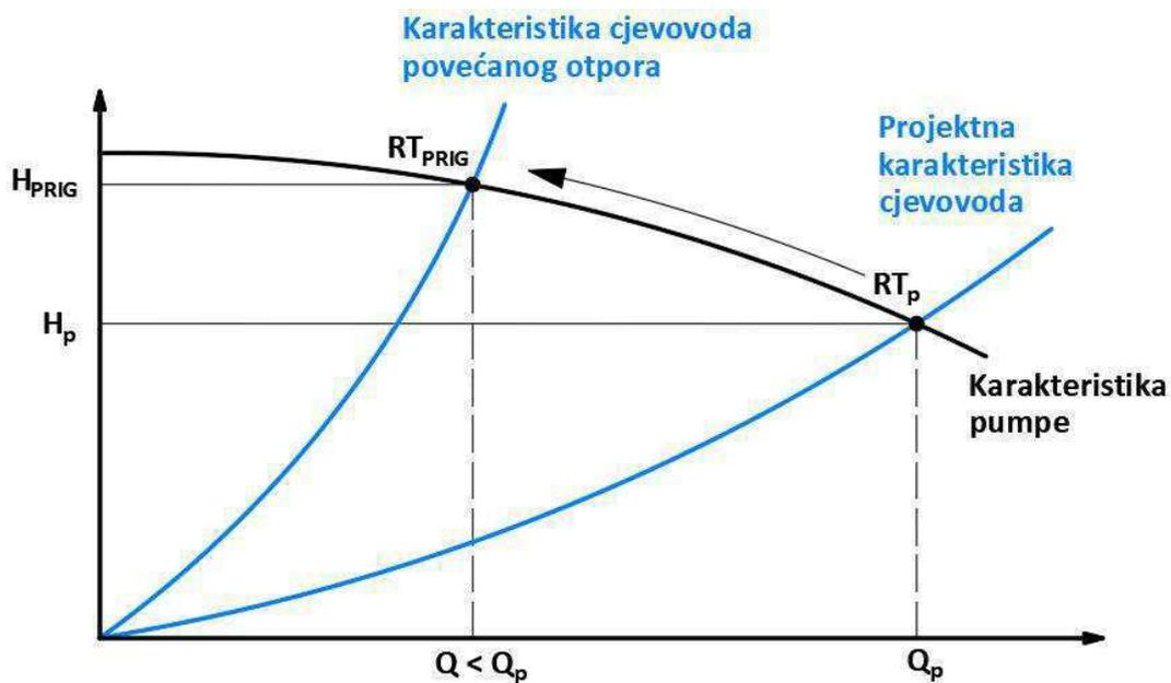
Slika 3.3. Promjena radne točke kod regulacije prigušenjem
