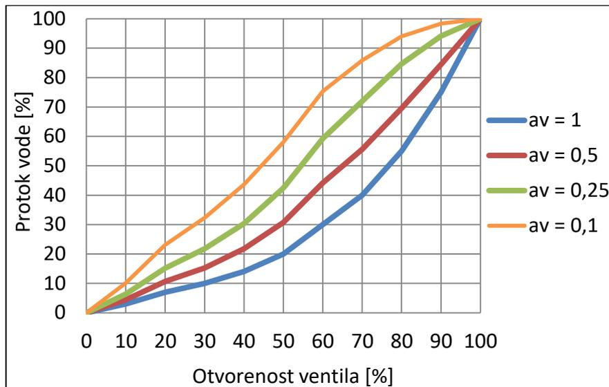
Slika 2.7. Deformacija jednakopostotne karakteristike ventila pri smanjenom autoritetu
