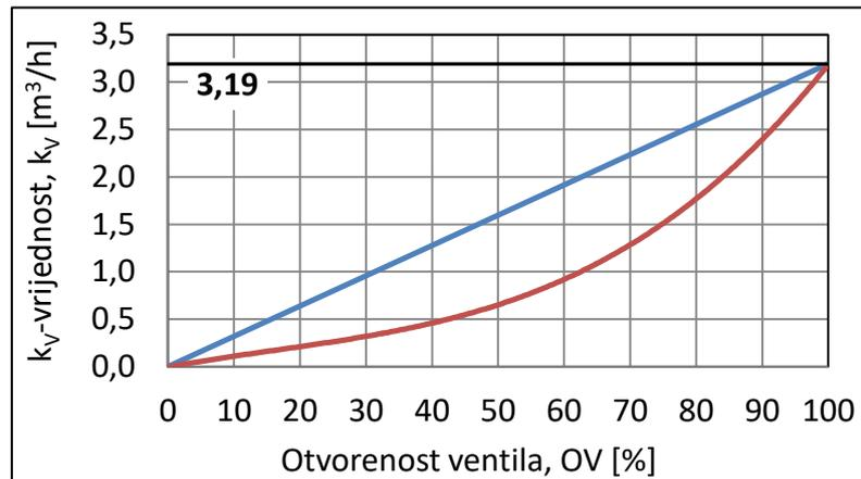
Slika 5.6. Ovisnost  $k_V$ -vrijednosti o otvorenosti ventila
