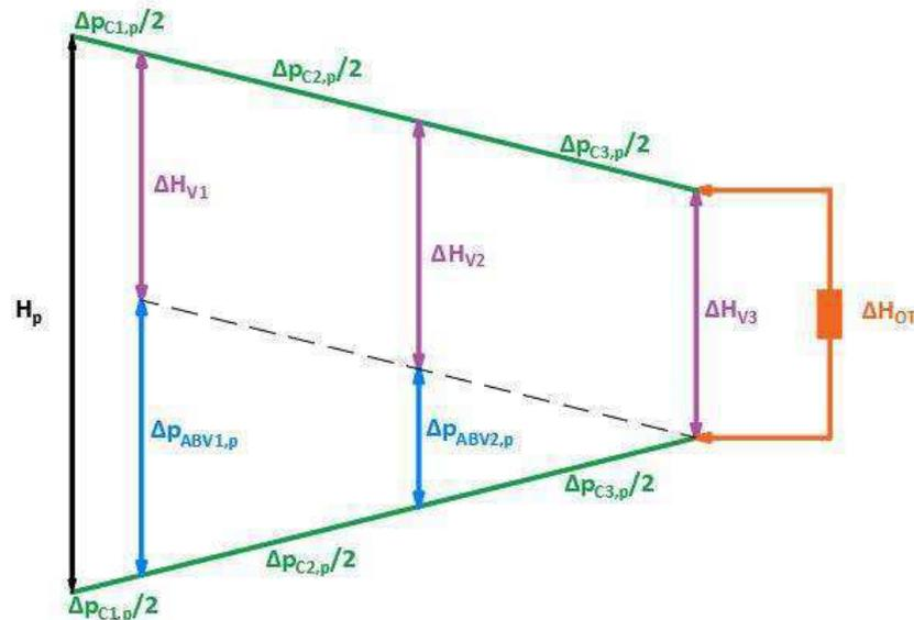
Slika 3.13. Komponente pada tlaka pri projektom opterećenju
