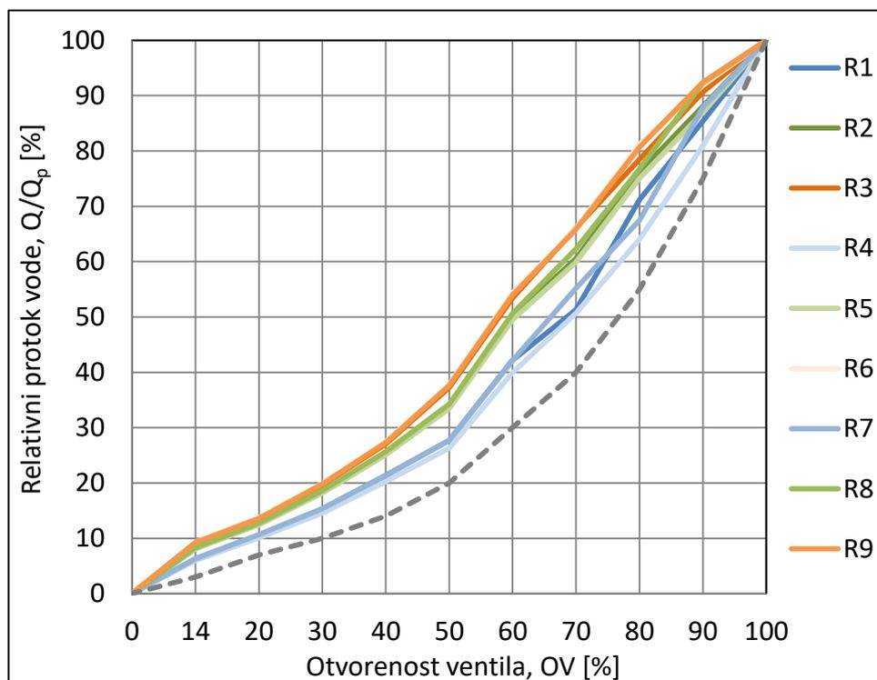
Slika 6.20. Pogonske karakteristike za slučaj ventila jednakopostotne karakteristike
