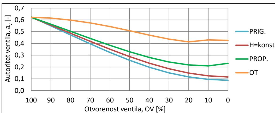
Slika 6.3. Usporedba promjene autoriteta ventila radijatora R5
