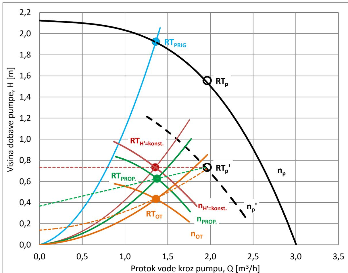
Slika 5.13. Usporedba radnih točki za istu otvorenost ventila
