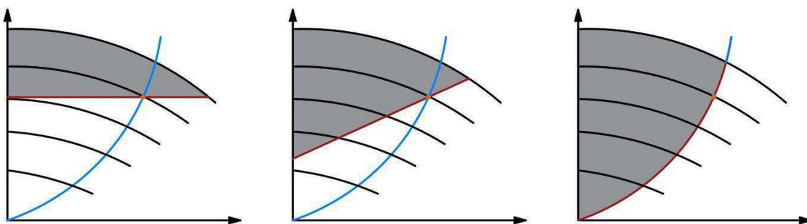
Slika 3.10. Usporedba potencijalnih ušteda kod konstantne visine dobave, proporcionalnog upravljanja i "idealnog" upravljanja u odnosu na regulaciju prigušenjem
