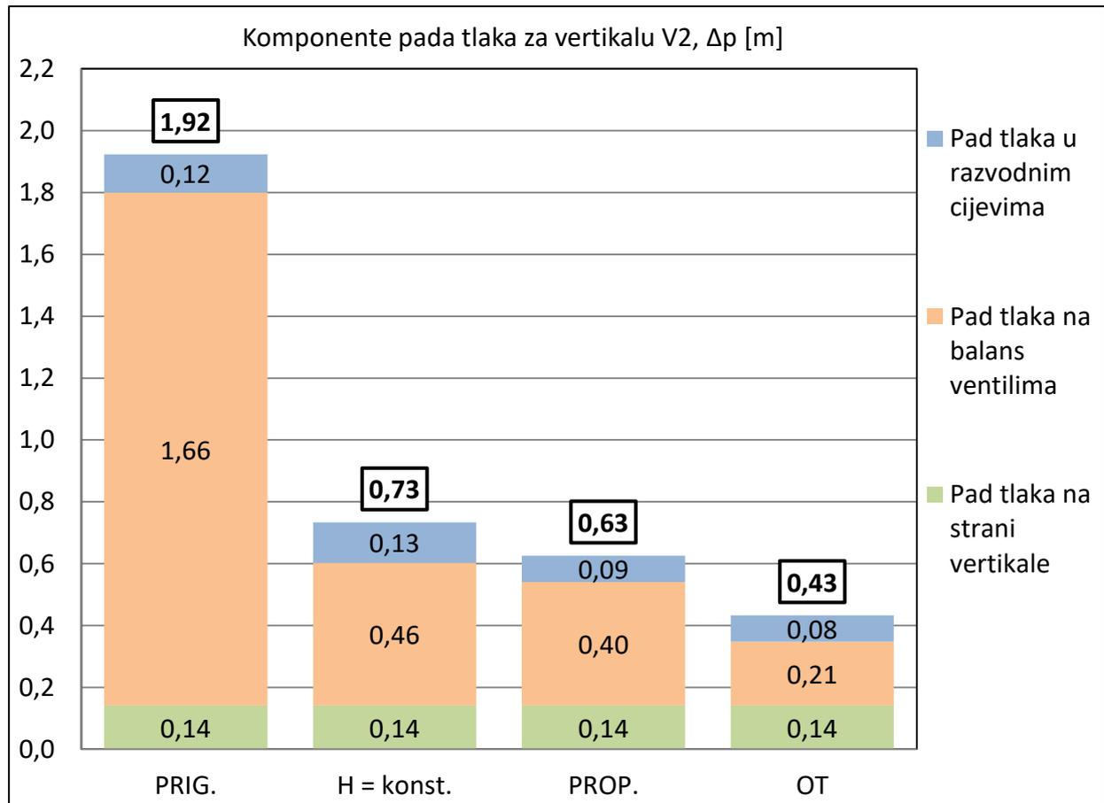
Slika 5.14. Usporedba pada tlaka na balans ventilima
