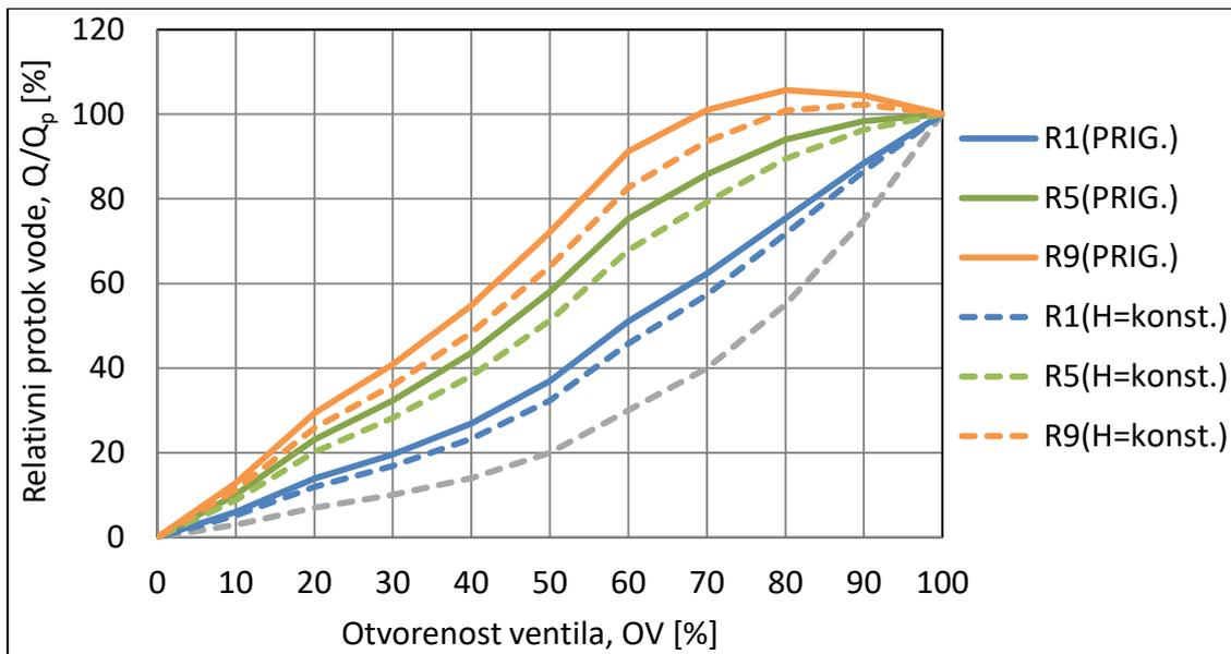
Slika 6.12. Jednakopostotne karakteristike ventila pri prigušenju i konstantnoj visini dobave
