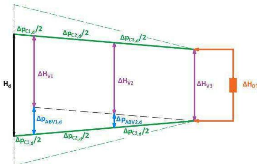
Slika 3.14. Komponente pada tlaka pri djelomičnom opterećenju
