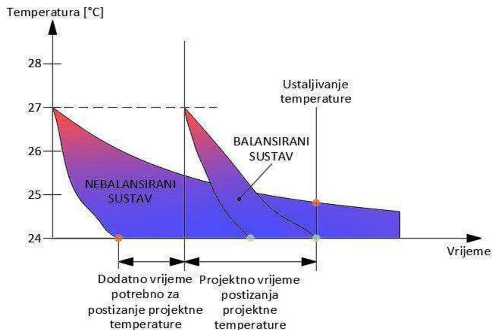
Slika 1.4. Proces hlađenja nakon prekida rada sustava
