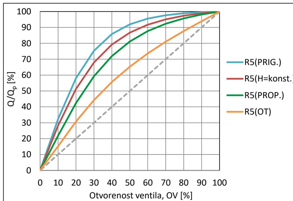
Slika 6.11. Usporedba karakteristike istog ventila za sve metode upravljanja pumpom
