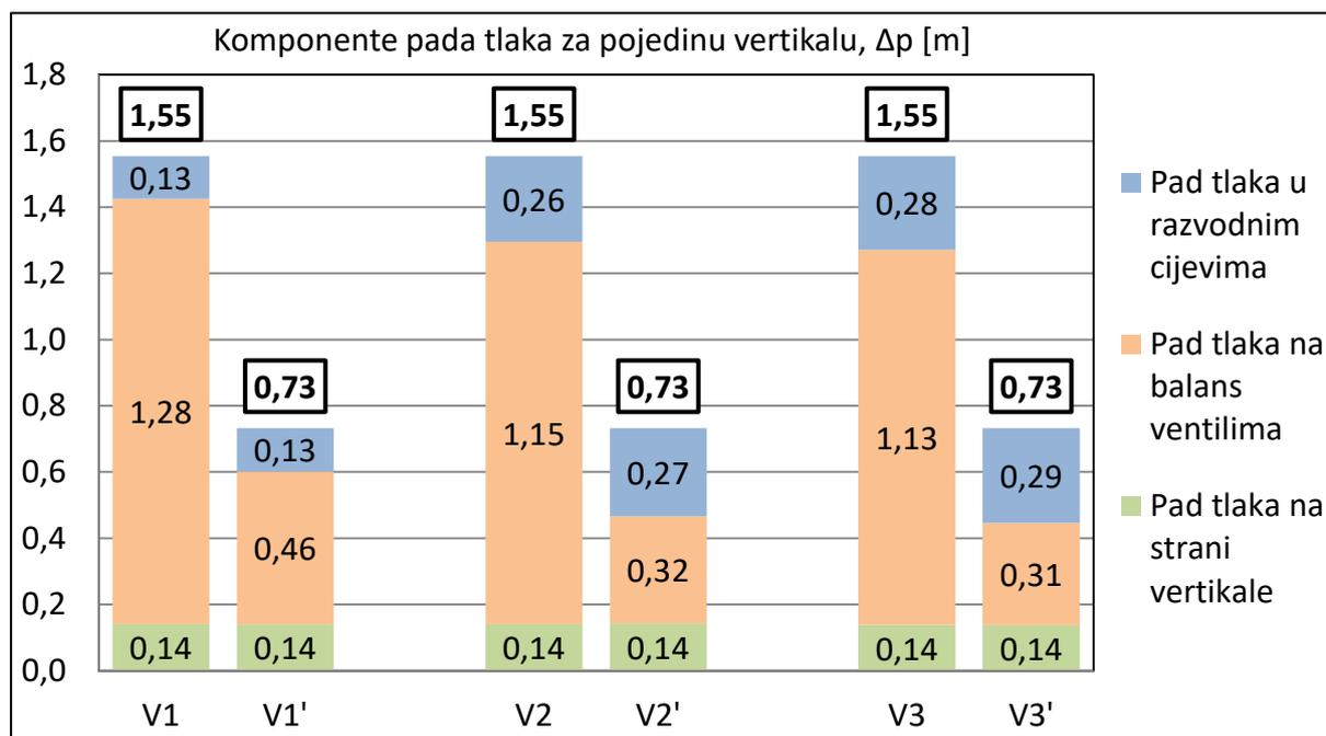
Slika 5.12. Usporedba pada tlaka na balans ventilima
