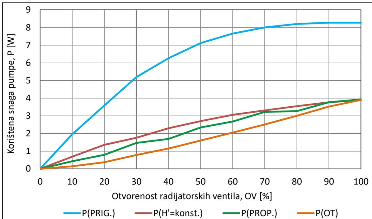
Slika 5.15. Snaga pumpe pri različitim otvorenostima ventila
