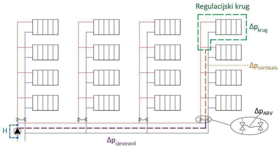
Slika 2.9. Balansirani sustav grijanja s relevantnim padovima tlaka
