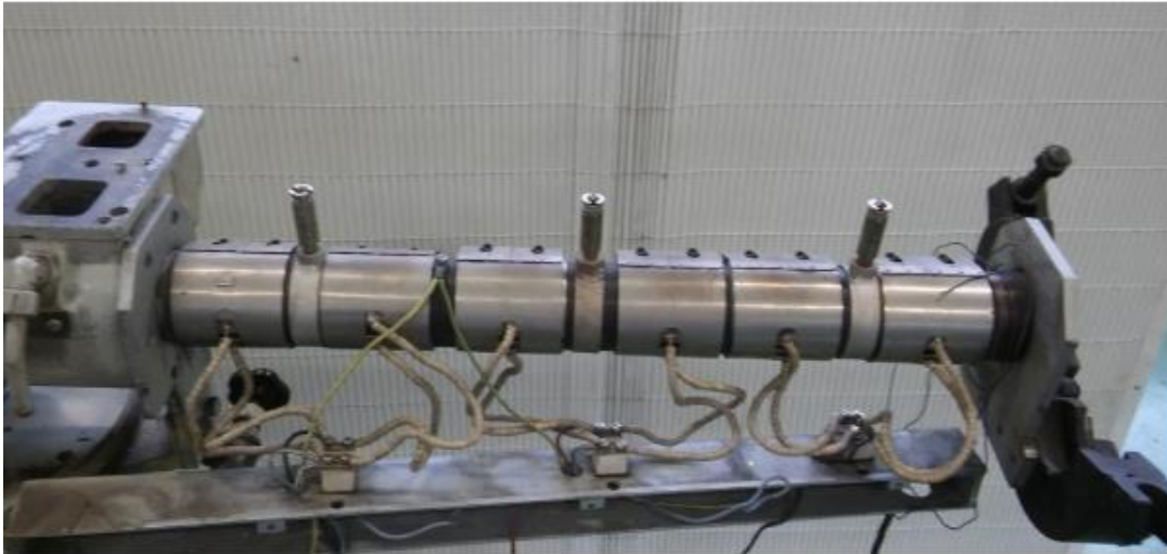
Slika 15. Unutarnji grijači podijeljeni u tri toplinske zone [1]
