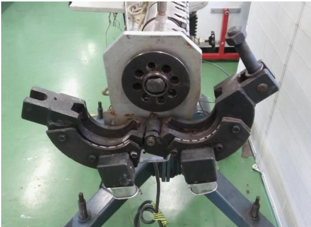
Slika 16. Prikaz vanjskog grijača [1]
