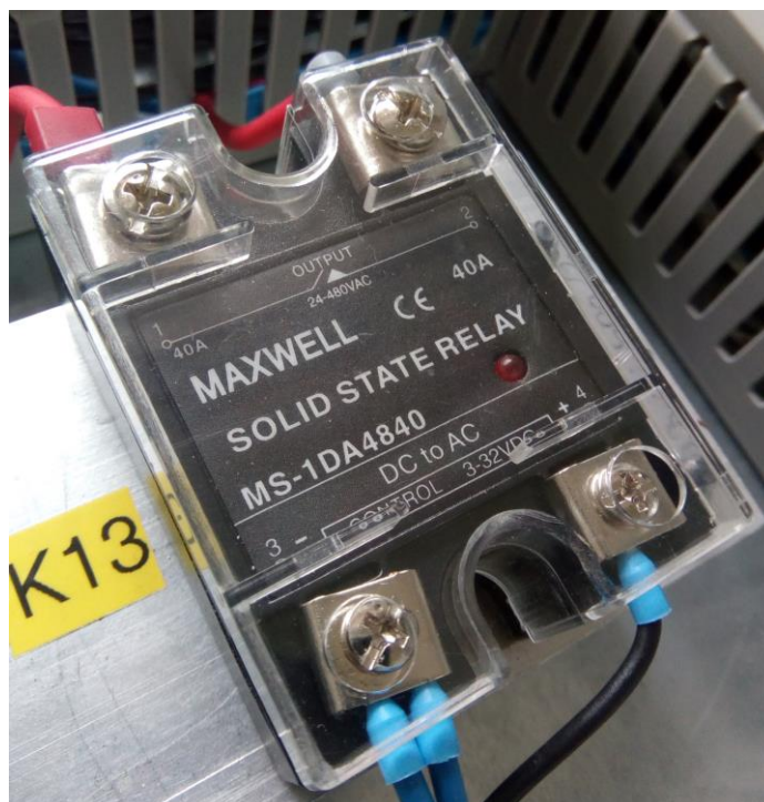
Slika 24. Poluvodički relej Maxwell SSR MS-1DA4840
